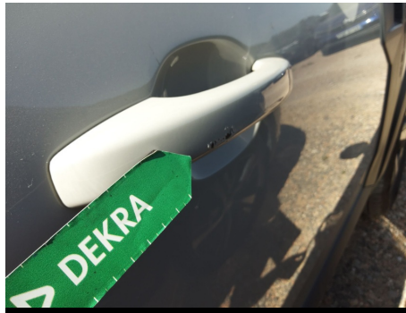
Manetas de puerta / Delantero Derecho / Ralladura
