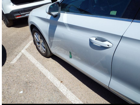
Puerta / Delantero Izquierdo / Abolladura
