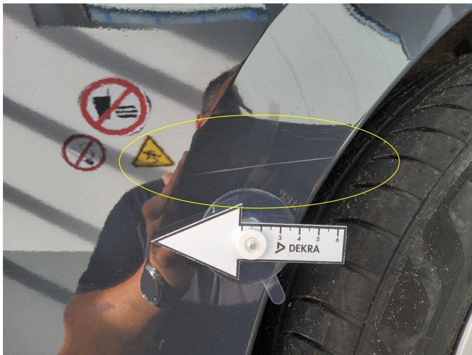
Bild 16 : Stoßfänger hinten rechts verschrammt.
