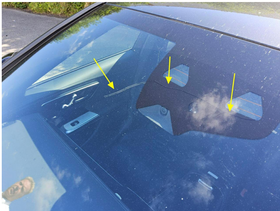
Bild 8 : Windschutzscheibe gerissen, erneuern
