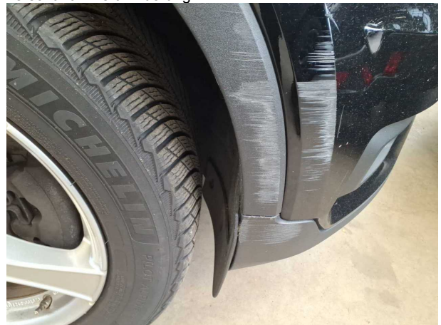
Beschädigung #4: Kotflügel rechts: Radhausverbreiterung - verkratzt / verschürft - erneuern
