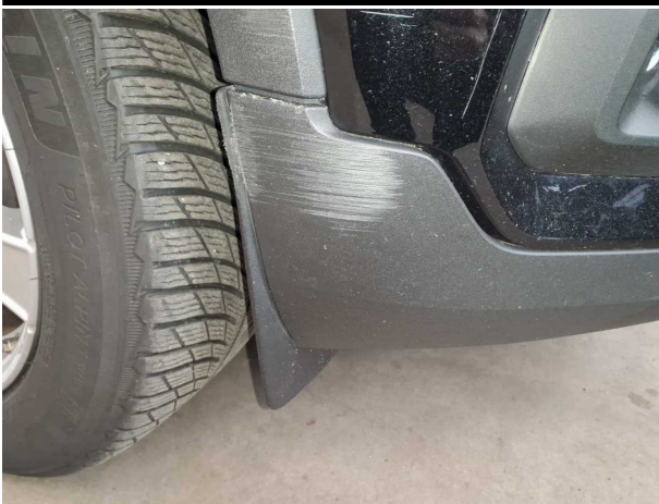
Beschädigung #5: Stossfänger vorn: Spoiler - Abrieb - erneuern
