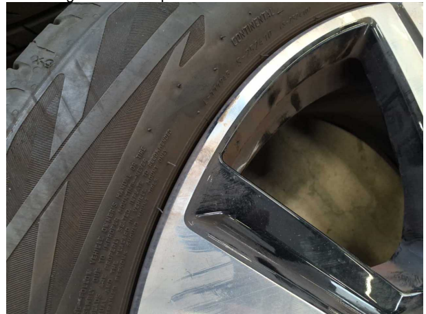
Beschädigung #3: 2.Radsatz: 1 Leichtmetallfelge - verkratzt / verschürft - Wertminderung
