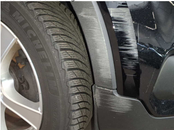
Beschädigung #4: Kotflügel rechts: Radhausverbreiterung - verkratzt / verschürft - erneuern
