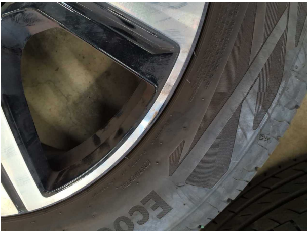
Beschädigung #3: 2.Radsatz: 1 Leichtmetallfelge - verkratzt / verschürft - Wertminderung
