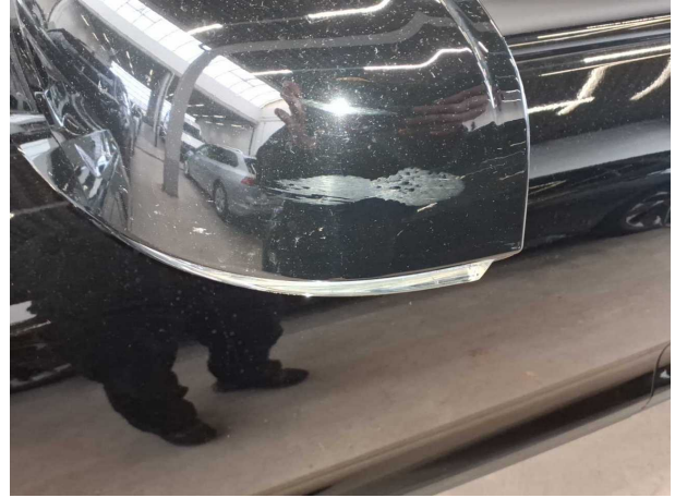
Beschädigung #2: Außenspiegel links: Spiegelgehäuse - Lackmangel - Smart Repair
