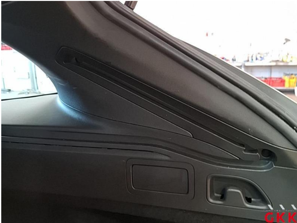
Bild 38. D- Säule rechts, Innenverkleidung, beschädigt, ersetzen
