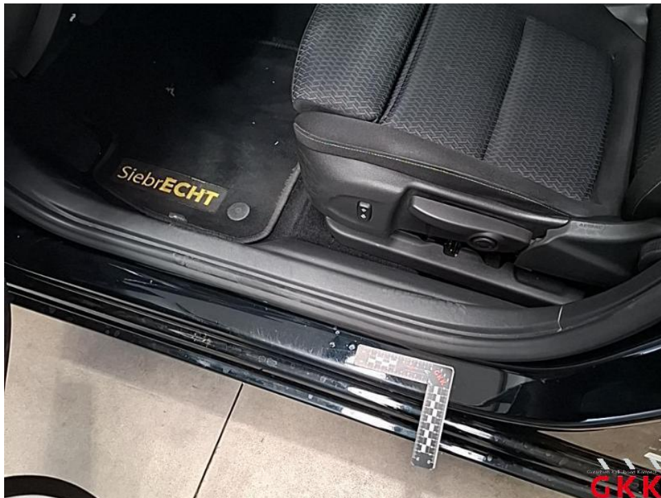
Bild 19. Tür vorne links, Einstieg, verkratzt, lackieren
