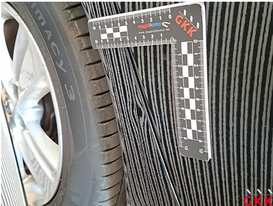
Bild 42. Seitenwand rechts, bis 3 Dellen / Bauteil, Smartrepair
