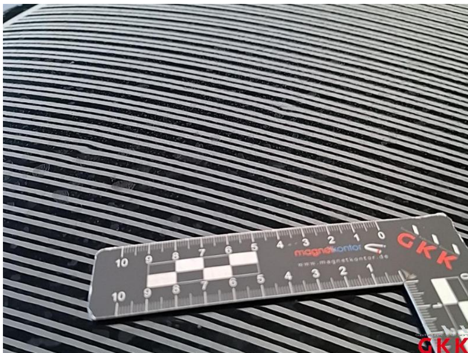
Bild 26. Dach, 4 bis 10 Dellen / Bauteil, kalt drücken
