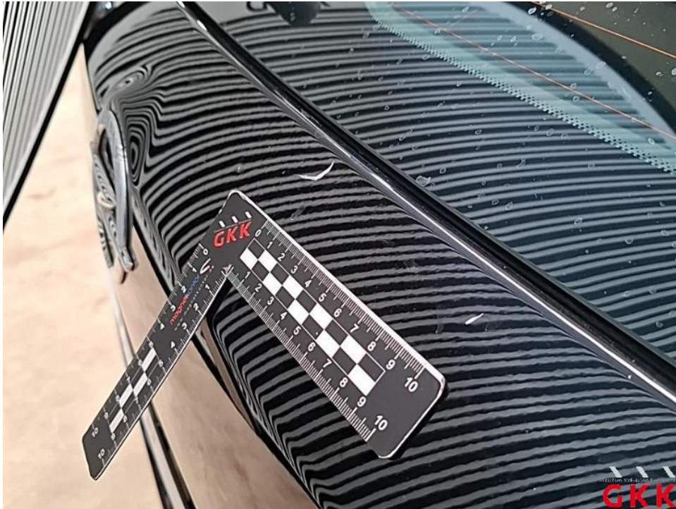
Bild 33. Heckklappe, beschädigt, lackieren
