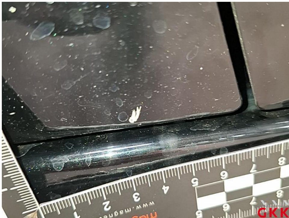
Bild 52. Tür vorne links, verkratzt, lackieren
