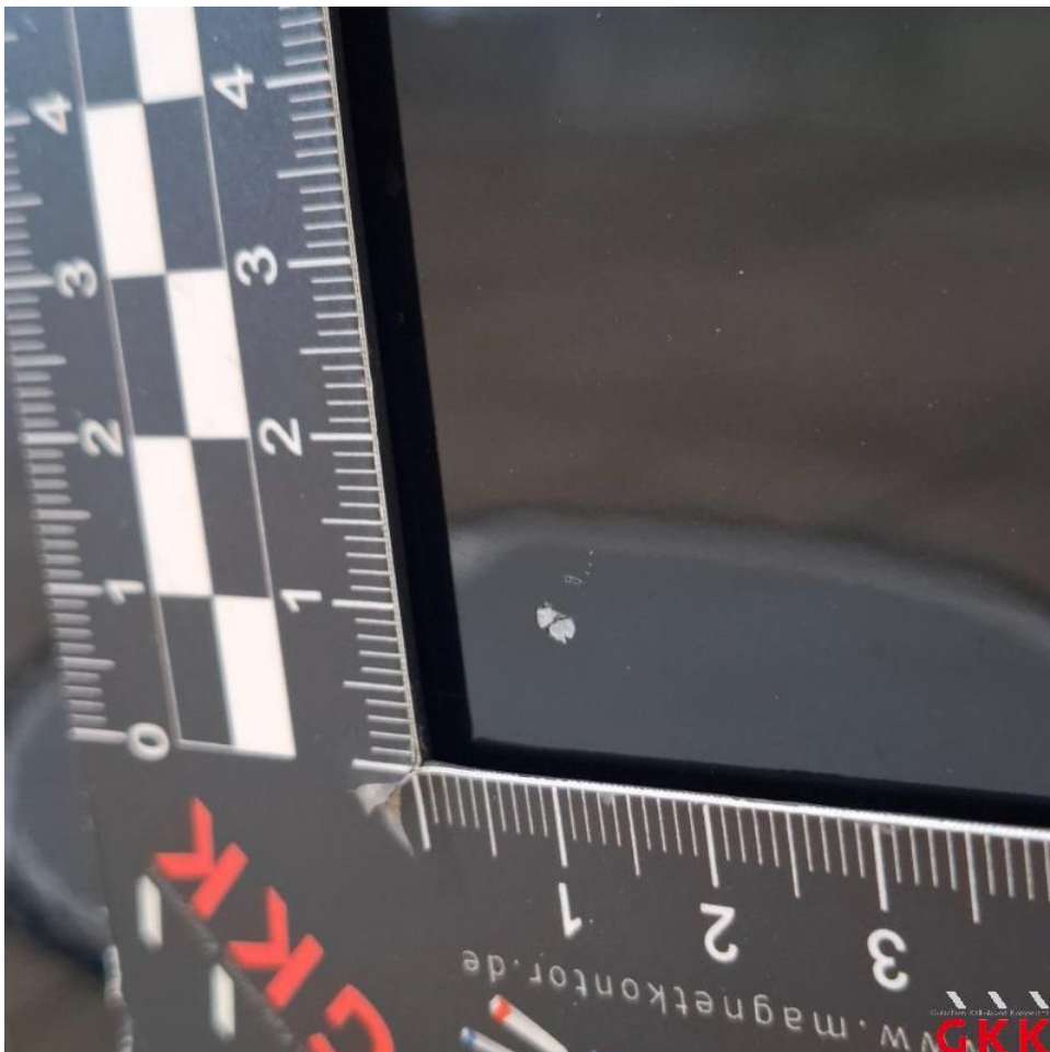
Bild 24. Tür hinten links, bis 3 Dellen / Bauteil, instand setzen - lackieren
