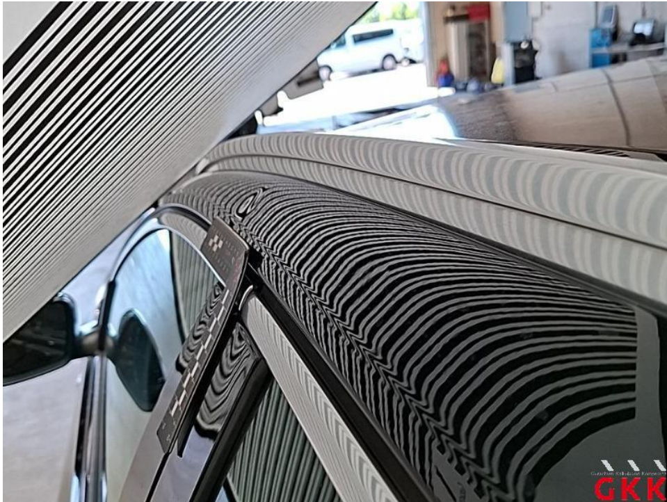
Bild 29. Dach, Holm links, beschädigt, instand setzen - lackieren
