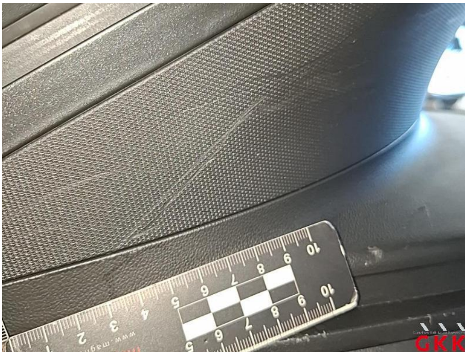
Bild 36. D- Säule links, Innenverkleidung, beschädigt, ersetzen
