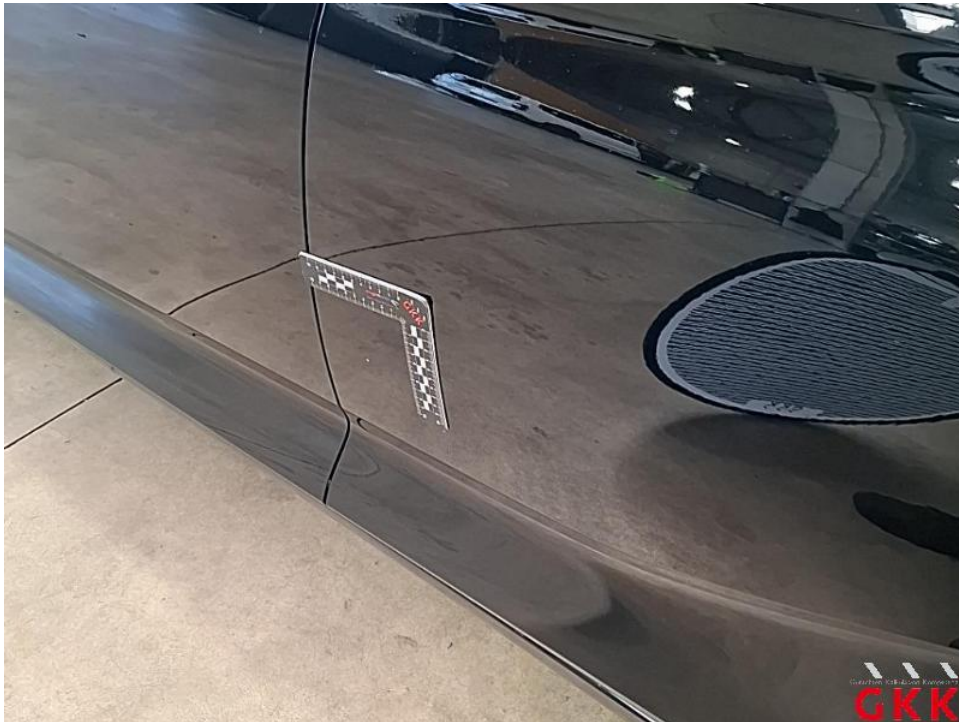
Bild 22. Tür hinten links, bis 3 Dellen / Bauteil, instand setzen - lackieren
