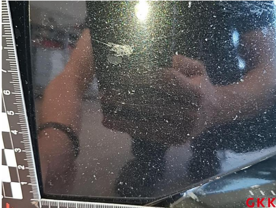
Bild 17. Stoßfänger vorne, Verkleidung -lackiert-, Steinschlag und Kratzer, lackieren
