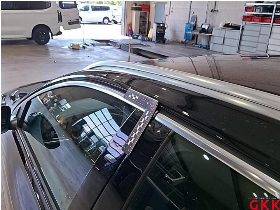
Bild 28. Dach, Holm links, beschädigt, instand setzen - lackieren
