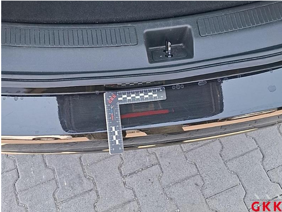
Bild 53. Stoßfänger hinten, Verkleidung -lackiert-, verkratzt, Smartrepair
