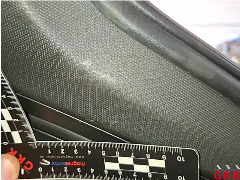
Bild 39. D- Säule rechts, Innenverkleidung, beschädigt, ersetzen
