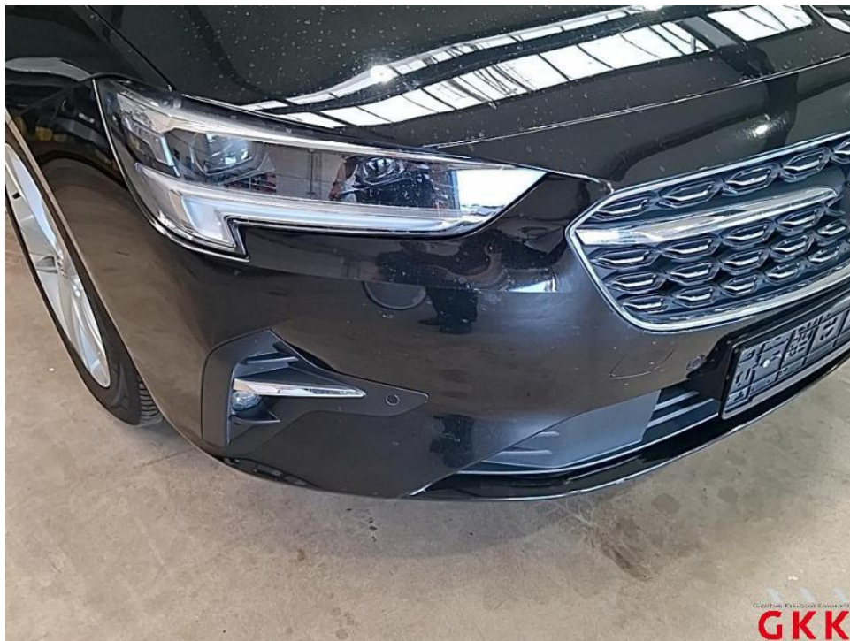
Bild 16. Stoßfänger vorne, Verkleidung -lackiert-, Steinschlag und Kratzer, lackieren
