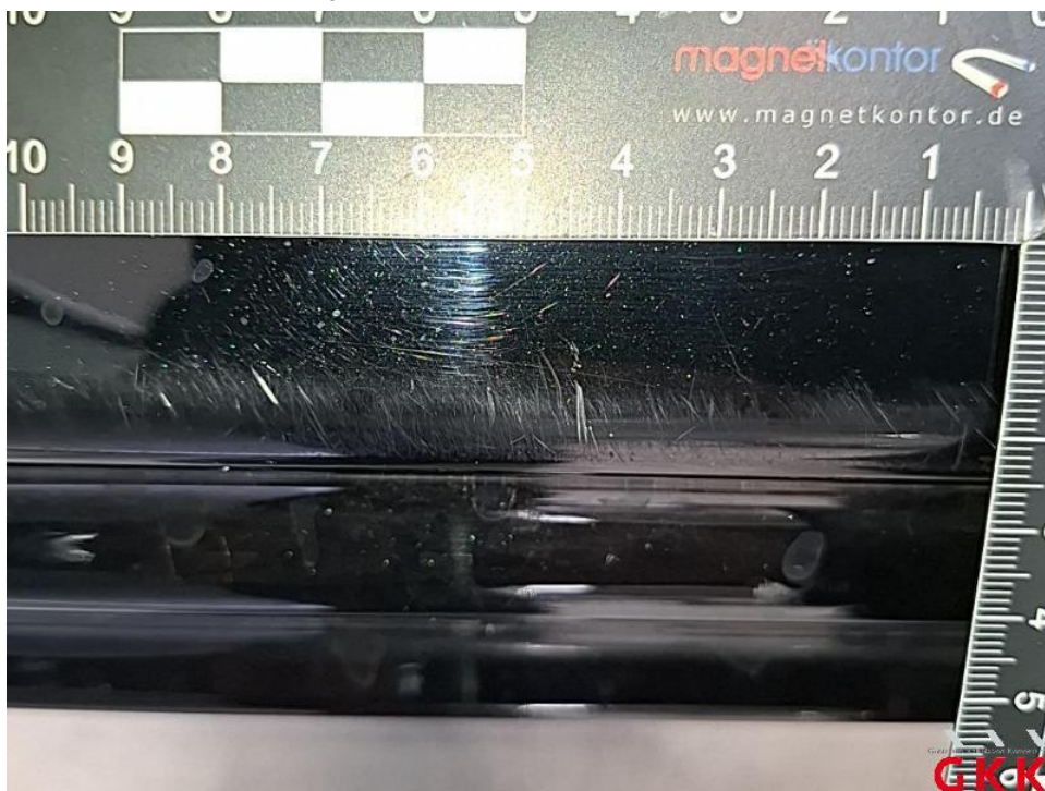
Bild 20. Tür vorne links, Einstieg, verkratzt, lackieren
