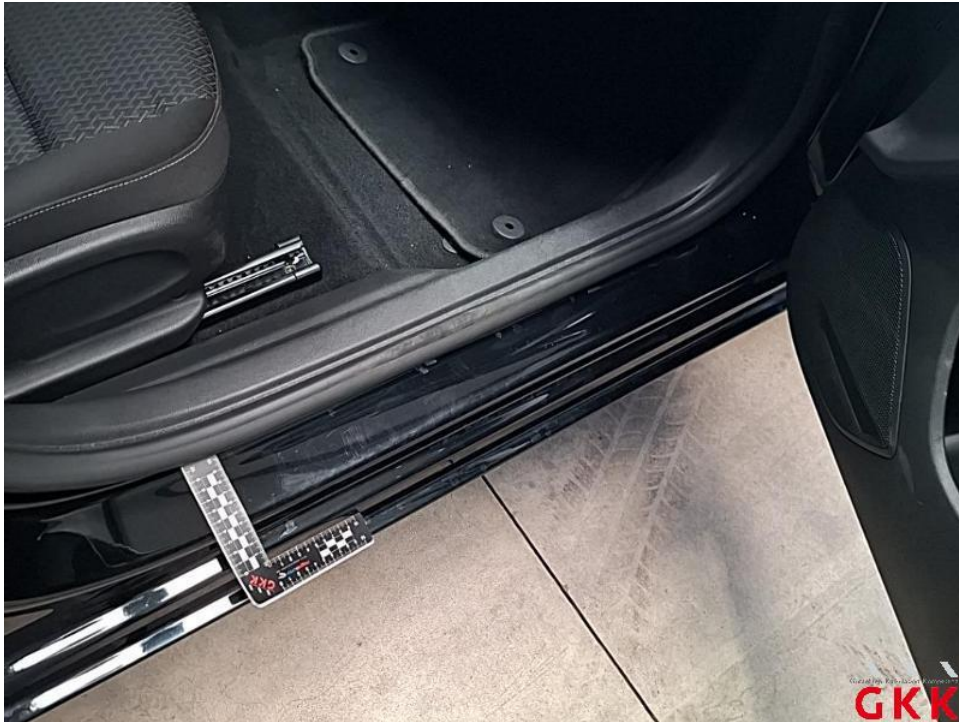
Bild 47. Tür vorne rechts, Einstieg, verkratzt, Smartrepair
