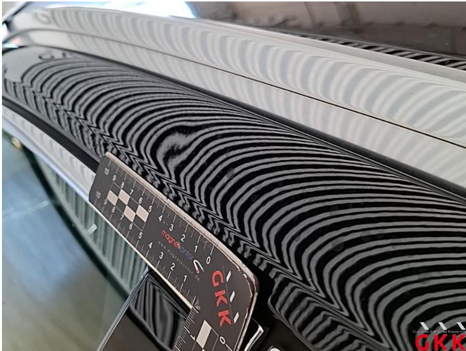
Bild 30. Dach, Holm links, beschädigt, instand setzen - lackieren
