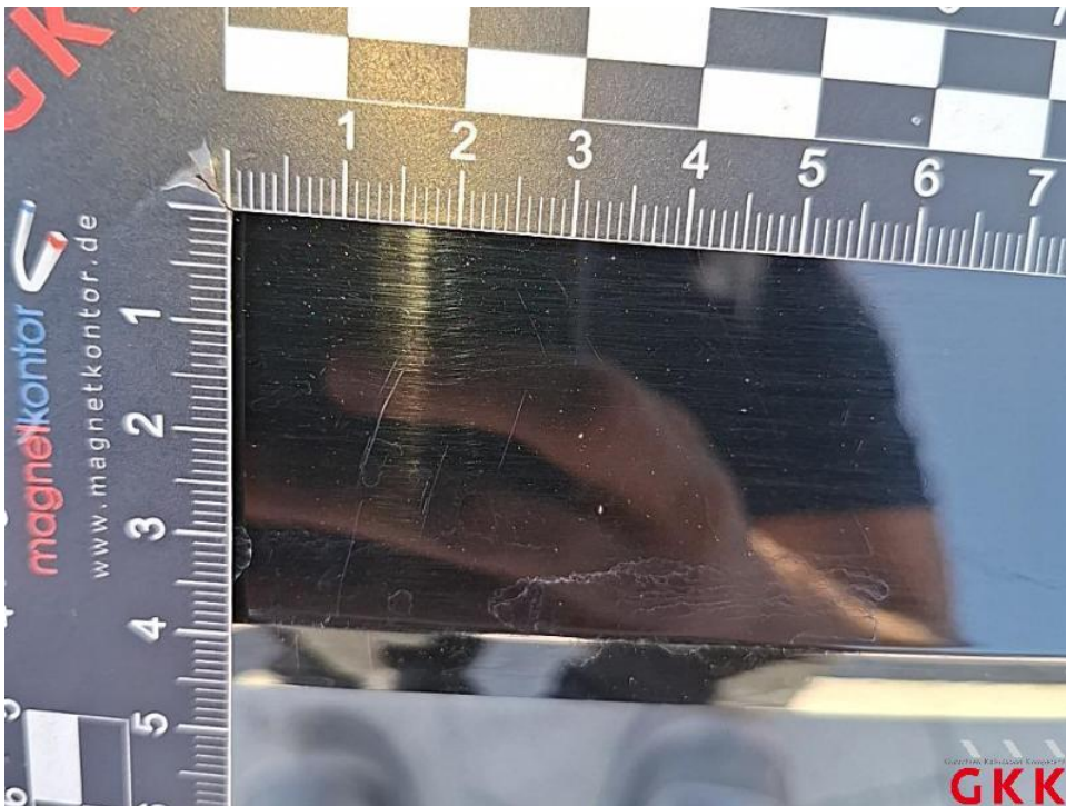
Bild 54. Stoßfänger hinten, Verkleidung -lackiert-, verkratzt, Smartrepair
