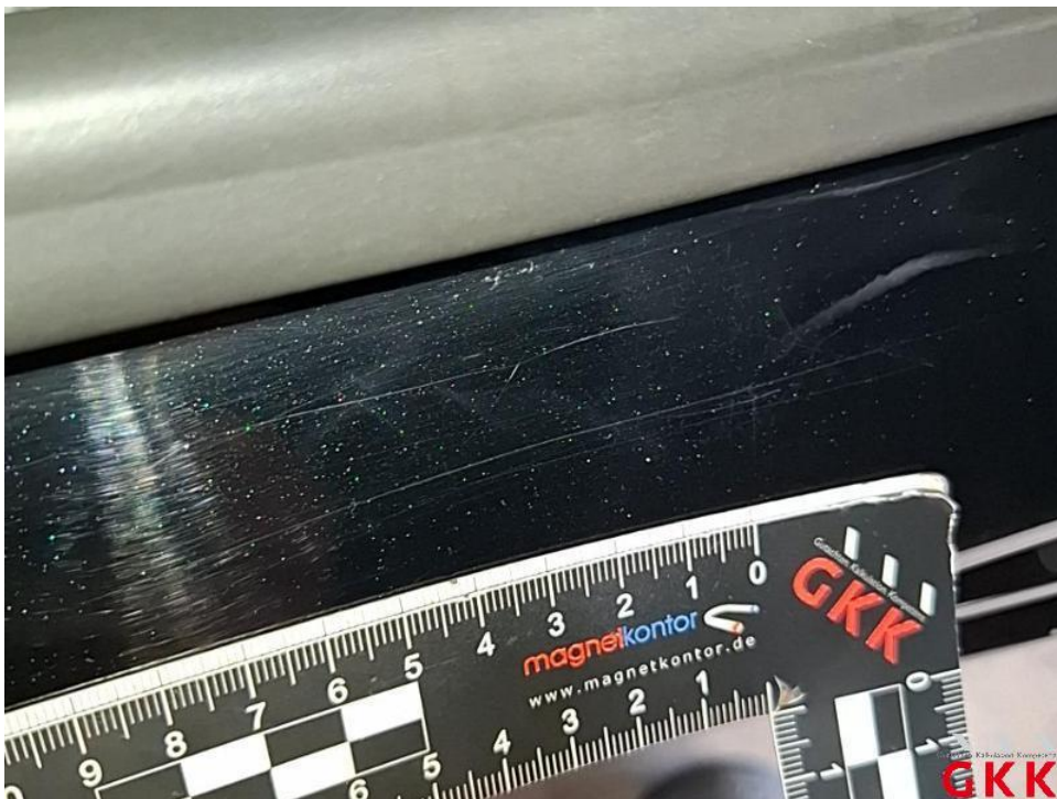
Bild 46. Tür hinten rechts, Einstieg, beschädigt, Smartrepair
