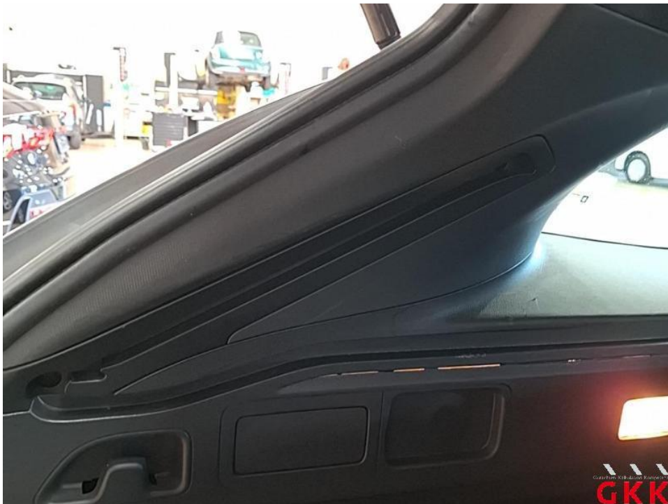
Bild 35. D- Säule links, Innenverkleidung, beschädigt, ersetzen
