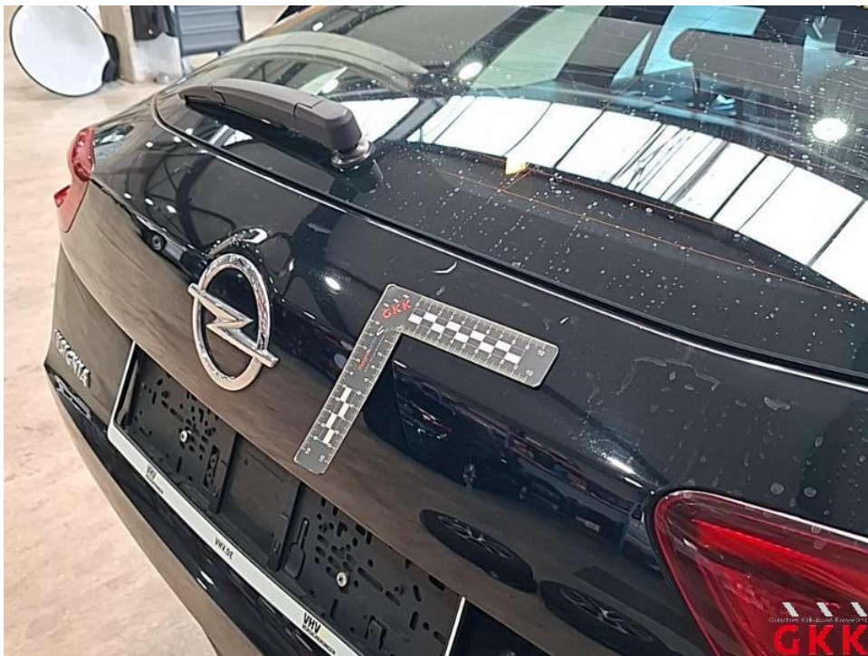
Bild 32. Heckklappe, beschädigt, lackieren
