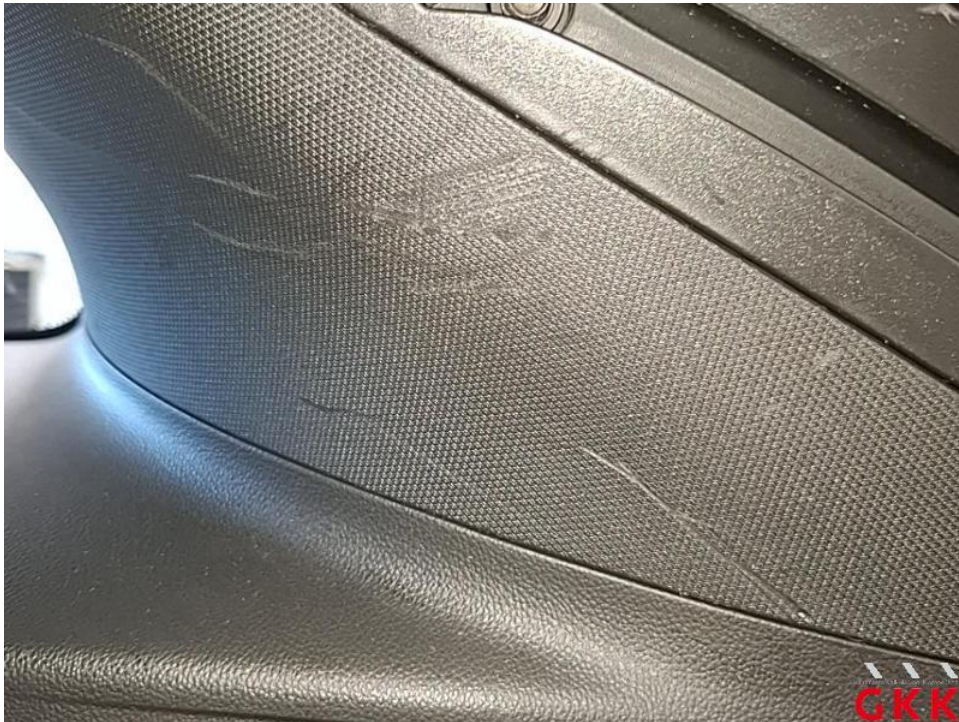
Bild 40. D- Säule rechts, Innenverkleidung, beschädigt, ersetzen
