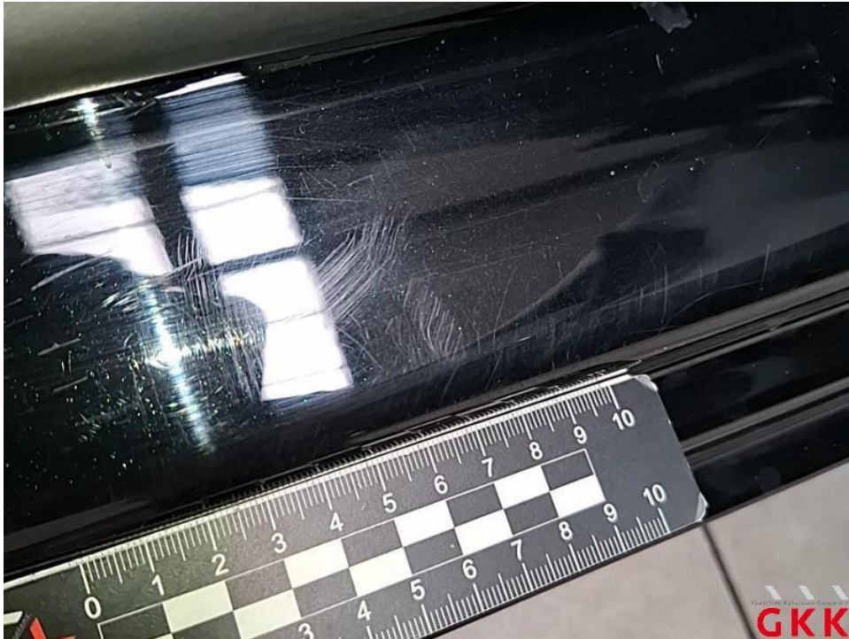
Bild 49. Tür vorne rechts, Einstieg, verkratzt, Smartrepair
