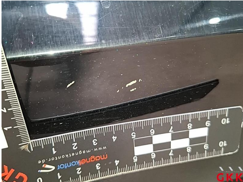
Bild 51. Tür vorne links, verkratzt, lackieren
