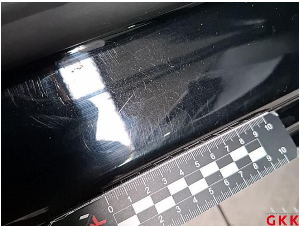
Bild 48. Tür vorne rechts, Einstieg, verkratzt, Smartrepair
