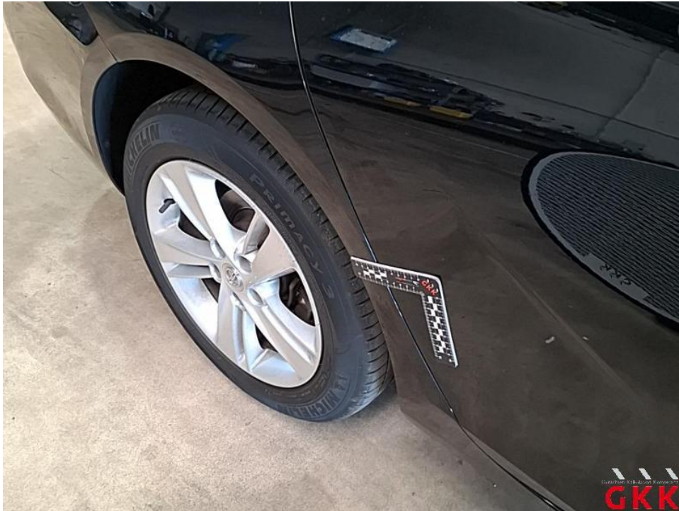
Bild 41. Seitenwand rechts, bis 3 Dellen / Bauteil, Smartrepair
