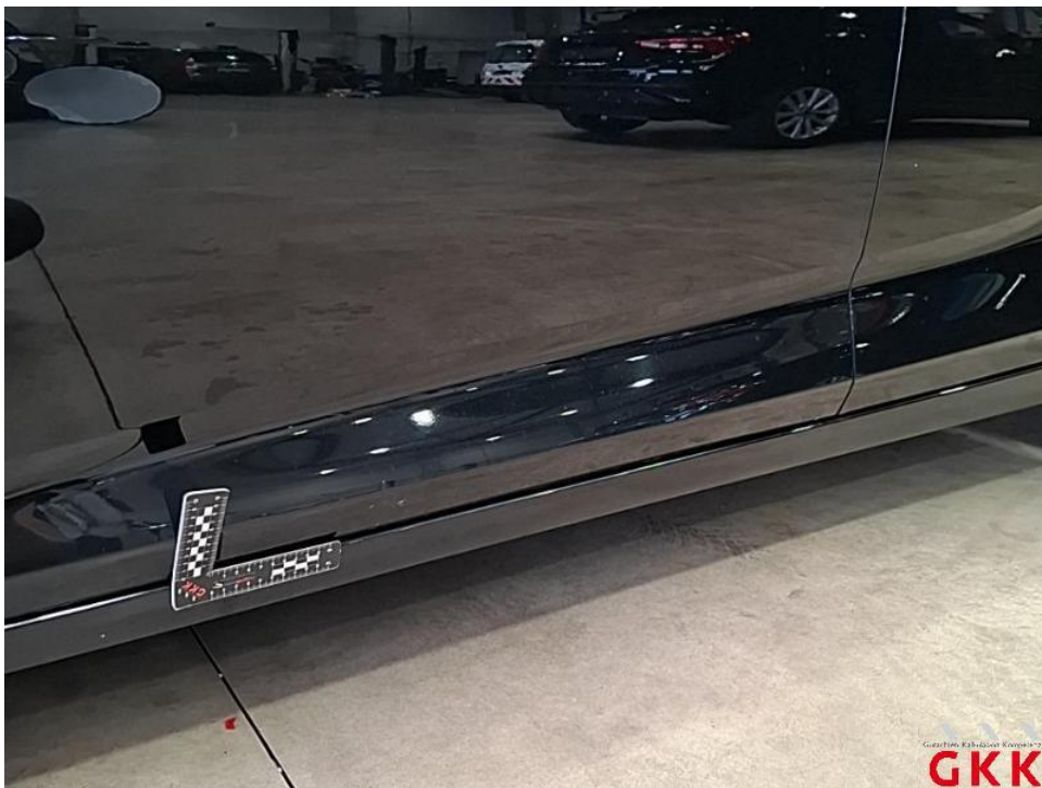
Bild 50. Tür vorne links, verkratzt, lackieren
