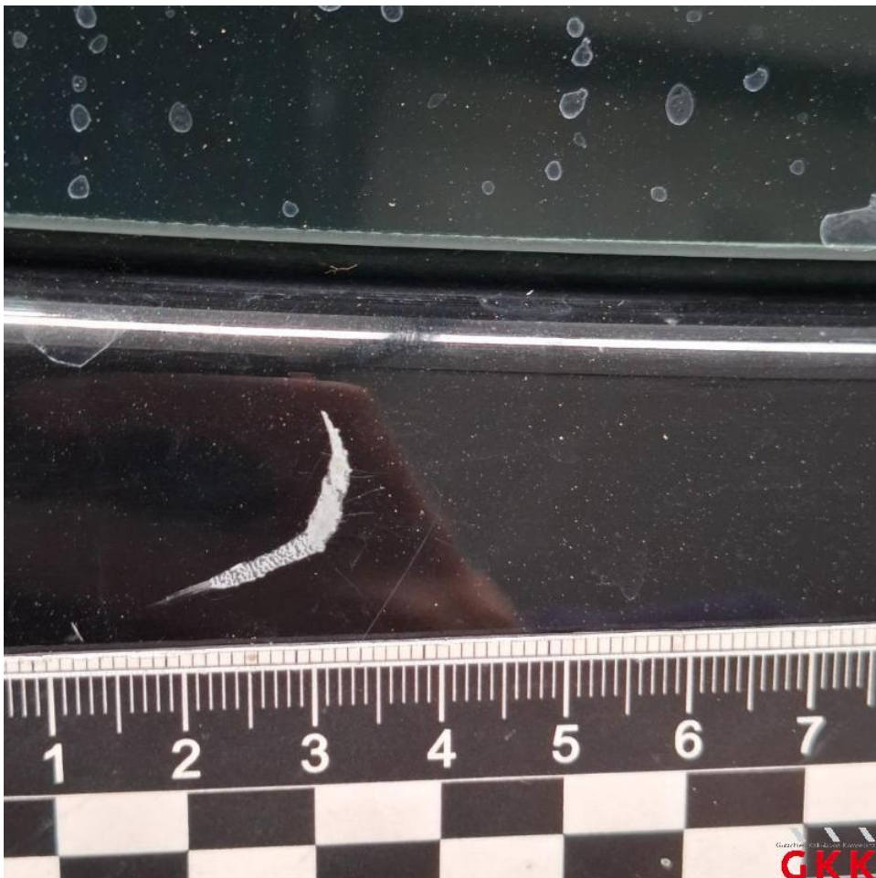
Bild 34. Heckklappe, beschädigt, lackieren
