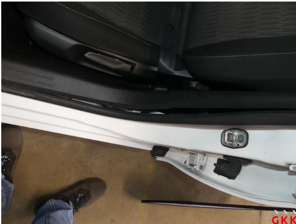
Bild 24 Tür vorne links, Einstiegsleiste, lose, instand setzen
