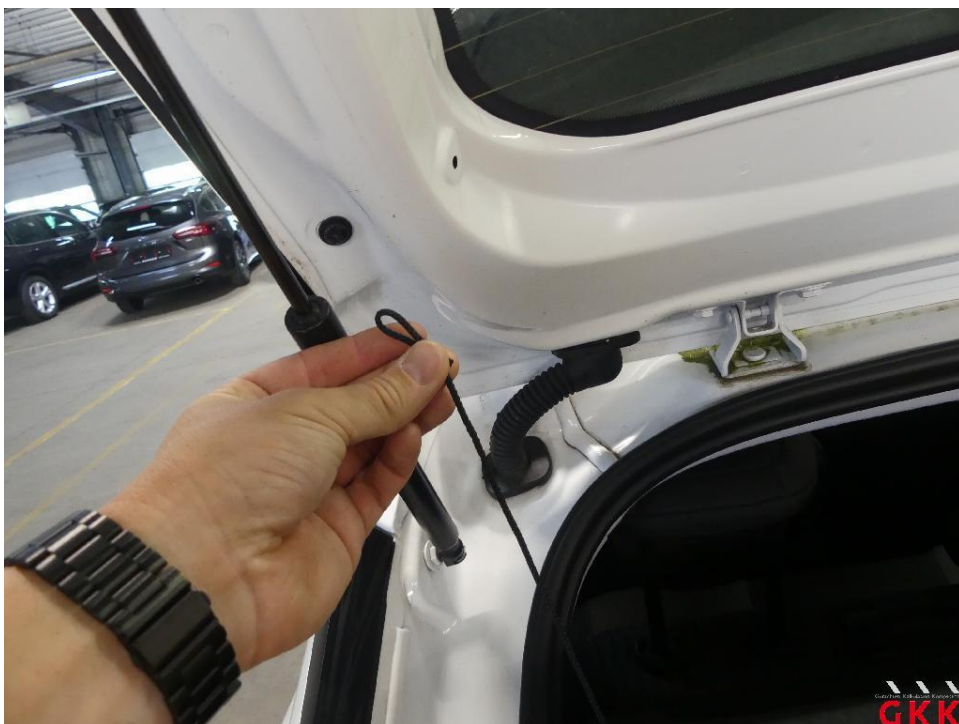
Bild 14 Laderaum, Abdeckung -Halteseil-, fehlt, ersetzen
