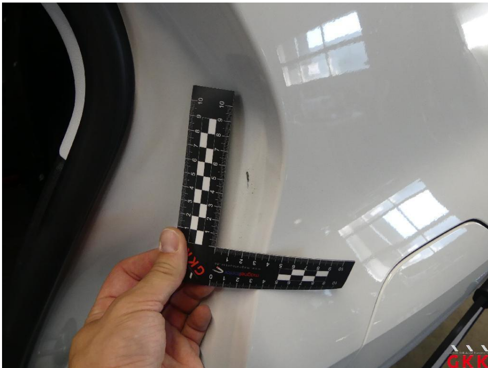
Bild 22 Tür hinten links, Einstieg, verkratzt, Smartrepair
