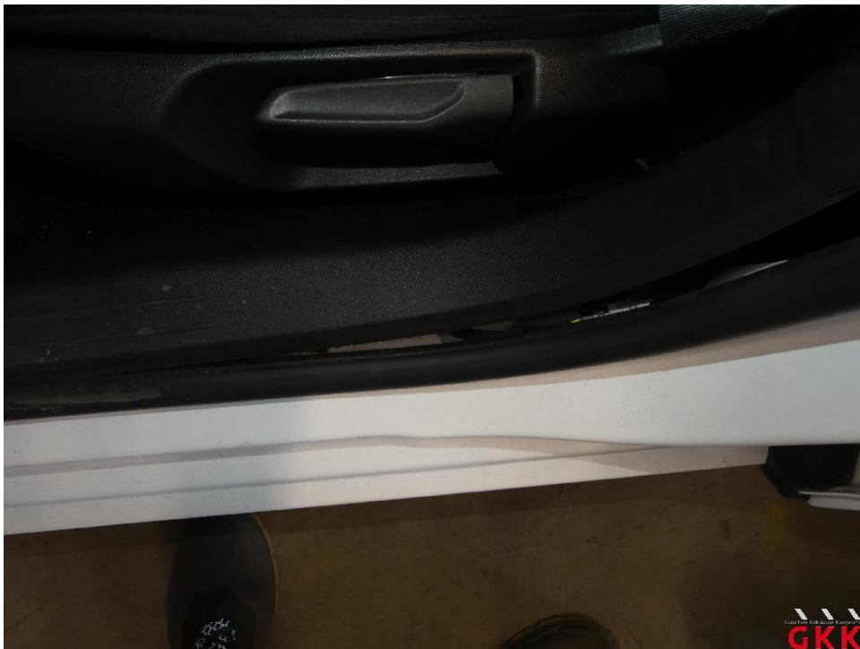
Bild 26 Tür vorne links, Einstiegsleiste, lose, instand setzen
