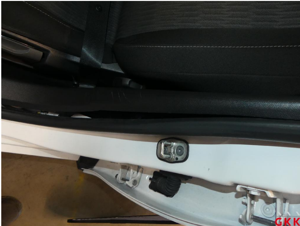
Bild 25 Tür vorne links, Einstiegsleiste, lose, instand setzen
