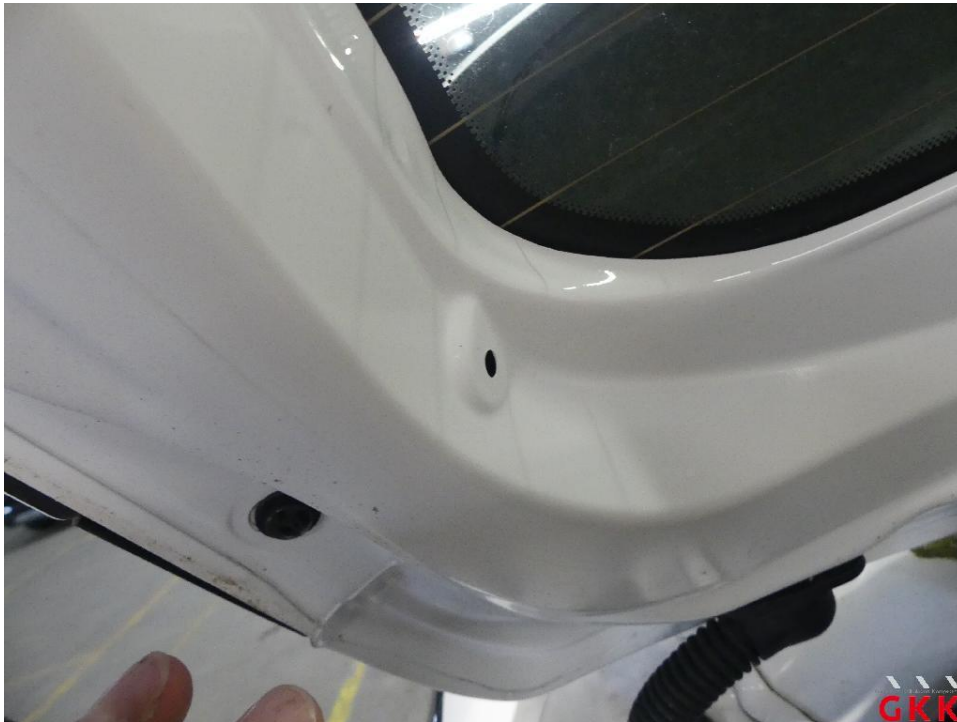
Bild 15 Laderaum, Abdeckung -Halteseil-, fehlt, ersetzen
