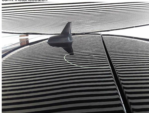
Beschädigung #3: Fahrzeugdach: Dach - Delle(n) - sanft instandsetzen
