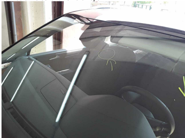
Beschädigung #6: Verglasung: Frontscheibe - Steinschlag - erneuern
