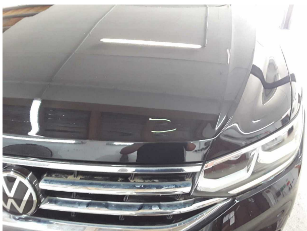
Beschädigung #1: Motorhaube: Motorhaube - verkratzt / versch... - auslegen / polieren
