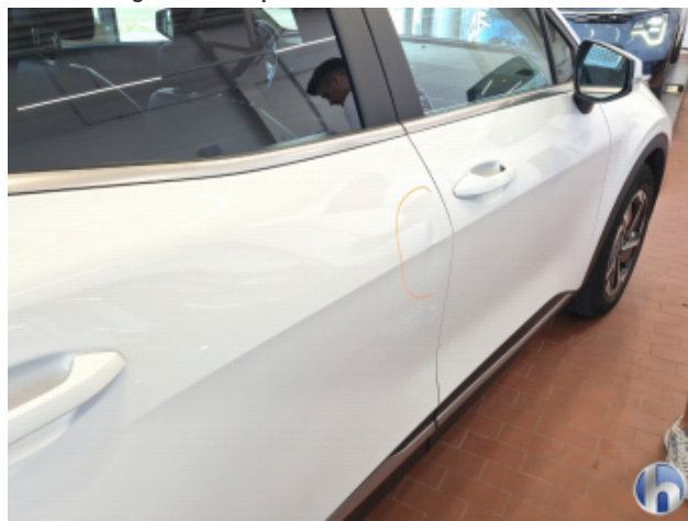
3. Tür Hinten - Rechts Beschädigt - Instandsetzen und Lackieren
