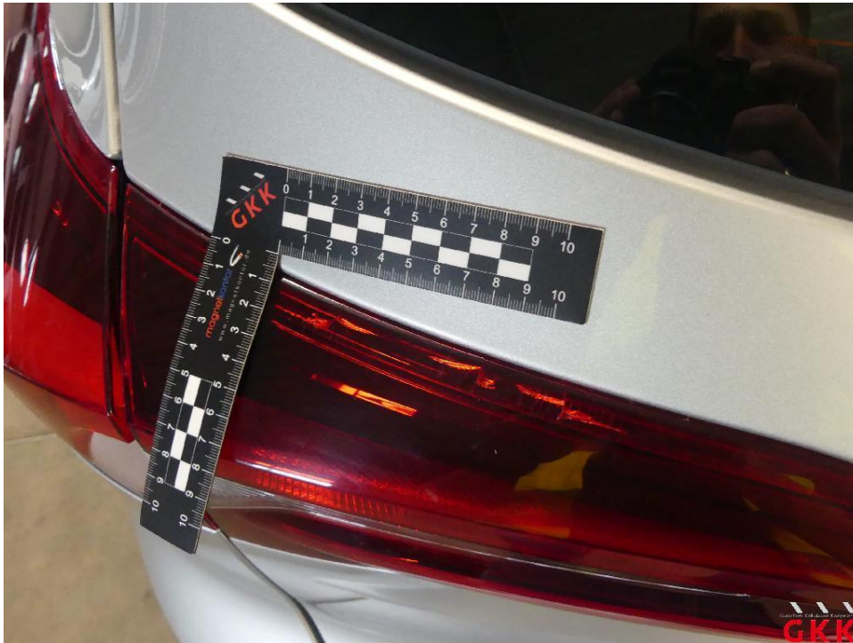
Bild 17 Rückleuchte links, innen, gerissen, ersetzen
