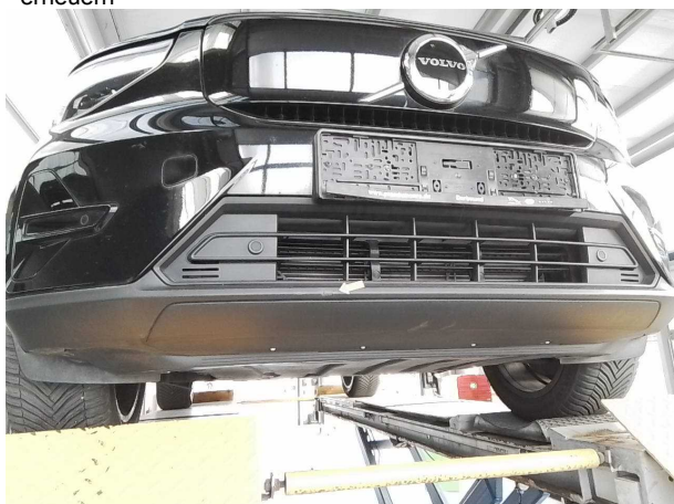
Beschädigung #3: Stossfänger vorn: Spoiler - verformt - erneuern
