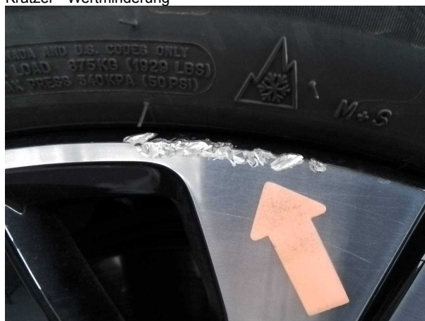
Beschädigung #2: Rad/Reifen: Leichtmetallfelge vorn rechts - verformt - erneuern
