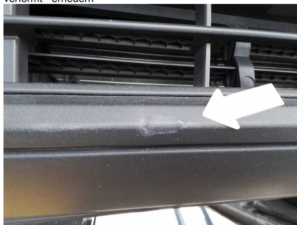
Beschädigung #3: Stossfänger vorn: Spoiler - verformt - erneuern
