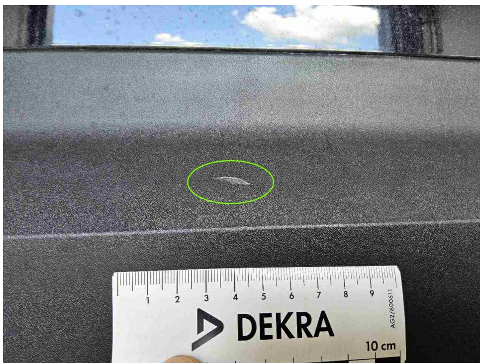
Bild 22 : Stoßfänger hinten unterhalb verschrammt
