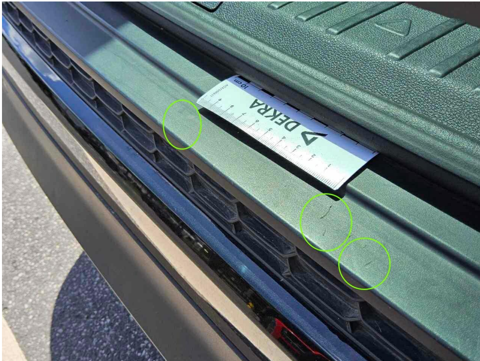
Bild 19 : Laderaum, Ladekante eingekerbt/ verschrammt
