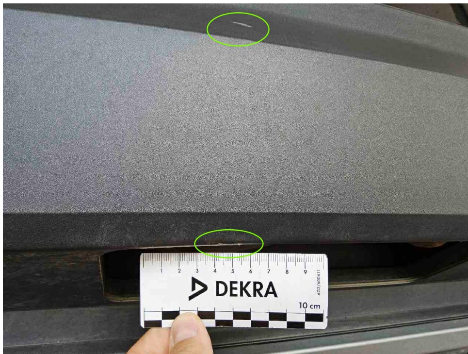
Bild 21 : Stoßfänger hinten unterhalb verschrammt
