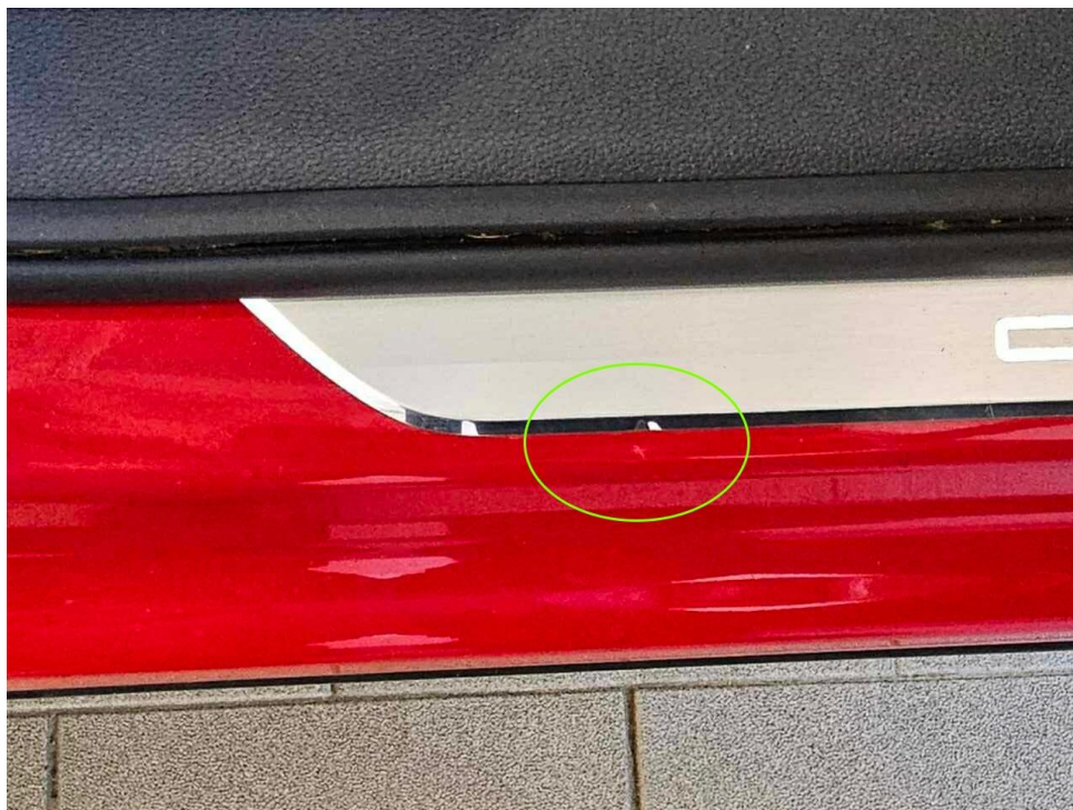
Bild 16 : Tür vorne rechts Einstieg, eingedellt, Gebrauchsspur
