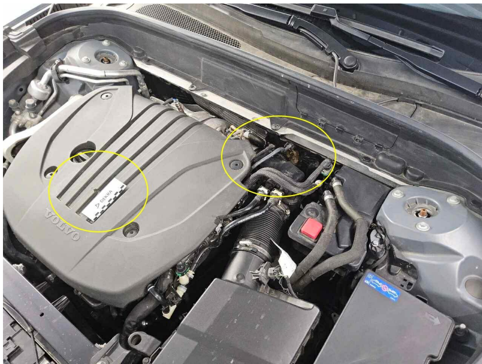
Bild 22 : Schaden Motorraum, Motorabdeckung und Stirnwanddämmmatte zerrissen
