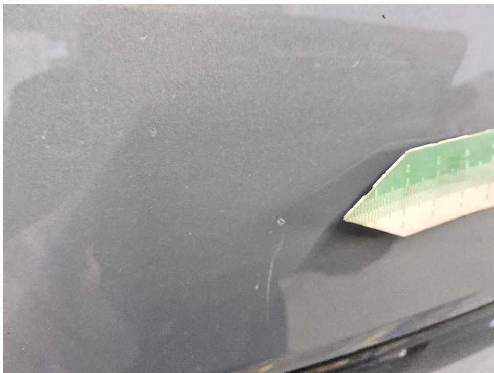
Bild 15 : Stoßfänger vorne Lackierung, Steinschlag, Gebrauchsspur
