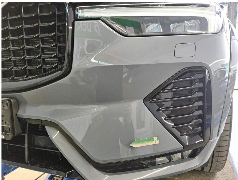
Bild 14 : Stoßfänger vorne Lackierung, Steinschlag, Gebrauchsspur
