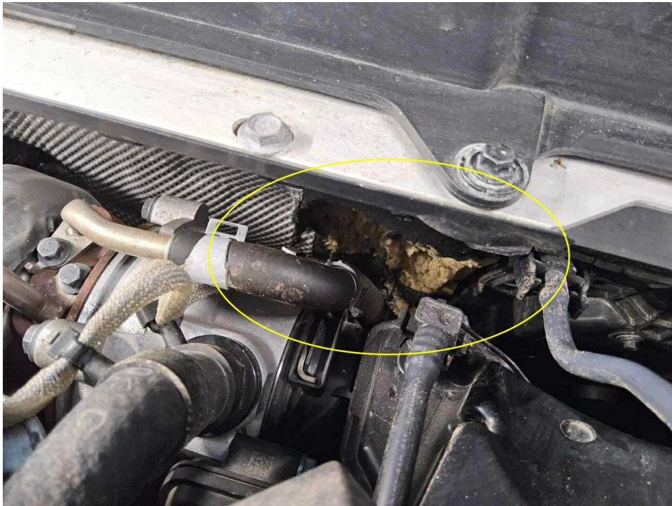
Bild 23 : Schaden Motorraum, Motorabdeckung und Stirnwanddämmmatte zerrissen
