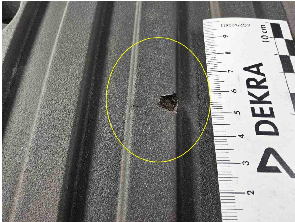
Bild 21 : Schaden Motorraum, Motorabdeckung und Stirnwanddämmmatte zerrissen
