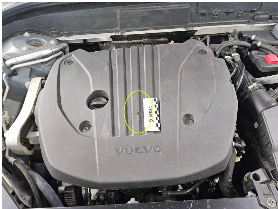
Bild 20 : Schaden Motorraum, Motorabdeckung und Stirnwanddämmmatte zerrissen
