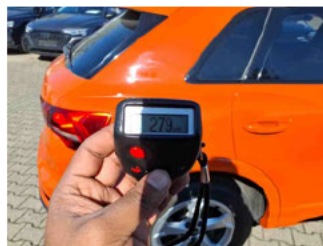
Lackstärke Seitenwand hinten rechts
