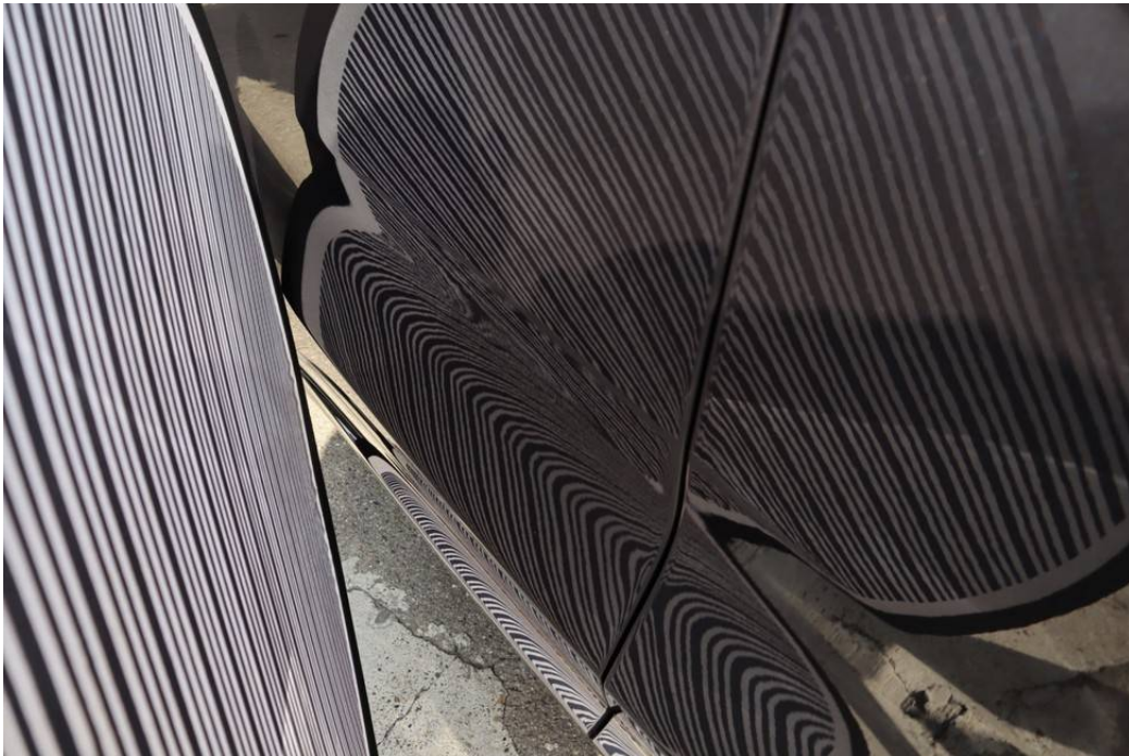
Schaden repariert - Türe vorne rechts mit Dellensegel
