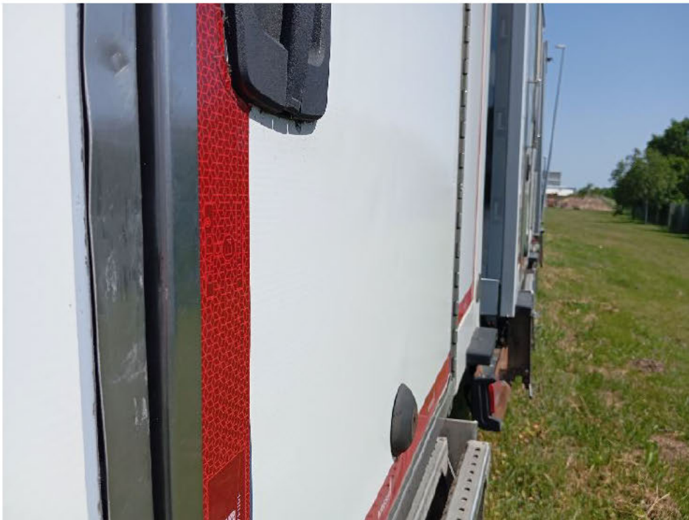
Bild: 45 Hecktür deformiert
