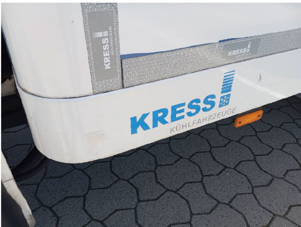
Bild: 24 Seitenwandabschlussprofil verkratzt
