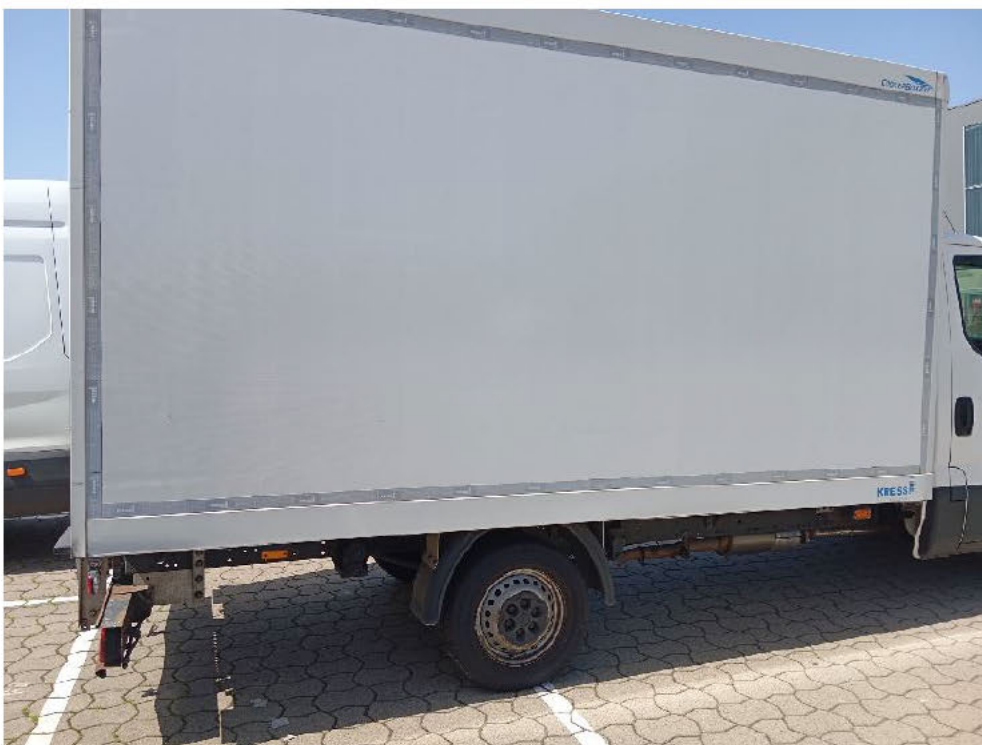
Bild: 30 Seitenwand rechts leichte streifende Druckstellen
