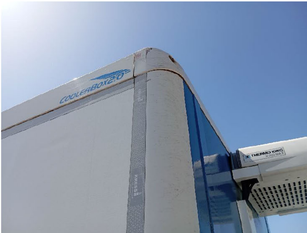
Bild: 37 Eckabschlussprofil Kofferaufbau vorn rechts angeschlagen und verformt
