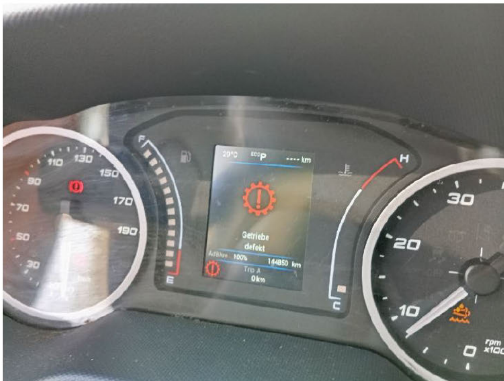
Bild: 15 Getriebefehler/möglicher Getriebeschaden
