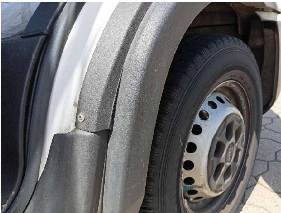
Bild: 38 Radlaufabdeckung vorne rechts gebrochen
