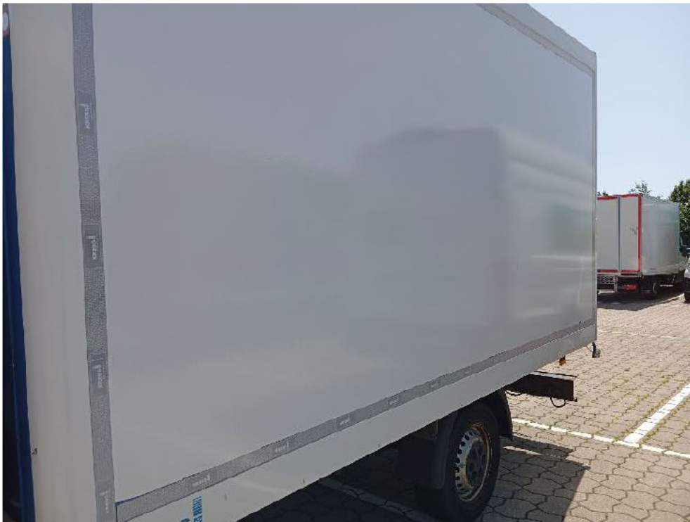
Bild: 23 Seitenwand links leichte Druckstellen
