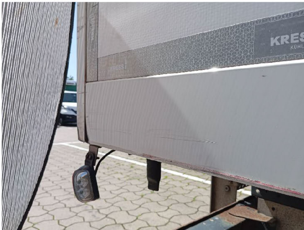
Bild: 33 Seitenwand rechts verkratzt
