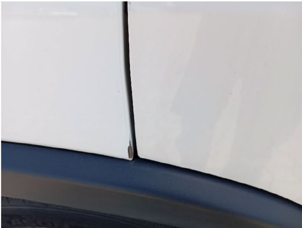
Bild: 21 Beifahrertürkante Lackabplatzungen
