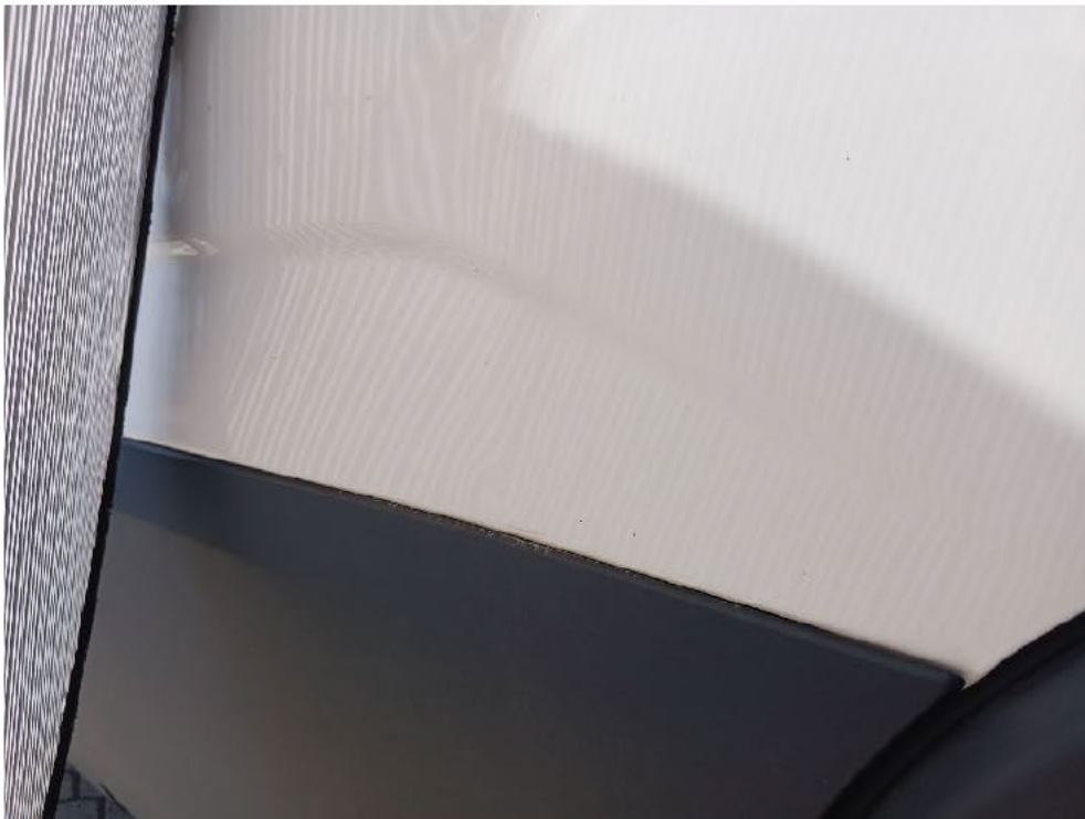
Bild: 43 Beifahrertür eingedellt
