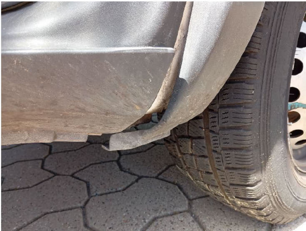
Bild: 39 Radlaufabdeckung vorne rechts gebrochen
