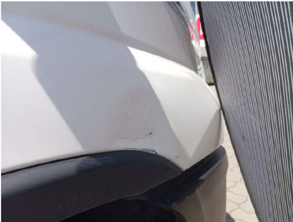
Bild: 41 Kotflügel vorne rechts verformt und verkratzt
