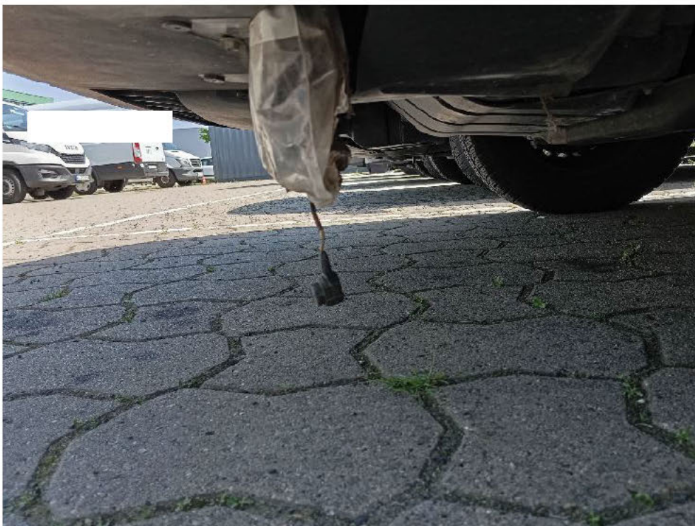
Bild: 46 Kabel Steckverbindung Motorraum lose
