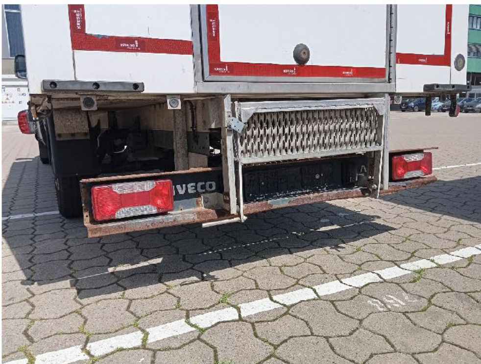
Bild: 28 Heckunterfahrschutz Korrosionsbehaftet/ Heckauftritt deformiert und lose
