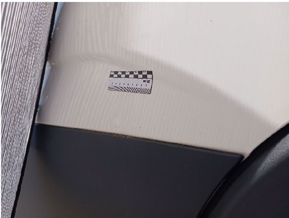
Bild: 44 Beifahrertür eingedellt
