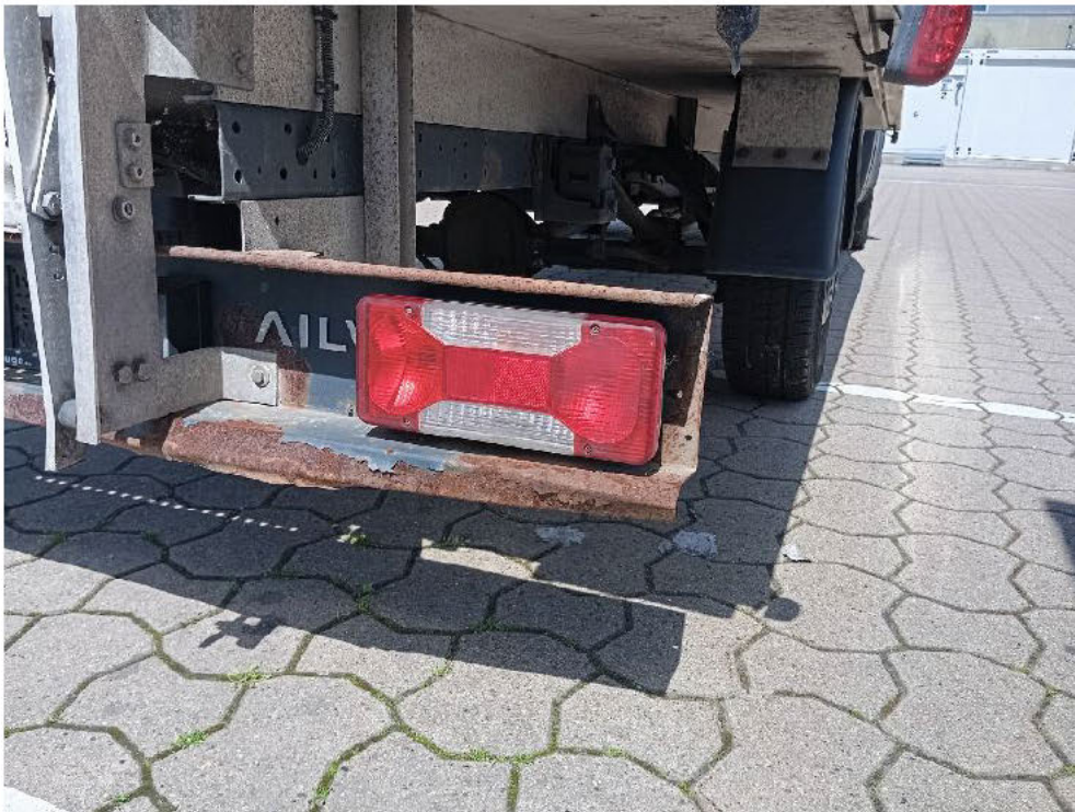
Bild: 29 Heckunterfahrschutz deformiert
