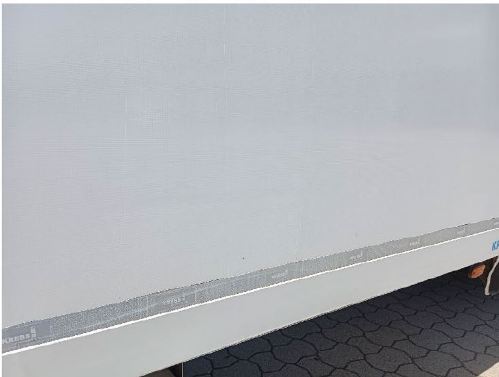
Bild: 32 Seitenwand rechts leichte streifende Druckstellen
