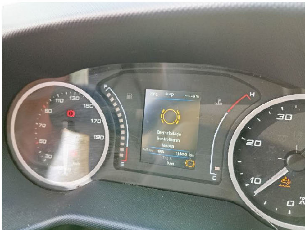
Bild: 17 Bremsbeläge verschlissen
