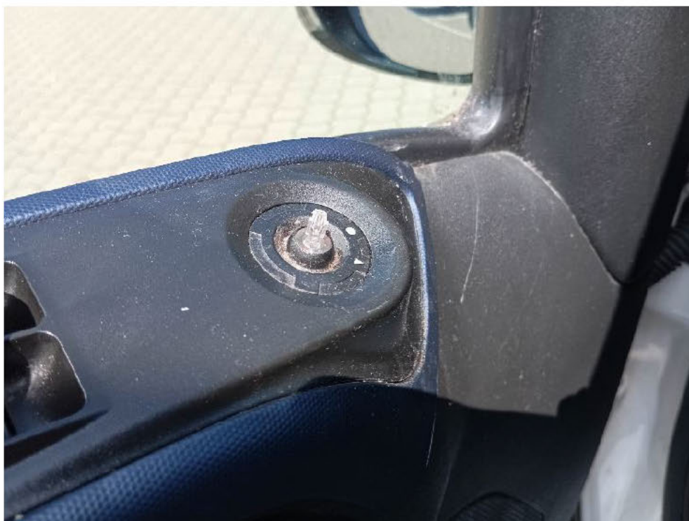
Bild: 18 Außenspiegelversteller links abgerissen
