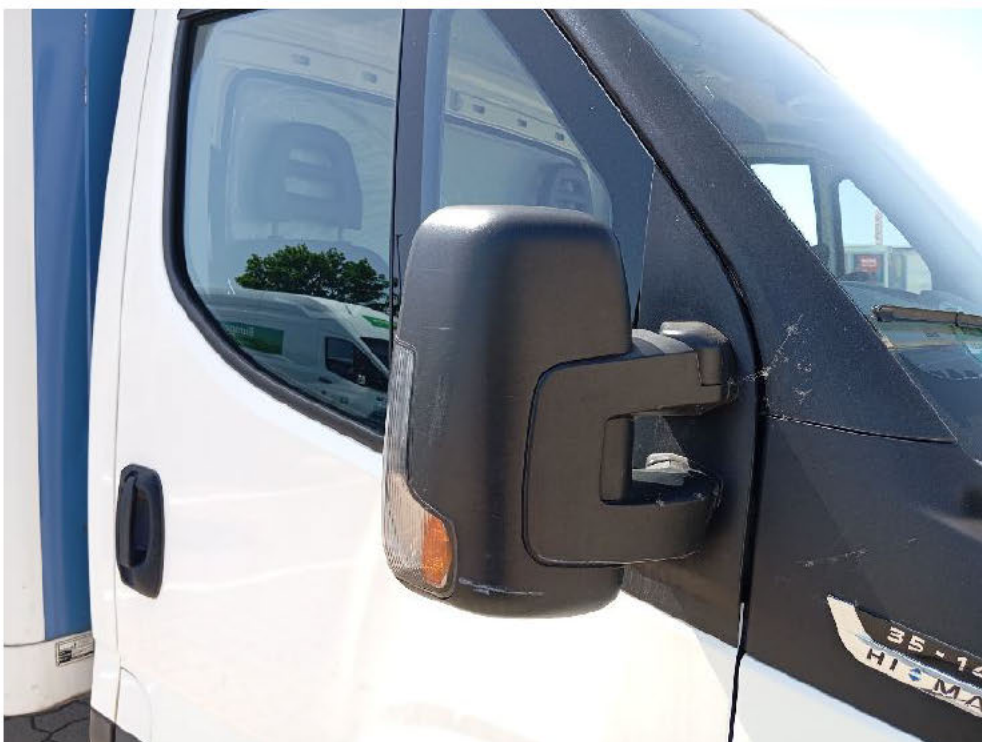
Bild: 42 Außenspiegelkappe rechts verkratzt/ Blinkerglas gebrochen
