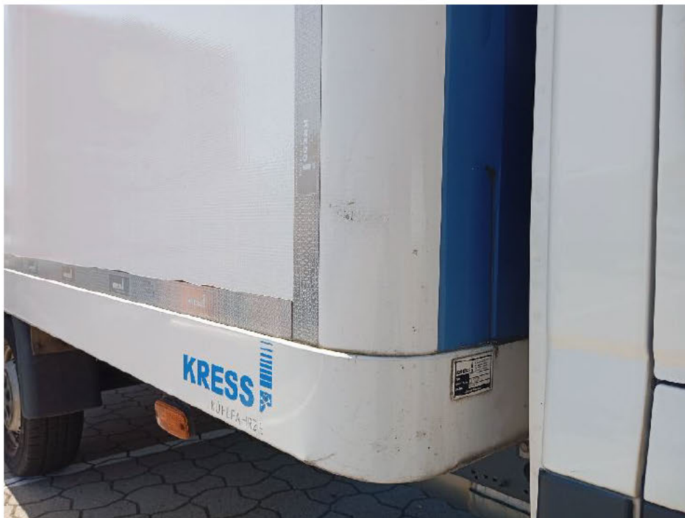
Bild: 35 Eckabschlussprofil Kofferaufbau vorn rechts angeschlagen und verformt
