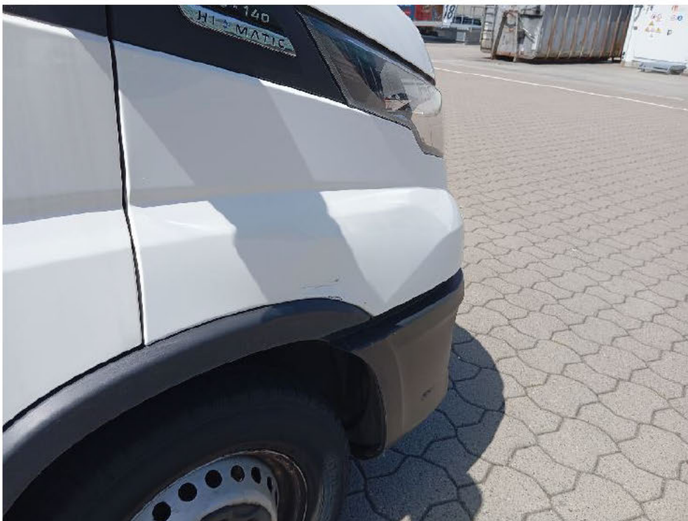
Bild: 40 Kotflügel vorne rechts verformt und verkratzt
