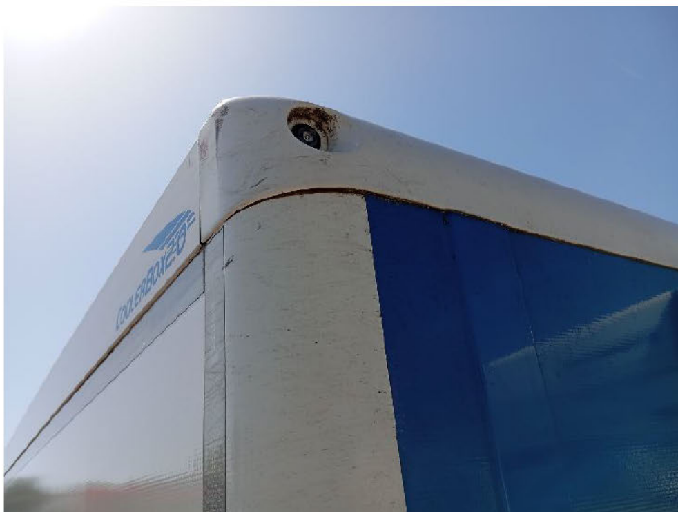
Bild: 36 Eckabschlussprofil Kofferaufbau vorn rechts angeschlagen und verformt
