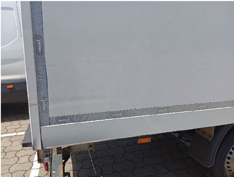
Bild: 31 Seitenwand rechts leichte streifende Druckstellen
