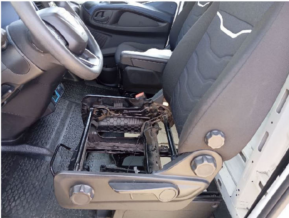
Bild: 19 Fahrersitzpolster fehlt/ Sitzverstellung defekt
