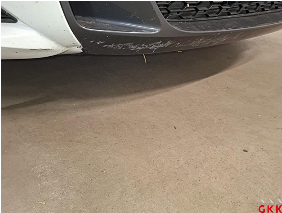
Bild 23 Stoßfänger vorne, Spoiler -lackiert-, beschädigt, ersetzen
