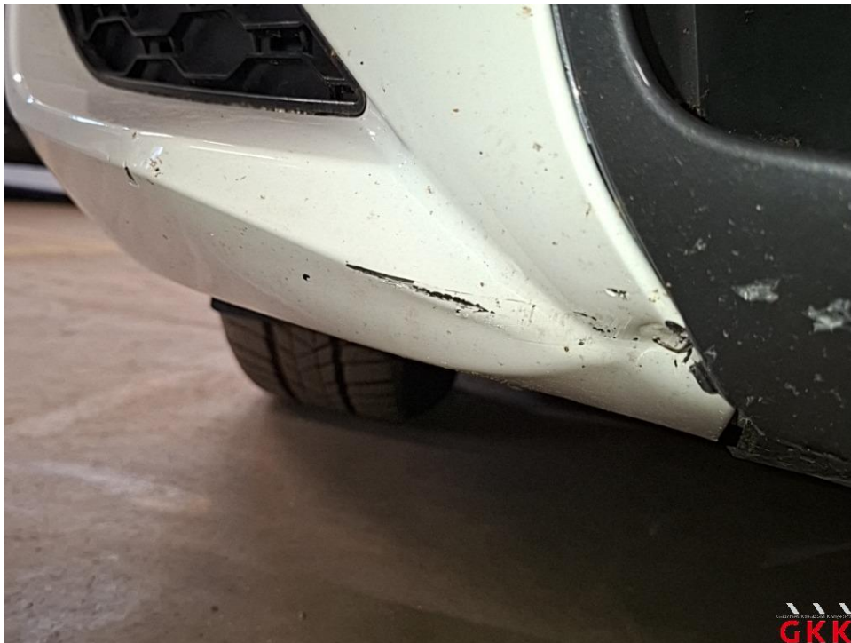
Bild 22 Stoßfänger vorne, Verkleidung -lackiert-, beschädigt, ersetzen
