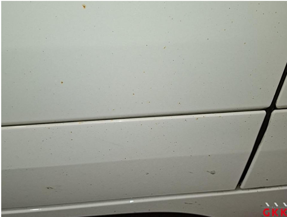
Bild 18 Fahrzeug, außen, Lackierung verwittert / matt, aufbereiten
