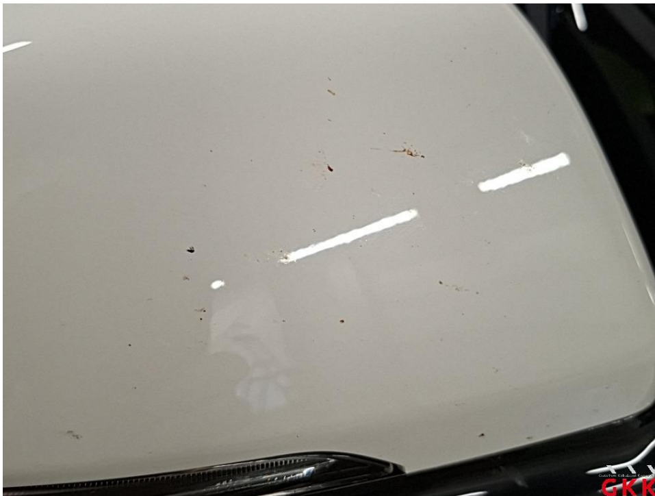
Bild 20 Fahrzeug, außen, Lackierung verwittert / matt, aufbereiten
