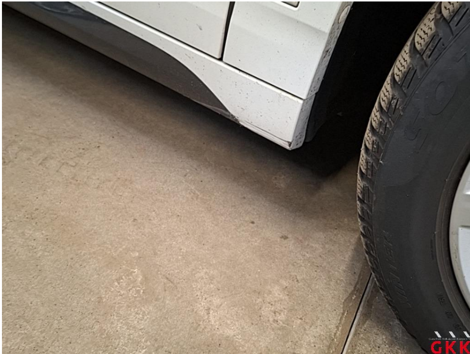
Bild 25 Schweller rechts, Abdeckung -lackiert-, beschädigt, ersetzen
