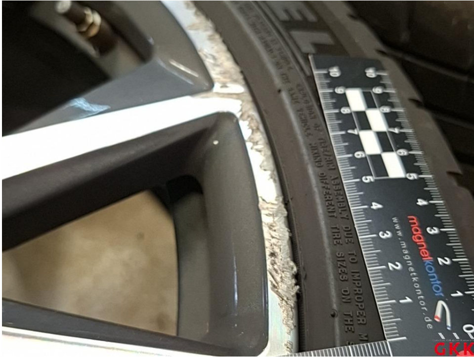
Bild 17 LM-Rad, 2 x beiliegend, Materialabtrag, ersetzen
