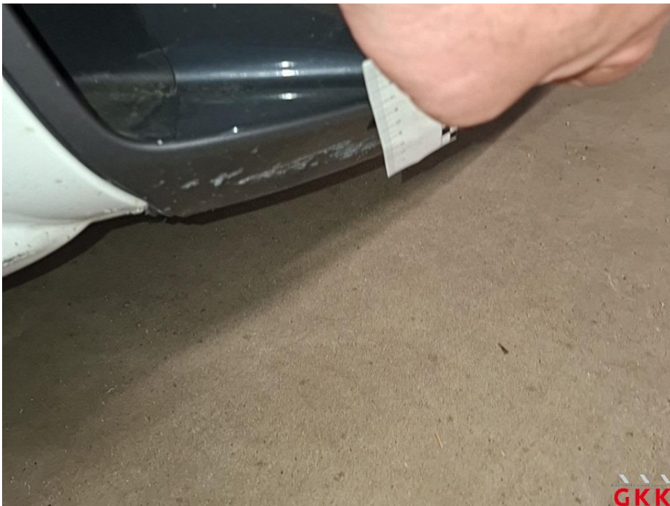
Bild 24 Stoßfänger vorne, Spoiler -lackiert-, beschädigt, ersetzen
