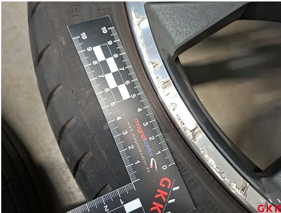
Bild 16 LM-Rad, 2 x beiliegend, Materialabtrag, ersetzen
