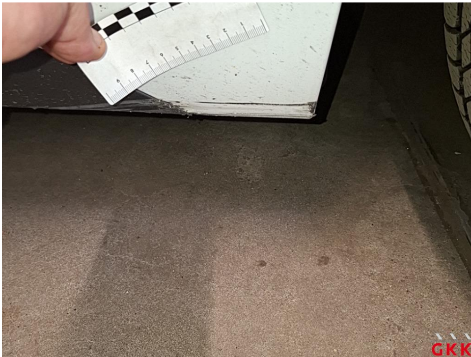
Bild 26 Schweller rechts, Abdeckung -lackiert-, beschädigt, ersetzen
