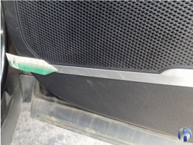
6. Verkleidung Gebrauchsspuren - Ohne Reparatur
