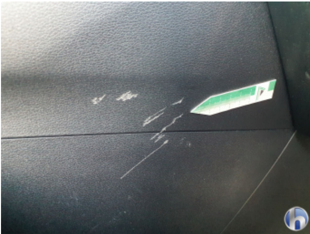
8. Sitz Innenraum rechts vorne Beschädigt - Erneuern
