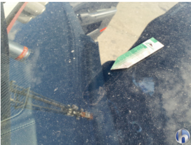
5. Windschutzscheibe Steinschlag Im Sichtfeld - Erneuern
