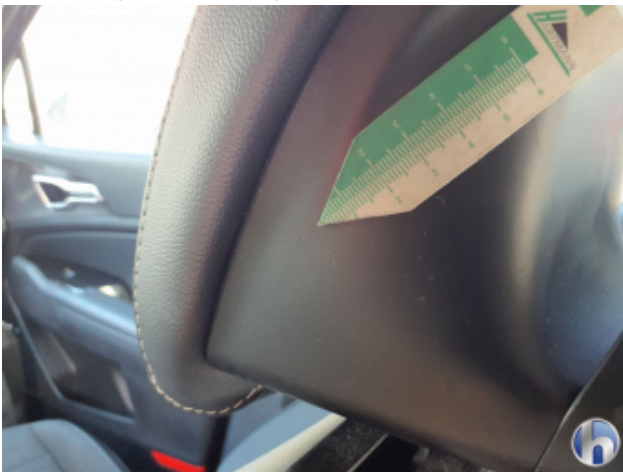
6. Verkleidung Gebrauchsspuren - Ohne Reparatur
