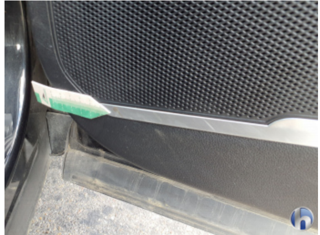
6. Verkleidung Gebrauchsspuren - Ohne Reparatur
