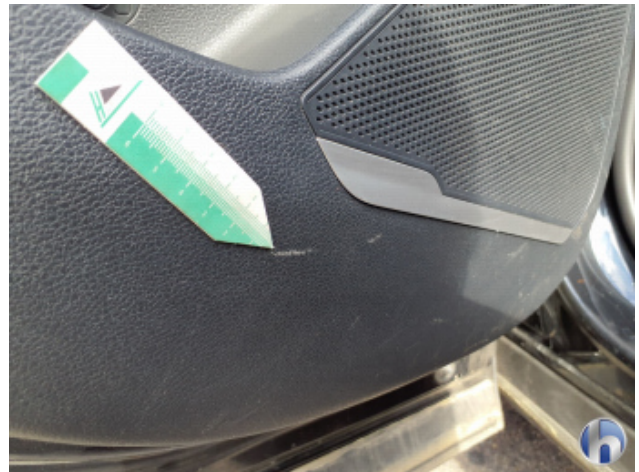
6. Verkleidung Gebrauchsspuren - Ohne Reparatur
