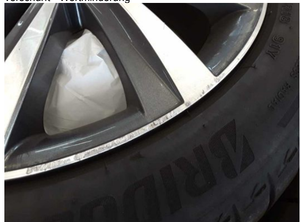
Beschädigung #6: 2.Radsatz: 1 Leichtmetallfelge - verkratzt / verschürft - Wertminderung
