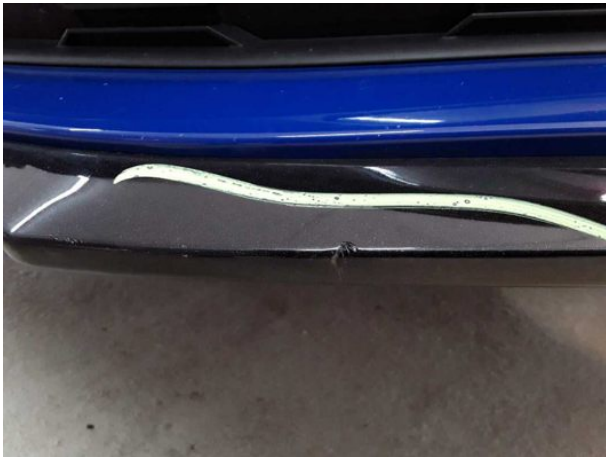
Beschädigung #5: Stossfänger vorn: Spoiler - verkratzt / verschürft - Wertminderung
