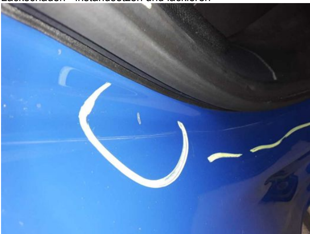
Beschädigung #11: Seitenwand rechts: Einstieg - Delle / Lackschaden - instandsetzen und lackieren
