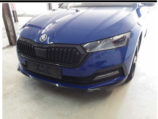
Beschädigung #5: Stossfänger vorn: Spoiler - verkratzt / verschürft - Wertminderung
