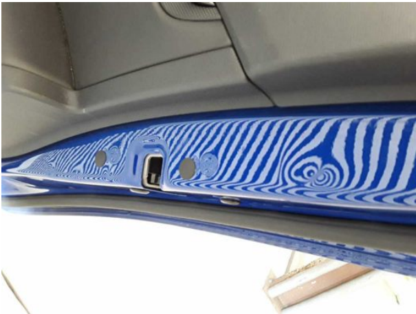
Beschädigung #13: Tür hinten rechts: Tür - Delle / Lackschaden - instandsetzen und lackieren
