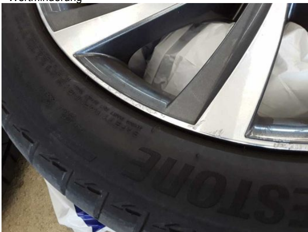
Beschädigung #6: 2.Radsatz: 1 Leichtmetallfelge - verkratzt / verschürft - Wertminderung
