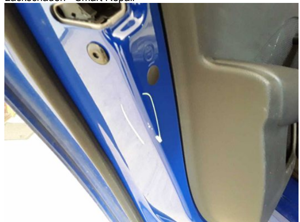
Beschädigung #9: Tür hinten links: Tür - verkratzt / verschürft... Smart Repair
