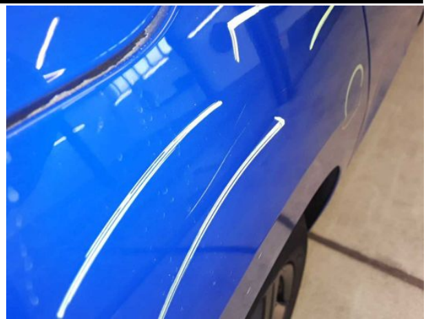
Beschädigung #12: Seitenwand rechts: Seitenwand - Delle / Lackschaden - instandsetzen und lackieren
