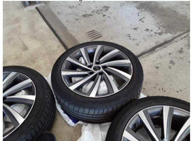
Beschädigung #6: 2.Radsatz: 1 Leichtmetallfelge - verkratzt / verschürft - Wertminderung
