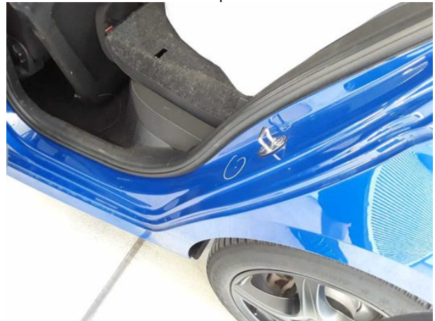
Beschädigung #8: Seitenwand links: Einstieg - Delle / Lackschaden - Smart Repair
