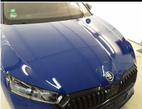
Beschädigung #10: Motorhaube: Motorhaube - Delle(n) - sanft instandsetzen
