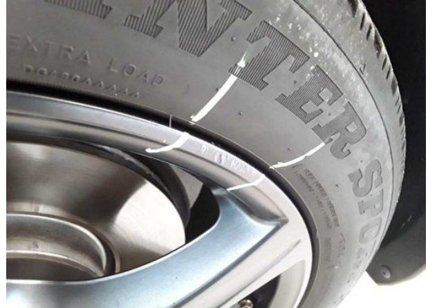
Beschädigung #1: Rad/Reifen: Leichtmetallfelge vorn links - verkratzt / verschürft - kein Abzug
