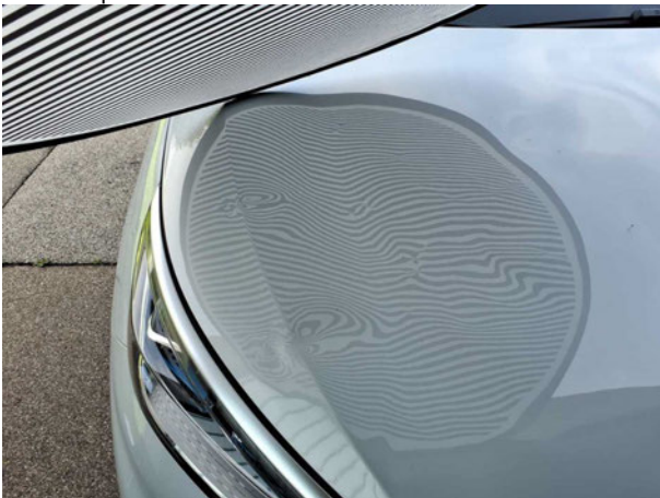
Beschädigung #7: Motorhaube: Motorhaube - verformt - erneuern
