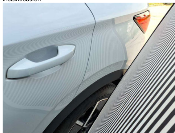
Beschädigung #4: Seitenwand links: Seitenwand - Delle(n) - sanft instandsetzen
