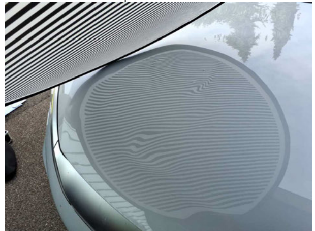
Beschädigung #7: Motorhaube: Motorhaube - verformt - erneuern
