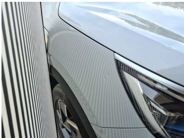
Beschädigung #1: Kotflügel rechts: Kotflügel rechts - Delle(n) - sanft instandsetzen
