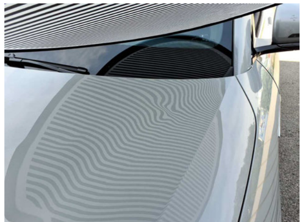
Beschädigung #7: Motorhaube: Motorhaube - verformt - erneuern
