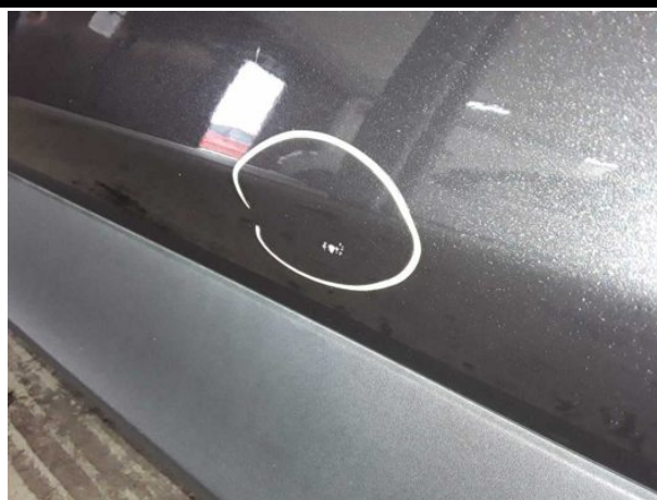
Beschädigung #11: Tür vorn links: Tür - Delle / Lackschaden - instandsetzen und lackieren
