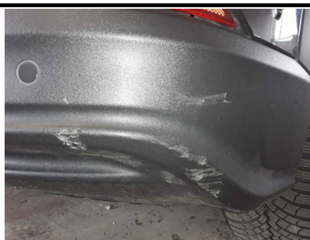
Beschädigung #5: Stossfänger hinten: Spoiler - verkratzt / verschürft - erneuern
