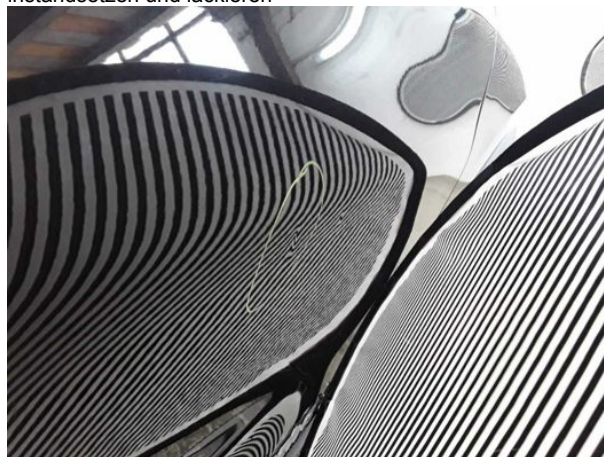
Beschädigung #12: Tür vorn rechts: Tür - Delle / Lackschaden - instandsetzen und lackieren
