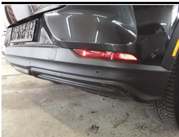
Beschädigung #5: Stossfänger hinten: Spoiler - verkratzt / verschürft - erneuern
