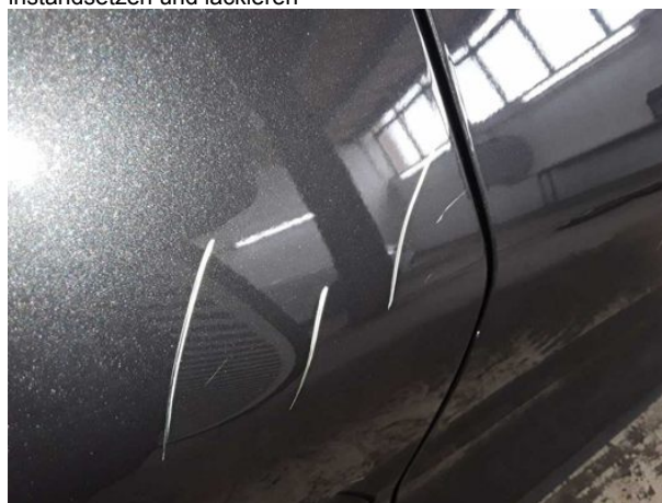
Beschädigung #10: Tür hinten rechts: Tür - verkratzt / verschürft - instandsetzen und lackieren
