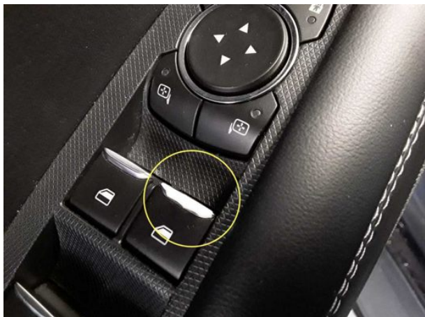
Beschädigung #1: Tür vorn links: Schaltereinheit - Lackmangel - Wertminderung
