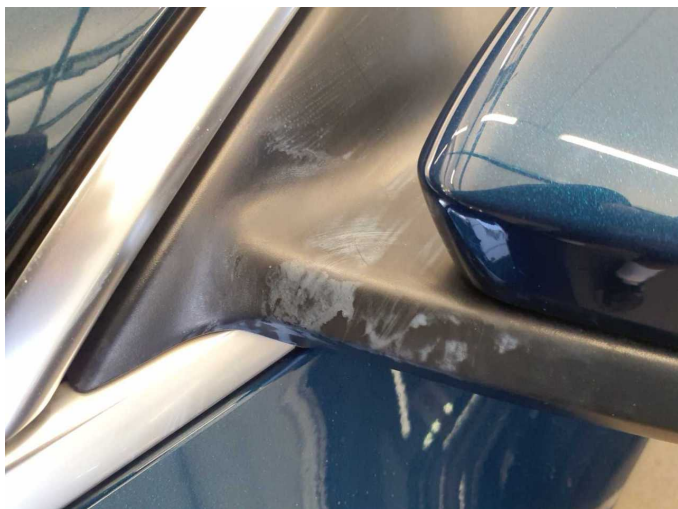
Damage 5: Wing mirror - left side: Mirror bracket (Verätzung) - Paint defect - Replace
