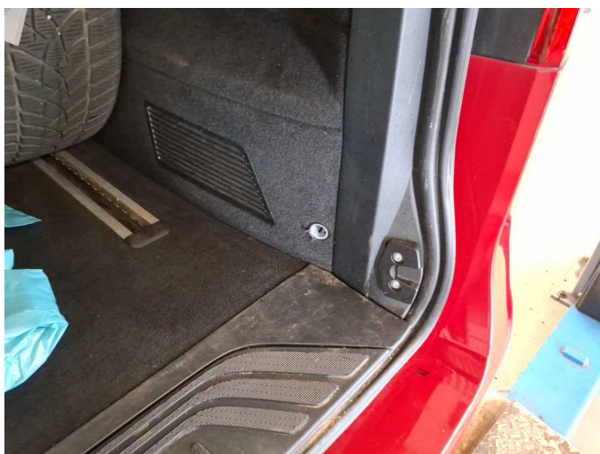
Damage 3: Electrical system: Power socket (Laderaum - Deckel fehlt) - Broken / torn - Replace
