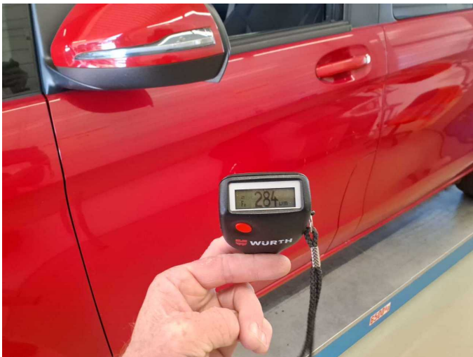
Door - front left side: 284 µm
