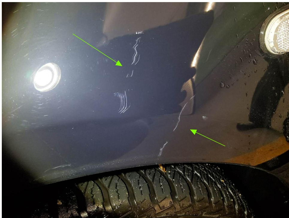
Bild 15 : Kotflügel links zerkratzt
