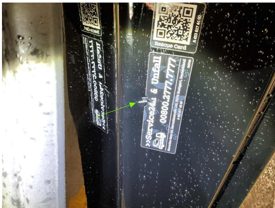
Bild 13 : Einstieg links zerkratzt
