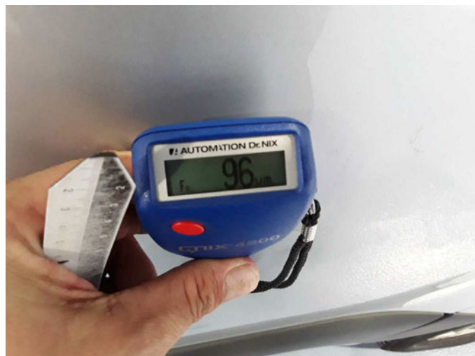
Tür vorne rechts: 96 \mu\text{m}
