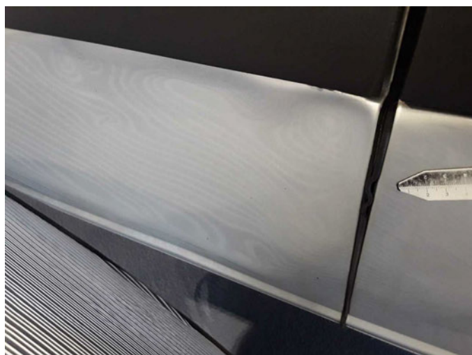
Beschädigung 25: Schweller links: Schweller - verformt - erneuern
