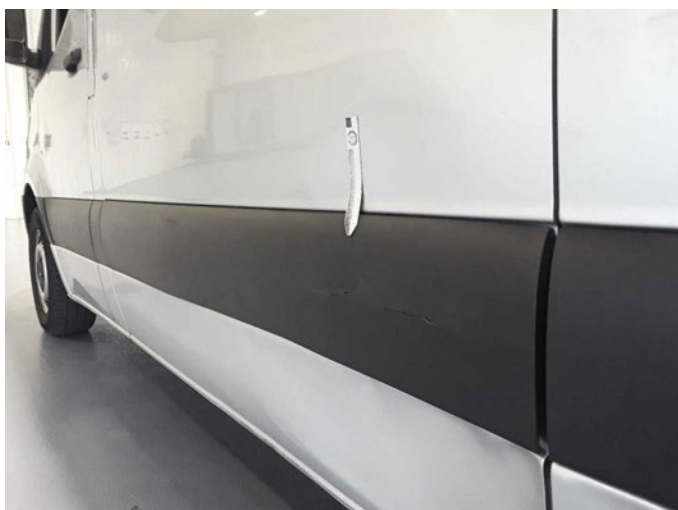
Beschädigung 24: Seitenwand links: Schutzleiste - beschädigt - erneuern
