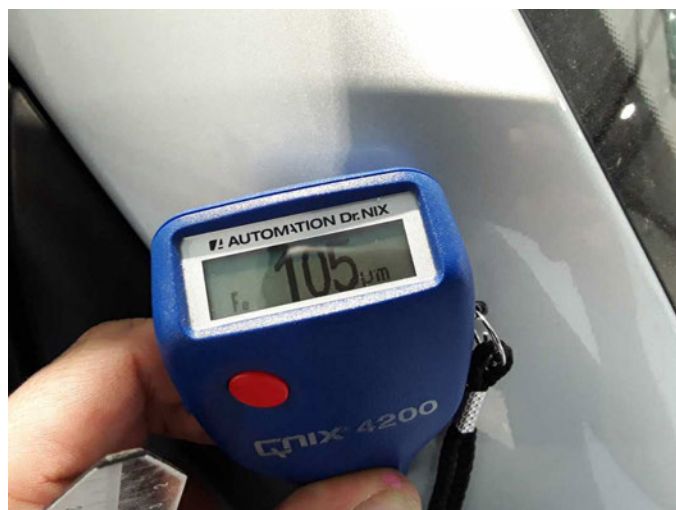
Dachholm rechts: 105 µm
