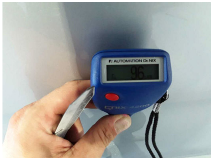
Seitenwand rechts: 96 µm
