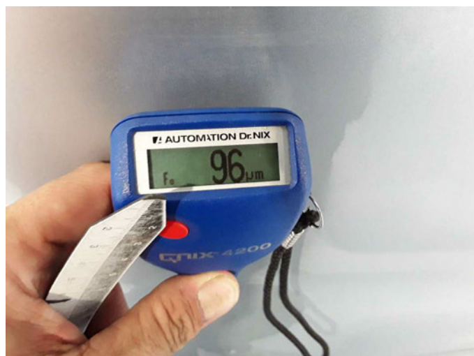
Tür hinten rechts: 96 µm
