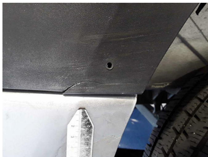
Beschädigung 10: Seitenwand rechts: Schutzleiste - beschädigt - erneuern
