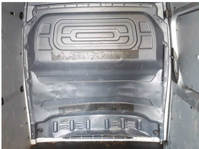
Beschädigung 1: Fahrerhaus: Rückwand - verformt - erneuern
