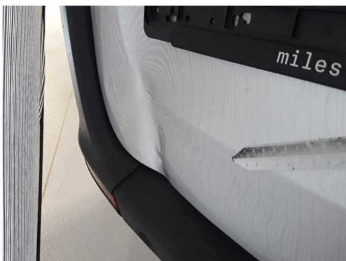
Beschädigung 28: Heckklappe/-tür: Hecktür links - verformt - erneuern
