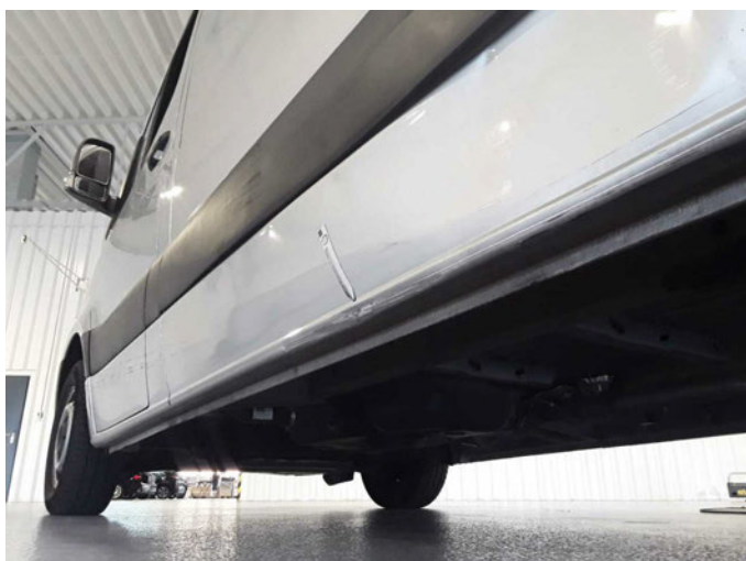
Beschädigung 25: Schweller links: Schweller - verformt - erneuern
