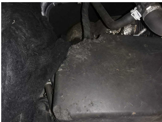
Beschädigung 34: Motor: Motorabdeckung - beschädigt - erneuern
