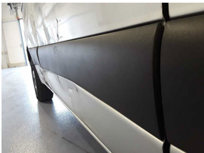
Beschädigung 14: Schiebetür rechts: Schutzleiste - verkratzt / verschürft - erneuern
