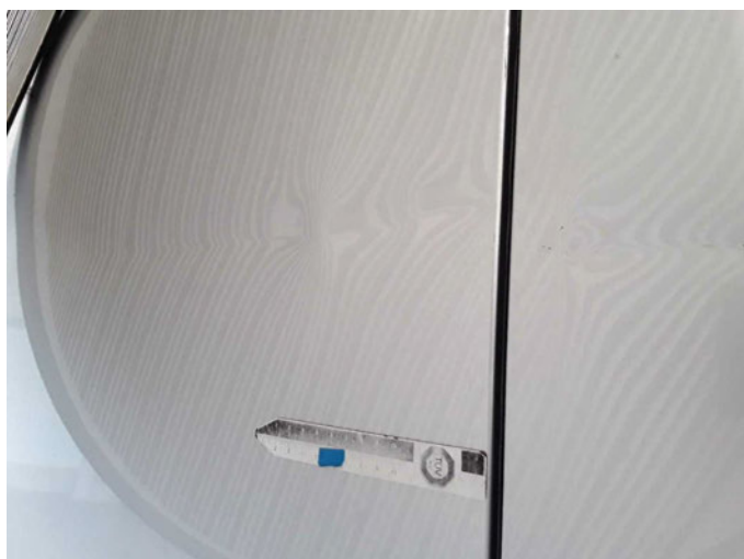
Beschädigung 12: Seitenwand rechts: Seitenwand - beschädigt - erneuern
