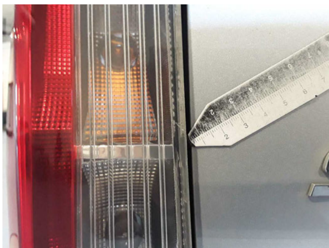
Beschädigung 27: Heckleuchte: Heckleuchte links - beschädigt - erneuern
