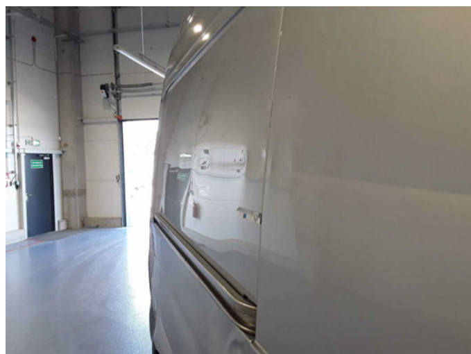
Beschädigung 12: Seitenwand rechts: Seitenwand - beschädigt - erneuern
