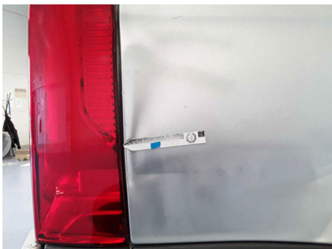
Beschädigung 8: Heckleuchte: Heckleuchte rechts - beschädigt - erneuern
