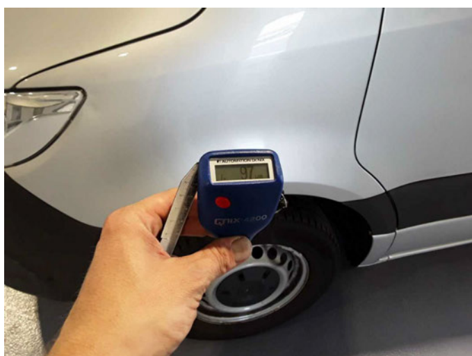
Kotflügel links: 97 \mu\text{m}
