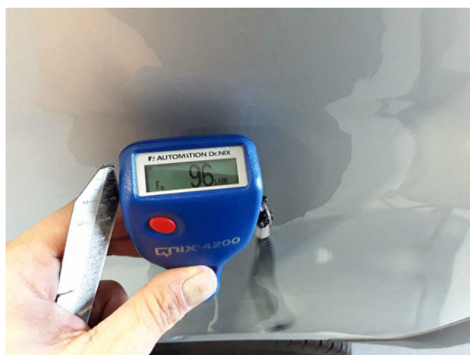
Seitenwand links: 96 \mu\text{m}
