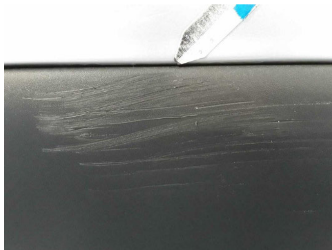
Beschädigung 14: Schiebetür rechts: Schutzleiste - verkratzt / verschürft - erneuern
