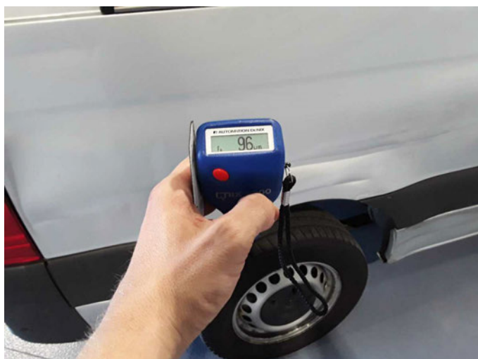
Seitenwand rechts: 96 µm
