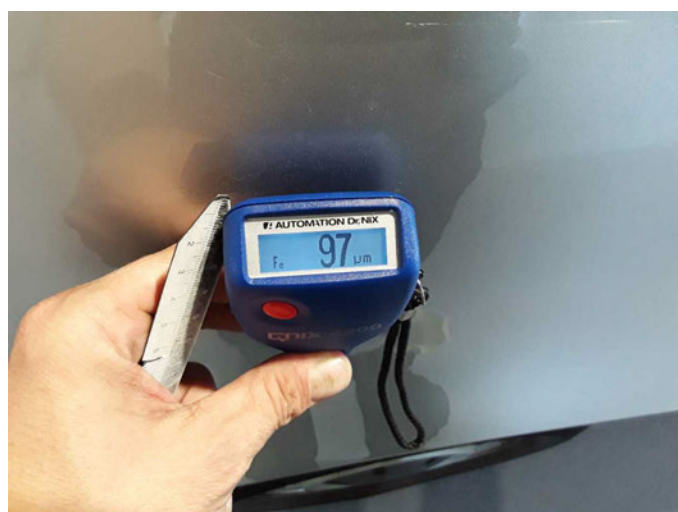
Kotflügel links: 97 \mu\text{m}
