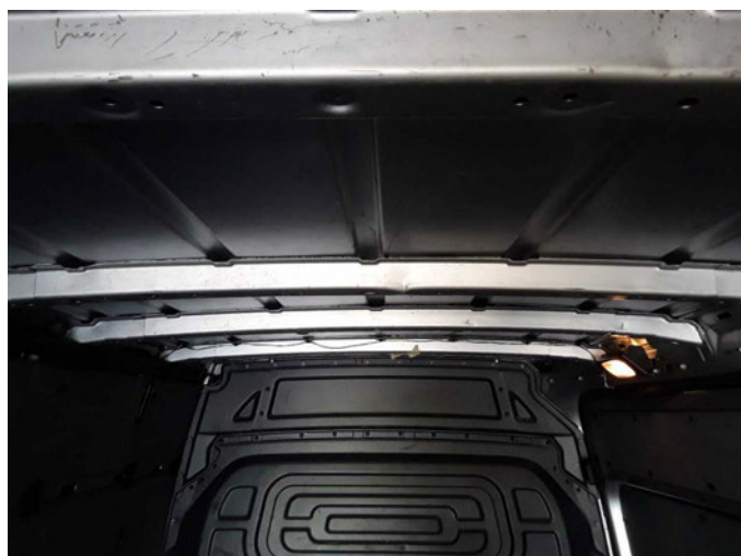
Beschädigung 38: Verkleidungen/Abdeckungen: Dachverkleidung Mitte - nicht fachgerecht instandgesetzt - instandsetzen und lackieren
