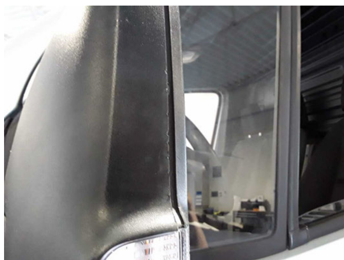
Beschädigung 23: Außenspiegel links: Abdeckkappe - beschädigt - erneuern
