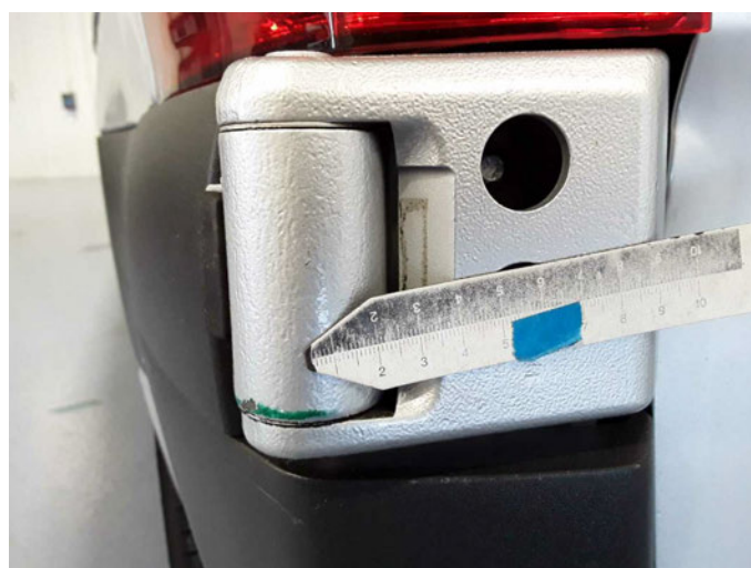
Beschädigung 7: Heckklappe/-tür: Scharnier - verkrazt / verschuift - lackieren
