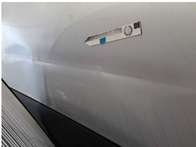
Beschädigung 15: Schiebetür rechts: Schiebetür - verformt - erneuern
