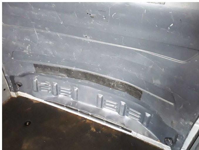
Beschädigung 1: Fahrerhaus: Rückwand - verformt - erneuern
