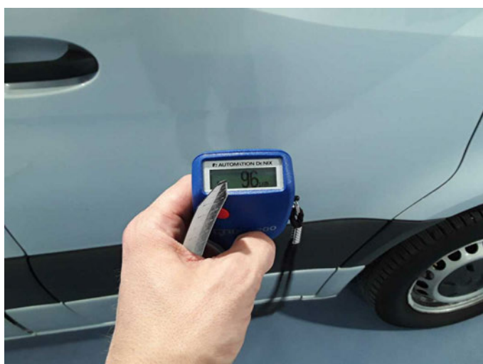
Tür vorne rechts: 96 \mu\text{m}
