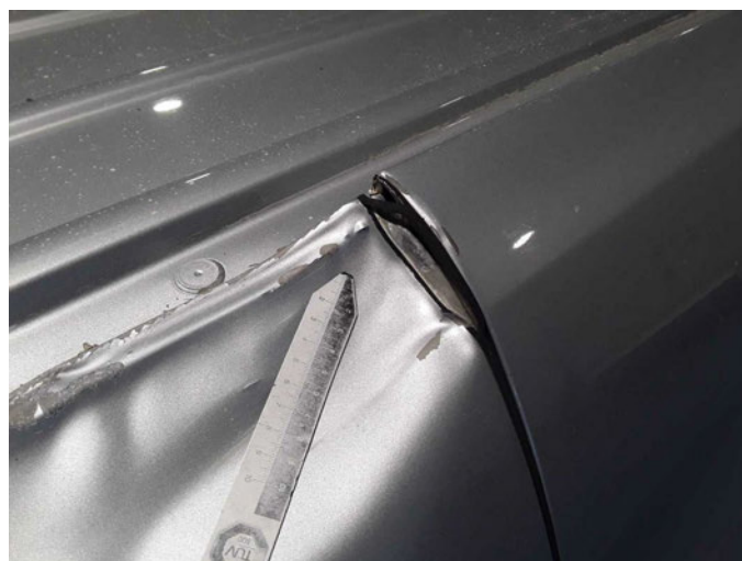
Beschädigung 35: Fahrzeugdach: Dachholm links (Schadenserweiterung möglich kein Temporärer Schutz) - beschädigt - erneuern
