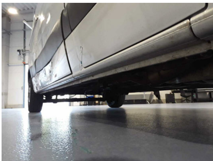
Beschädigung 16: Schweller rechts: Schweller - beschädigt - erneuern
