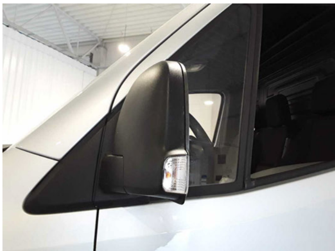
Beschädigung 23: Außenspiegel links: Abdeckkappe - beschädigt - erneuern
