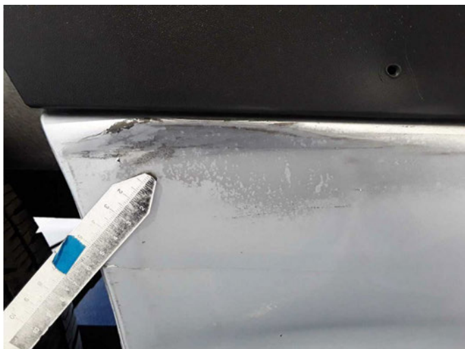
Beschädigung 13: Schweller rechts: Schweller - verformt - erneuern
