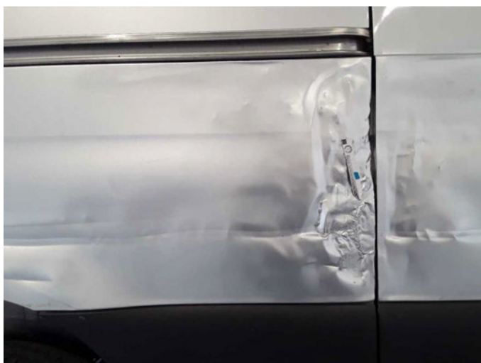
Beschädigung 12: Seitenwand rechts: Seitenwand - beschädigt - erneuern
