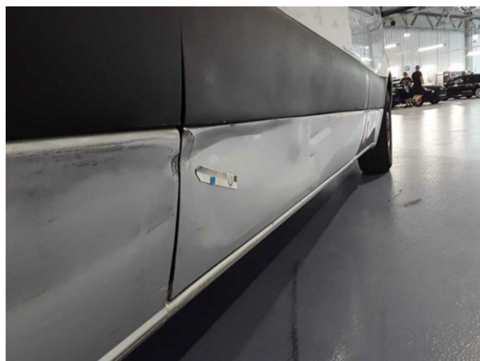
Beschädigung 15: Schiebetür rechts: Schiebetür - verformt - erneuern
