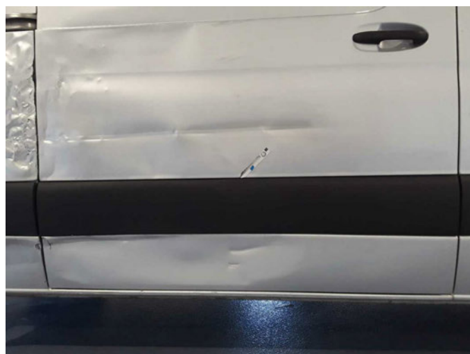
Beschädigung 14: Schiebetür rechts: Schutzleiste - verkratzt / verschürft - erneuern
