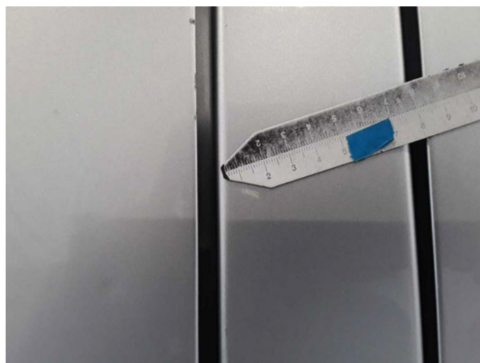
Beschädigung 17: Karosserie: B-Säule rechts - verkratzt / verschürft - lackieren
