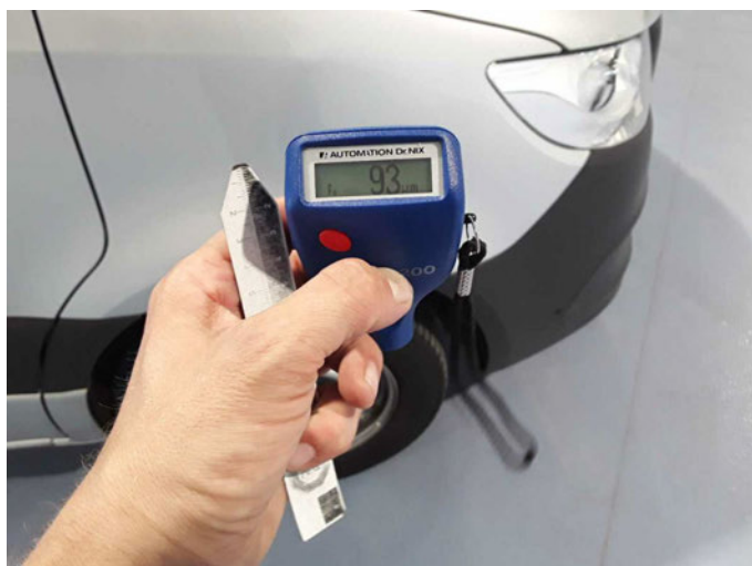
Kotflügel rechts: 93 \mu\text{m}
