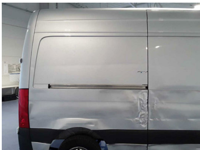
Beschädigung 12: Seitenwand rechts: Seitenwand - beschädigt - erneuern
