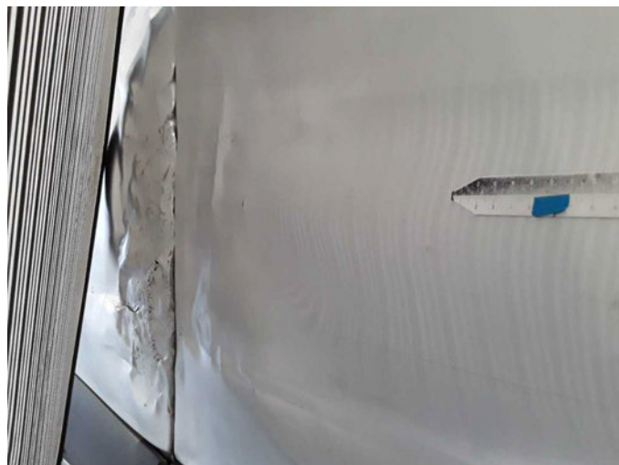
Beschädigung 15: Schiebetür rechts: Schiebetür - verformt - erneuern
