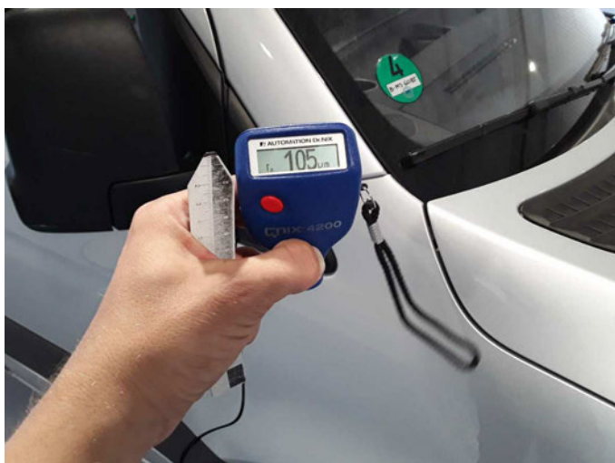
Dachholm rechts: 105 µm
