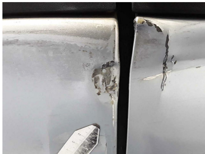
Beschädigung 13: Schweller rechts: Schweller - verformt - erneuern
