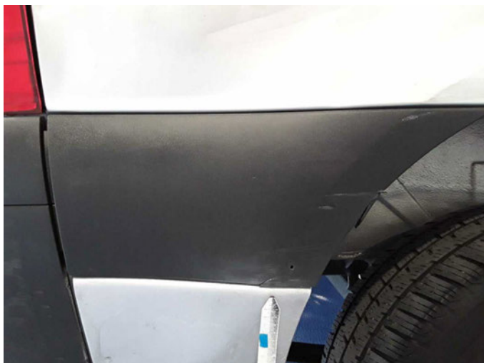
Beschädigung 10: Seitenwand rechts: Schutzleiste - beschädigt - erneuern
