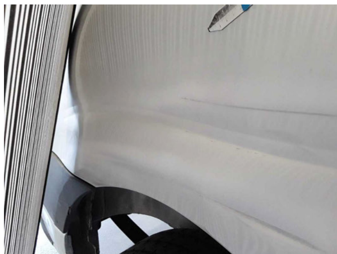
Beschädigung 12: Seitenwand rechts: Seitenwand - beschädigt - erneuern
