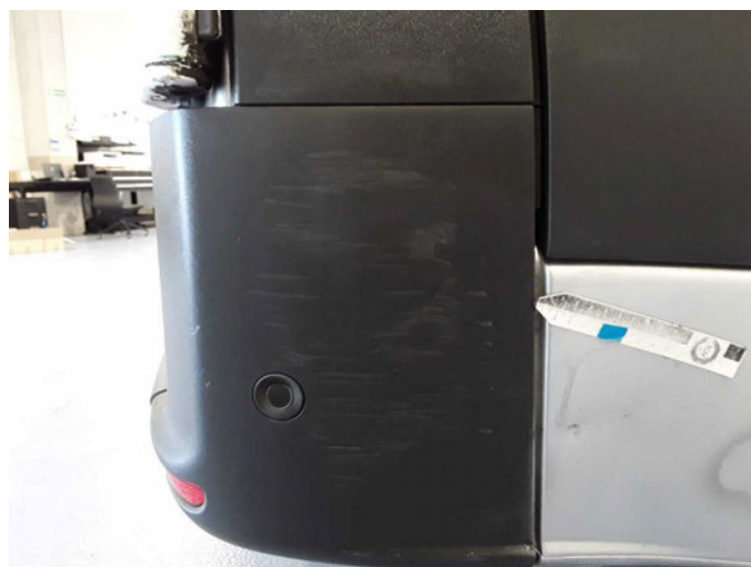
Beschädigung 9: Stossfänger hinten: Schutzleiste rechts - verkratzt / verschürft - erneuern
