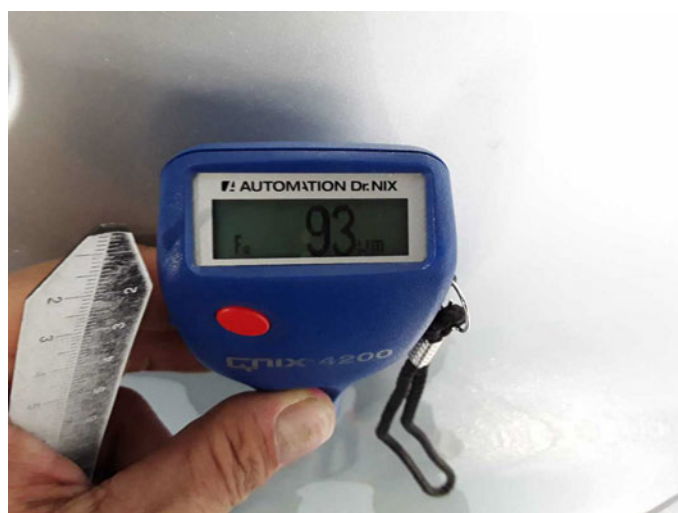
Kotflügel rechts: 93 \mu\text{m}
