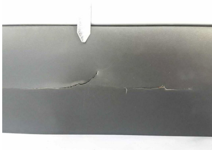
Beschädigung 24: Seitenwand links: Schutzleiste - beschädigt - erneuern
