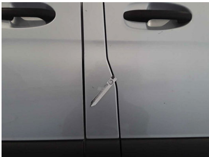
Beschädigung 17: Karosserie: B-Säule rechts - verkratzt / verschürft - lackieren
