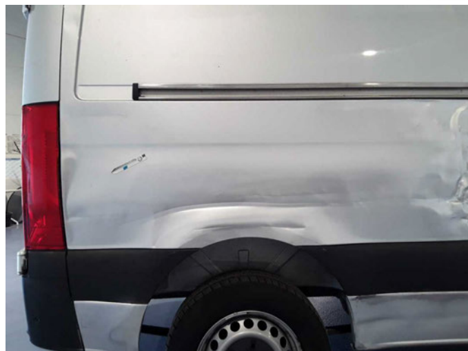
Beschädigung 12: Seitenwand rechts: Seitenwand - beschädigt - erneuern
