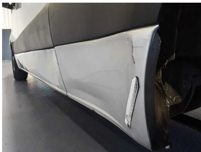
Beschädigung 25: Schweller links: Schweller - verformt - erneuern
