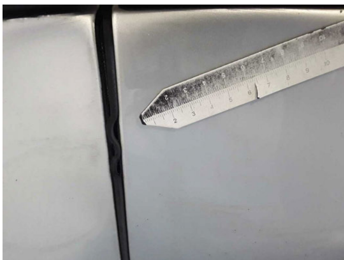
Beschädigung 25: Schweller links: Schweller - verformt - erneuern
