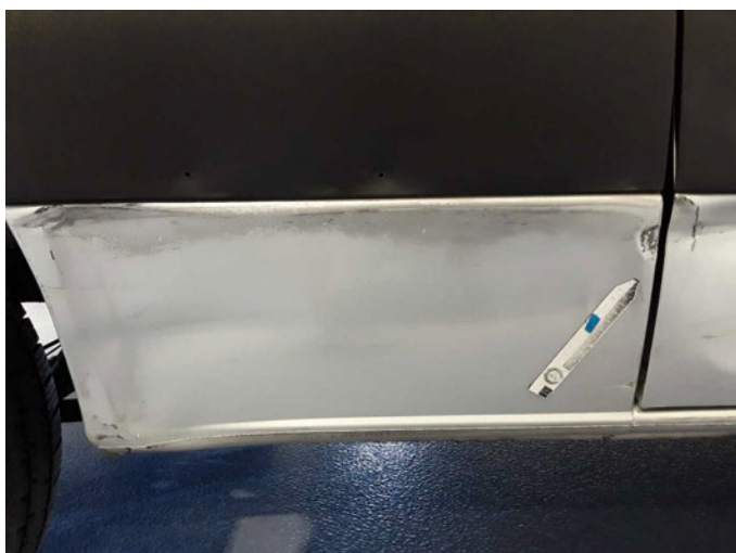
Beschädigung 13: Schweller rechts: Schweller - verformt - erneuern
