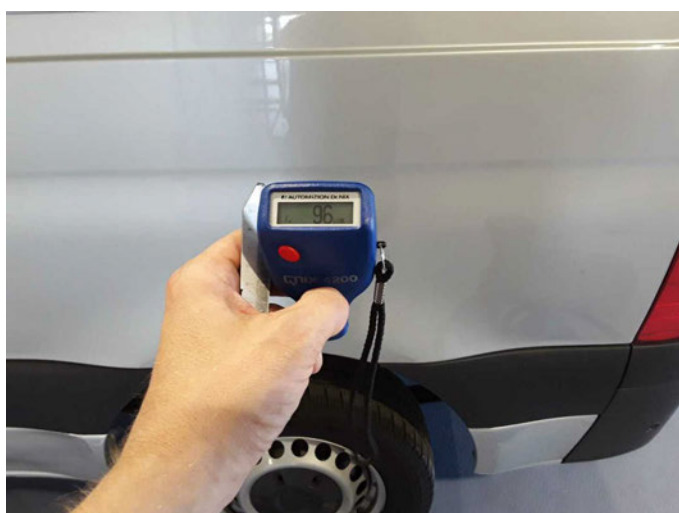
Seitenwand links: 96 \mu\text{m}
