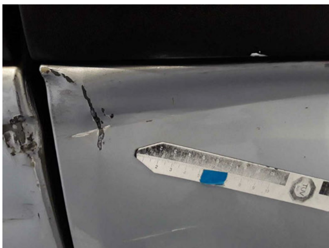
Beschädigung 15: Schiebetür rechts: Schiebetür - verformt - erneuern
