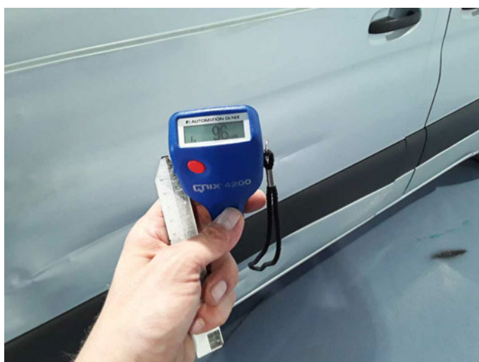
Tür hinten rechts: 96 µm
