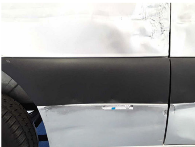
Beschädigung 11: Seitenwand rechts: Schutzleiste - beschädigt - erneuern
