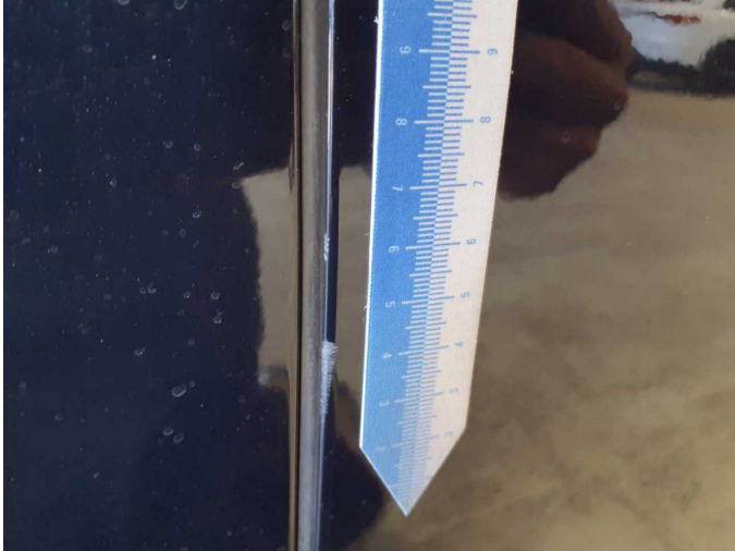
Damage 2: Door - front right side: Door edge - Scratch(es) - Smart repair
