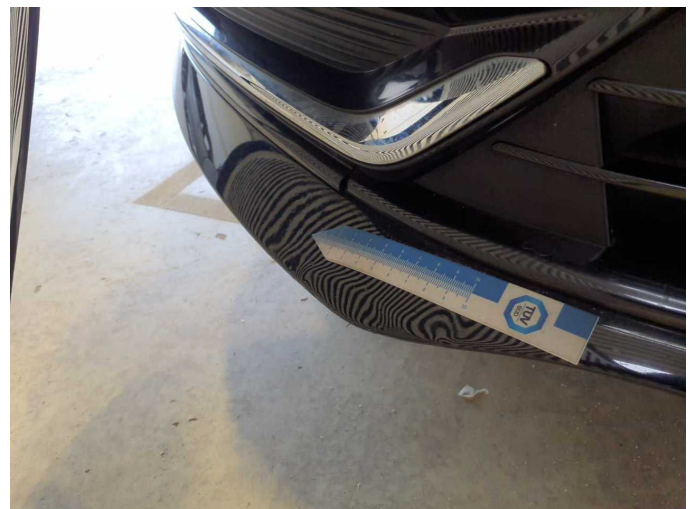
Damage 7: Front bumper: Spoiler (mit Zierleiste) - Deformed - Replace
