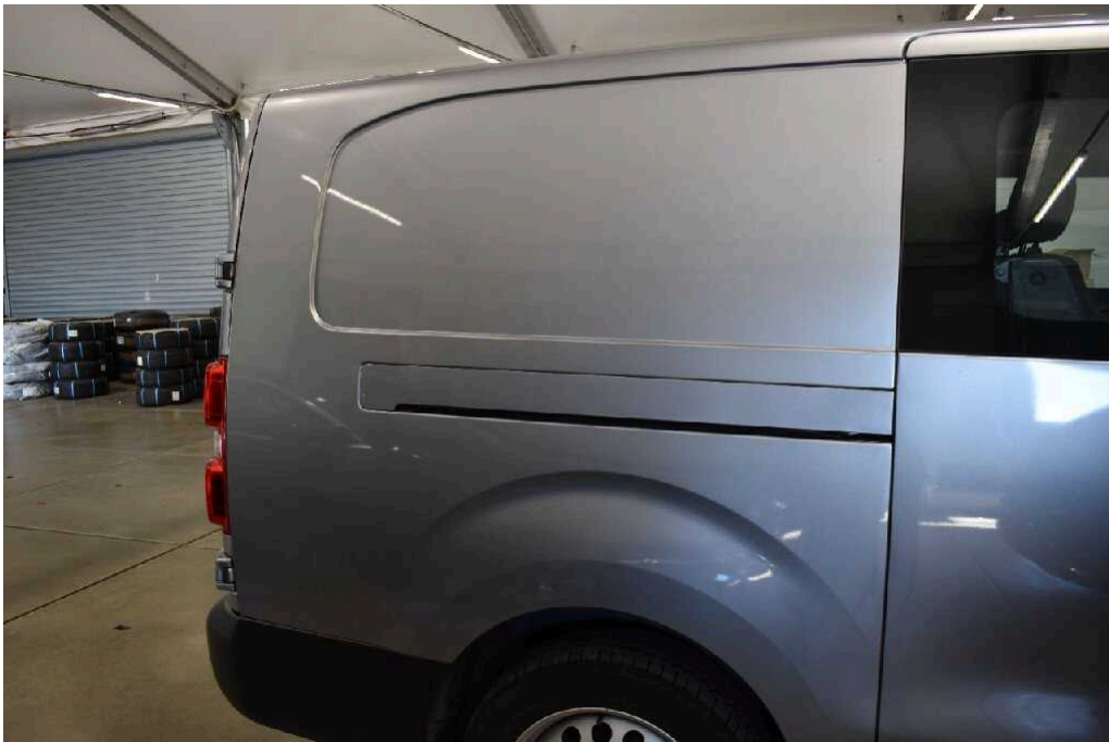
Bild 52 rechte Seite Seitenwand hinten rechts Dellen
