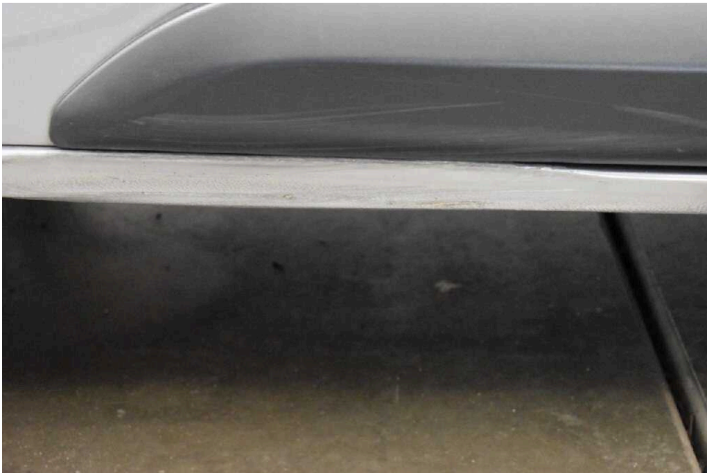
Bild 56 rechte Seite Schweller rechts eingedrückt
