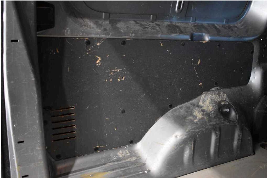
Bild 19 Innenraum div. Laderaumverkleidungen, gebrochen
