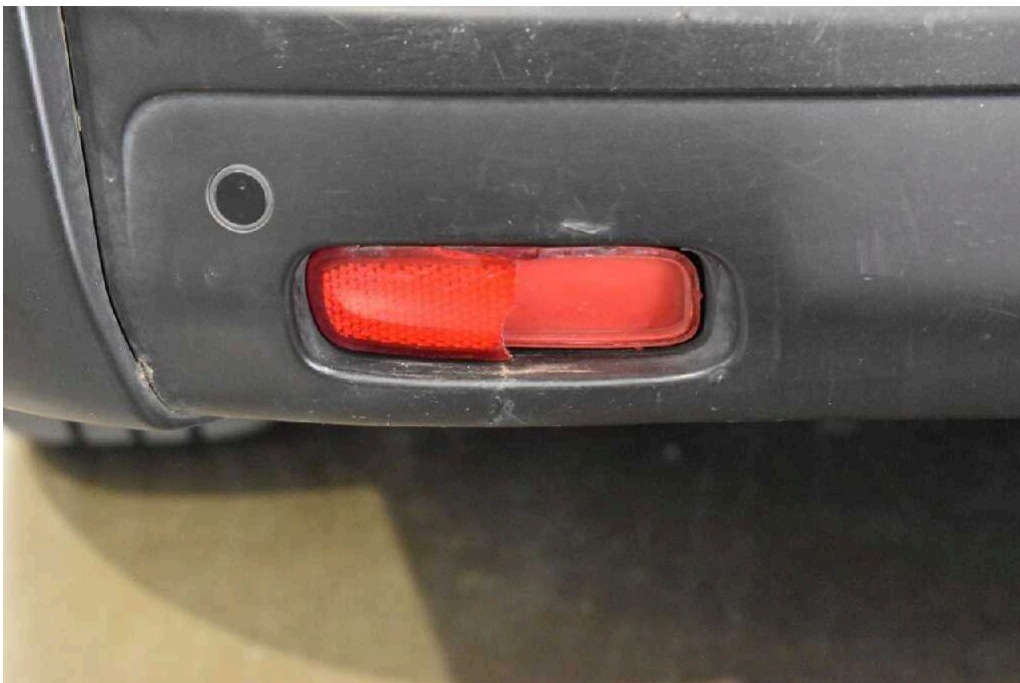
Bild 46 Fahrzeugheck Rückstrahler links gebrochen
