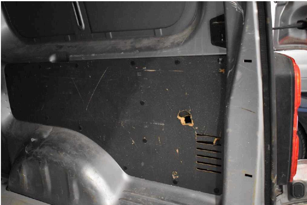
Bild 20 Innenraum div. Laderaumverkleidungen, gebrochen
