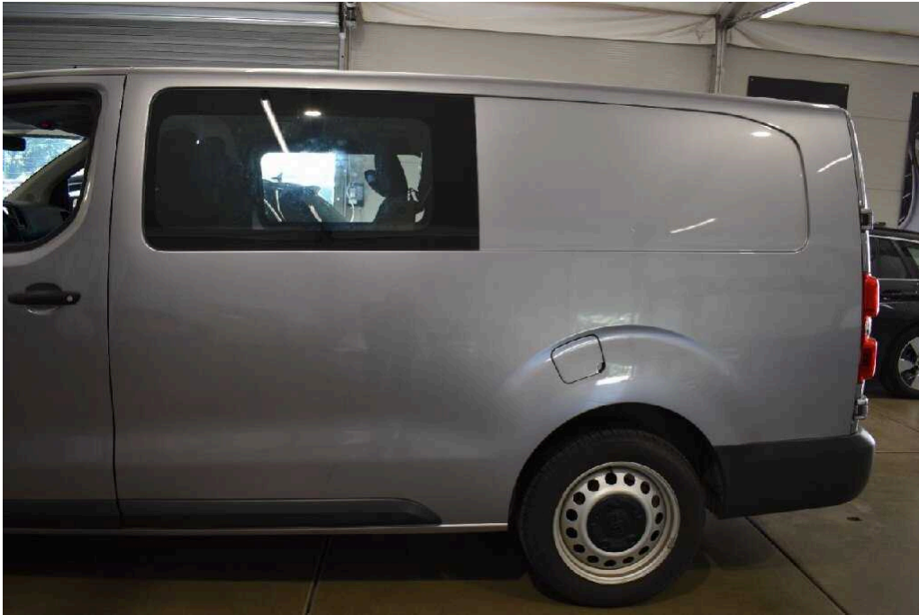
Bild 39 linke Seite Seitenwand links Kratzer/Dellen
