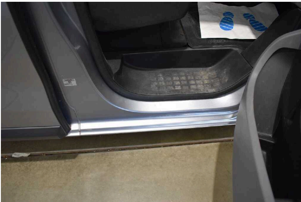
Bild 60 Innenraum Einstieg vorne rechts Dellen
