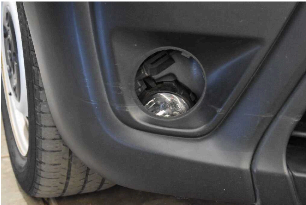
Bild 26 Fahrzeugfront Stoßfänger vorne deformiert, erneuern und lackieren, Nebelscheinwerfer rechts, beschädigt, erneuern
