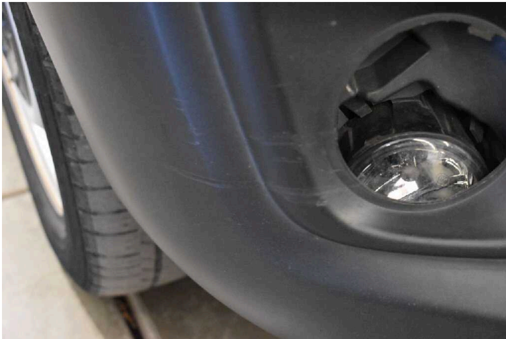
Bild 29 Fahrzeugfront Stoßfänger vorne deformiert, erneuern und lackieren, Nebelscheinwerfer rechts, beschädigt, erneuern
