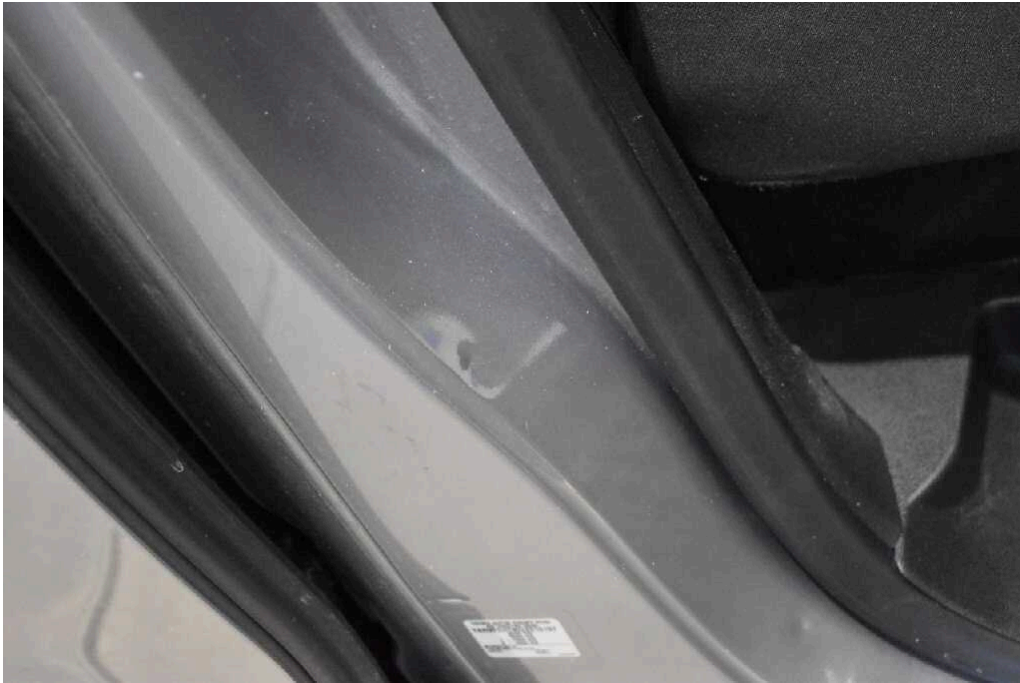
Bild 63 Innenraum Einstieg vorne rechts Dellen
