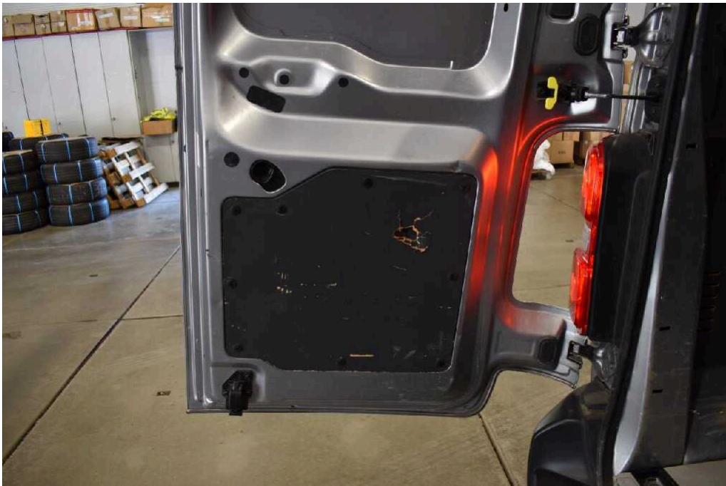
Bild 23 Innenraum Heckflügeltürverkleidung links gebrochen
