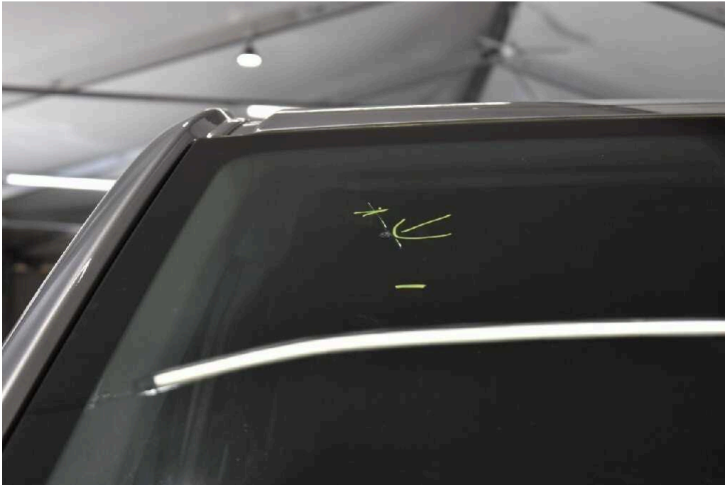
Bild 65 Fahrzeugfront Frontscheibe gerissen / eingerissen
