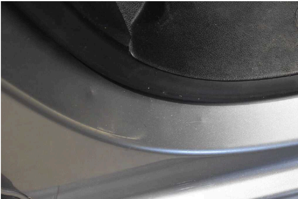
Bild 62 Innenraum Einstieg vorne rechts Dellen
