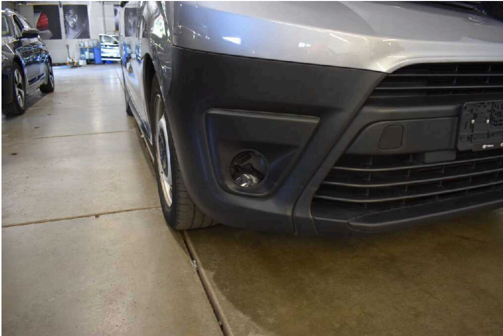
Bild 25 Fahrzeugfront Stoßfänger vorne deformiert, erneuern und lackieren, Nebelscheinwerfer rechts, beschädigt, erneuern
