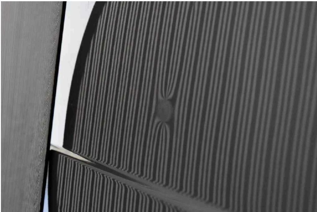
Bild 42 linke Seite Seitenwand links Kratzer/Dellen
