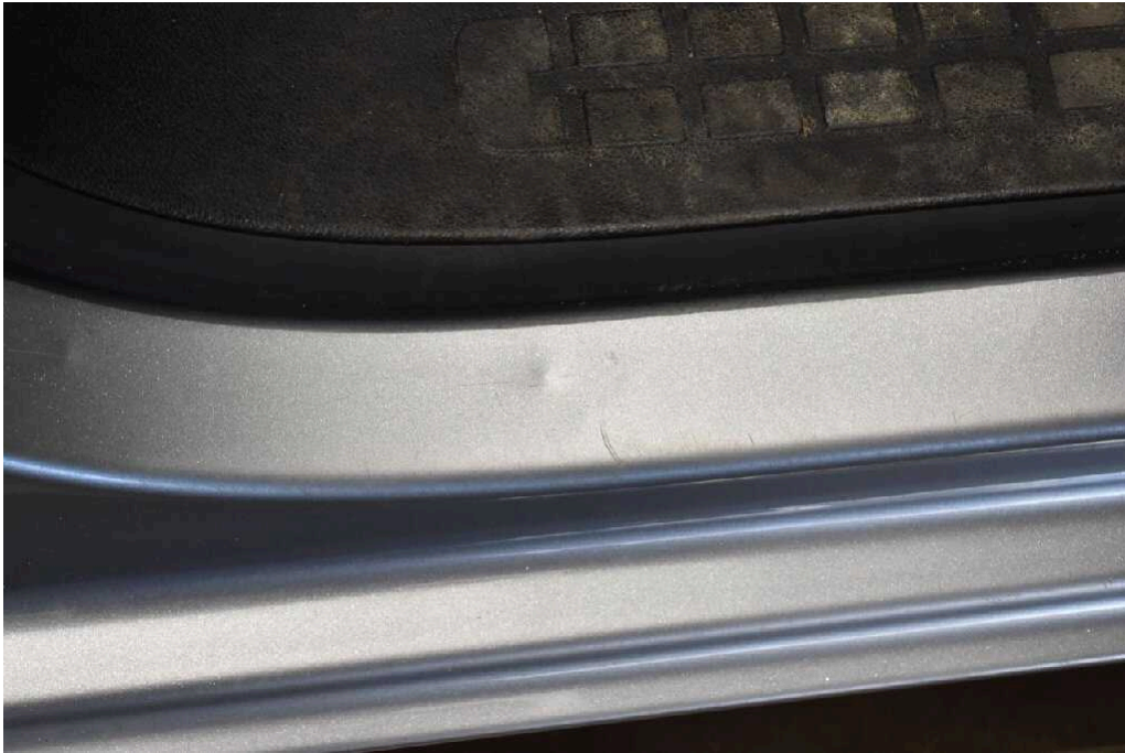
Bild 61 Innenraum Einstieg vorne rechts Dellen
