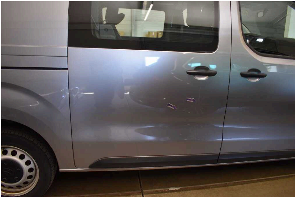
Bild 57 rechte Seite Schiebetür rechts Kratzer
