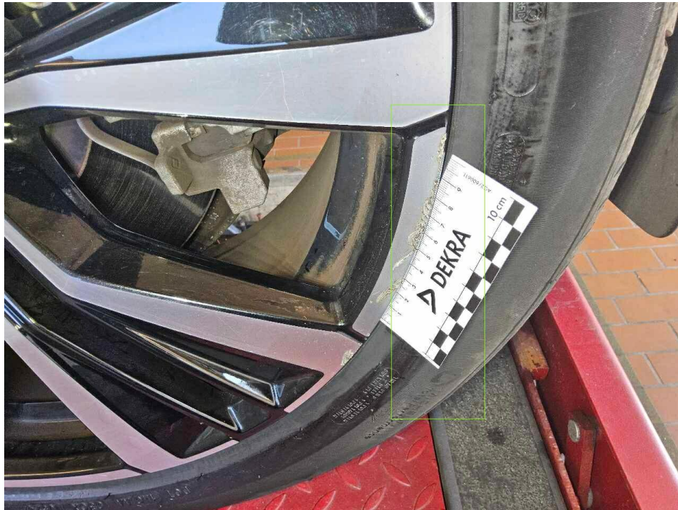
Bild 21 : Glanzgedreht Felge vorne rechts verkratzt
