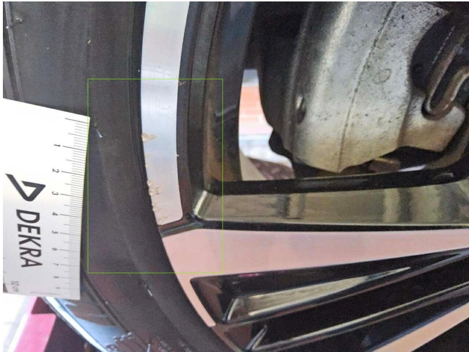
Bild 19 : Glanzgedreht Felge vorne links verkratzt
