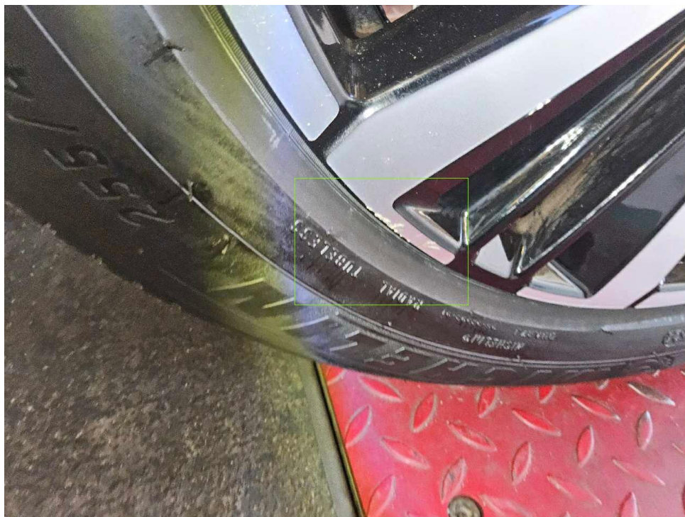
Bild 23 : Glanzgedreht Felge vorne rechts verkratzt
