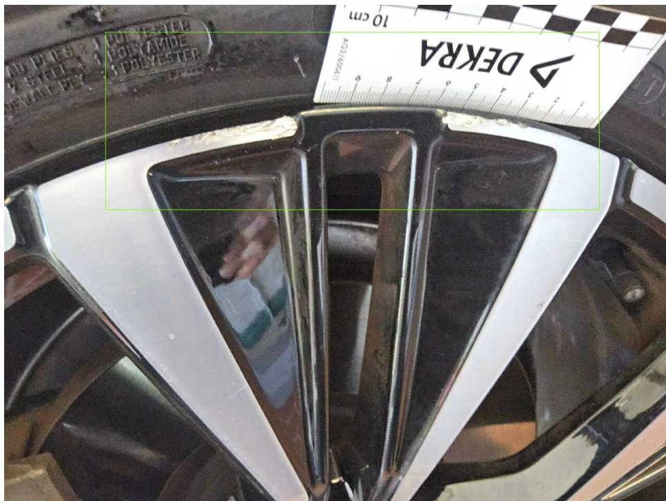
Bild 18 : Glanzgedreht Felge vorne links verkratzt
