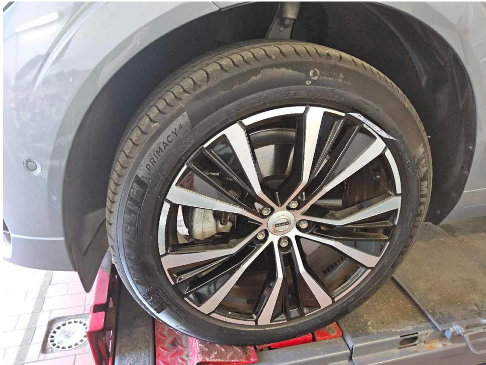
Bild 17 : Glanzgedreht Felge vorne links verkratzt
