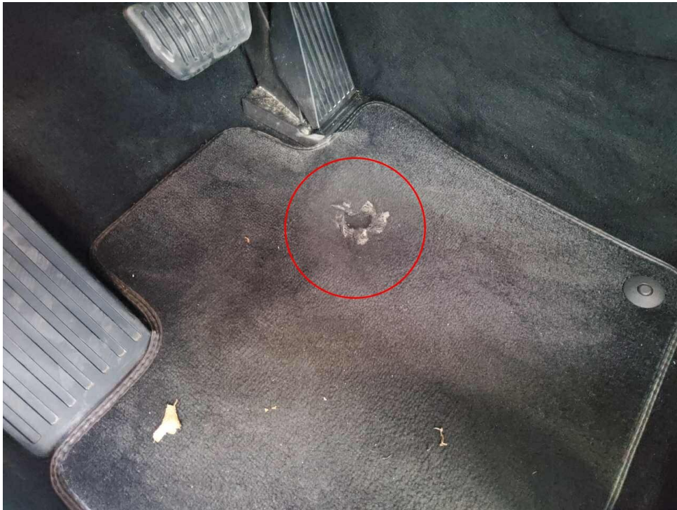
Bild 27 : Fussmatte V.L. eingerissen
