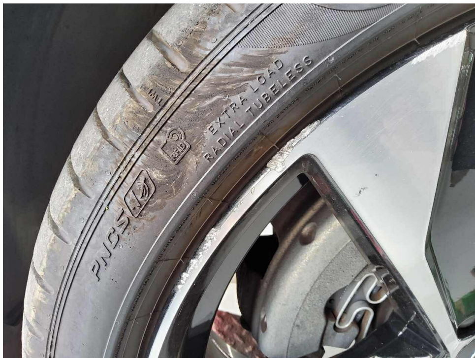
Bild 32 : Glanzgedrehte Alufelge V.L. verschrammt
