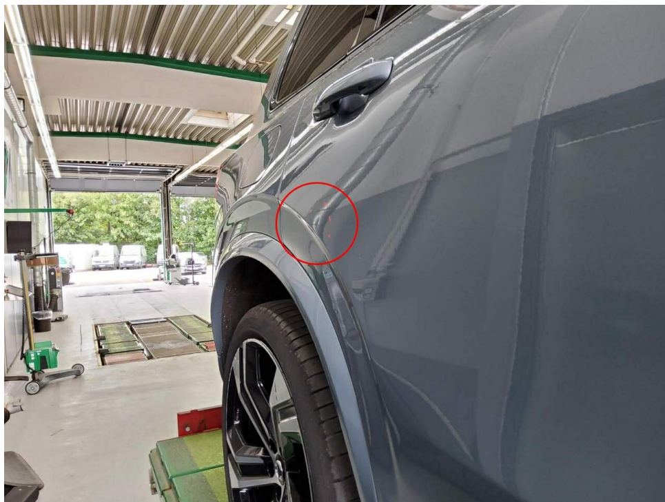
Bild 19 : Tür hinten rechts, eingedellt, Gebrauchsspur
