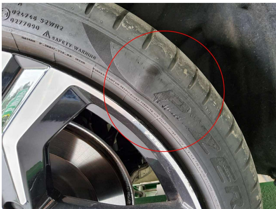
Bild 50 : Flankenschaden Reifen hinten links
