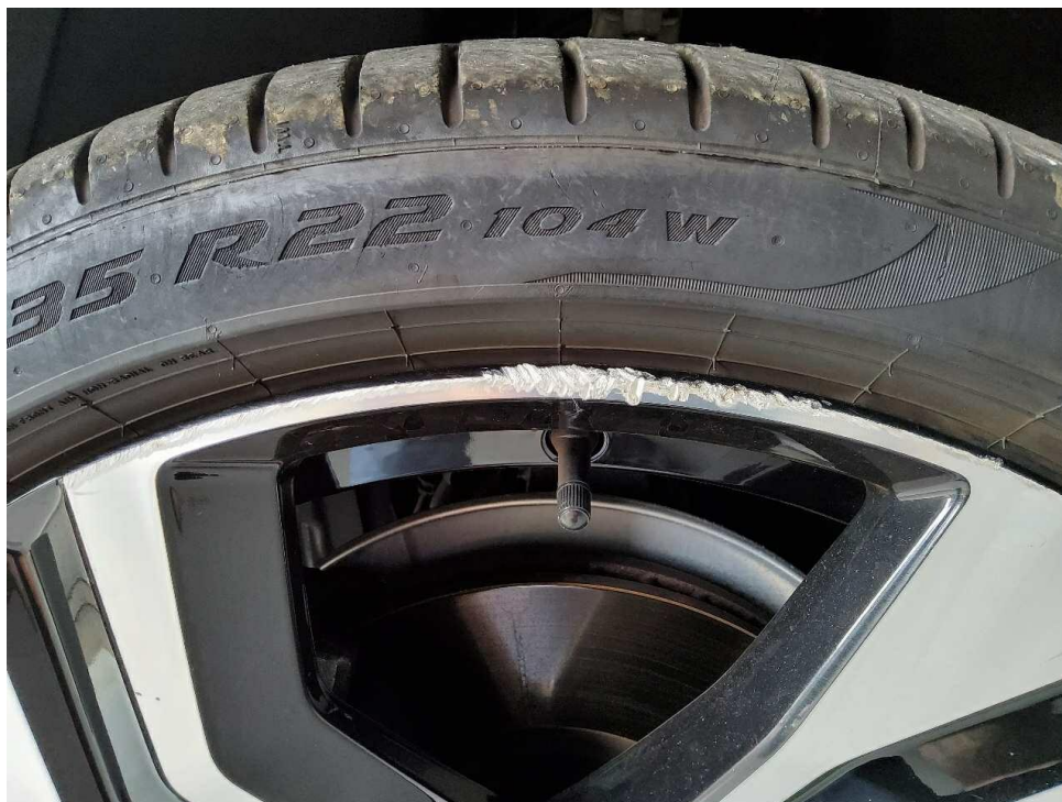
Bild 31 : Glanzgedrehte Alufelge V.L. verschrammt
