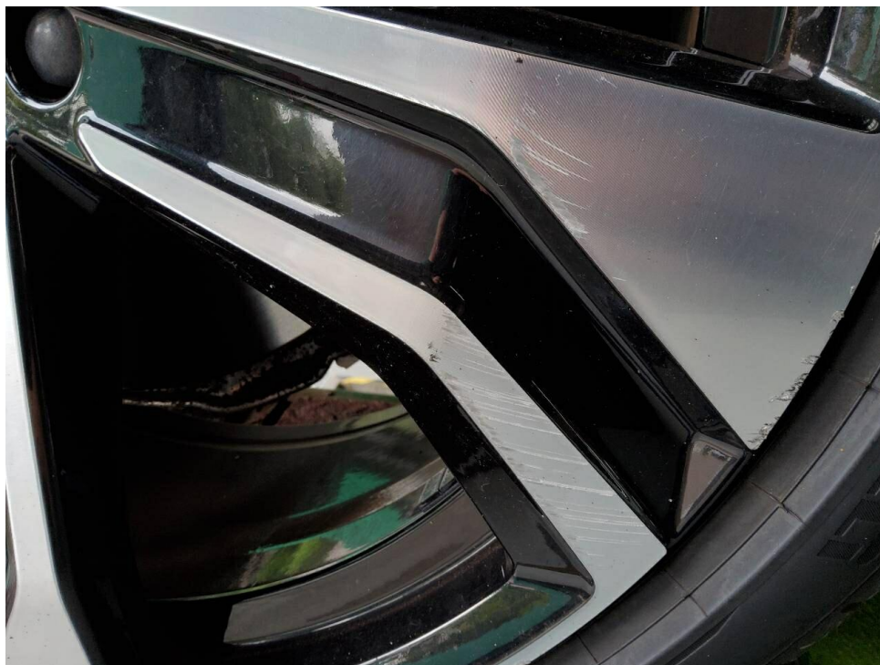
Bild 33 : Glanzgedrehte Alufelge V.L. verschrammt
