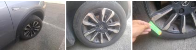
Alloy rim FR bitone/polychrome, Scratch(es), Repair/replace (lump sum)
