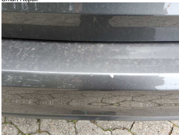
Beschädigung #4: Stossfänger hinten: Stossfänger hinten - Kratzer - lackieren
