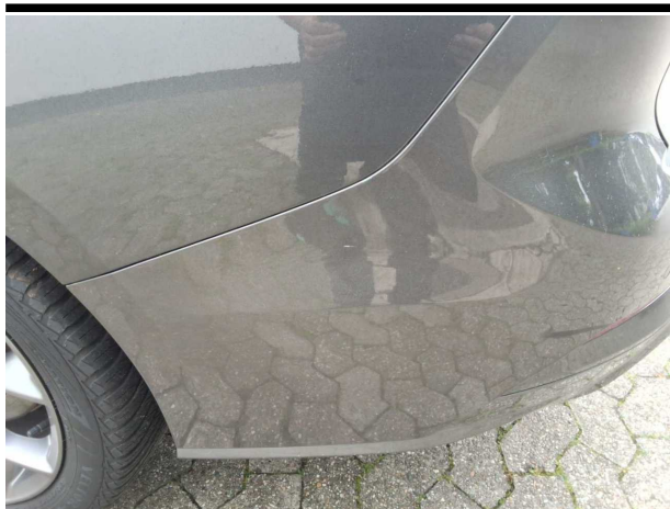
Beschädigung #4: Stossfänger hinten: Stossfänger hinten - Kratzer - lackieren
