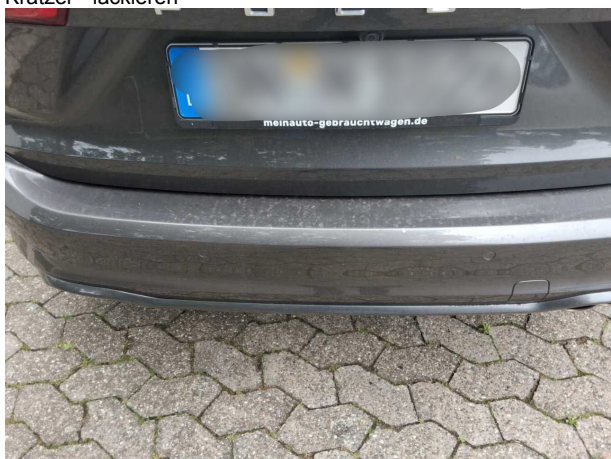
Beschädigung #4: Stossfänger hinten: Stossfänger hinten - Kratzer - lackieren
