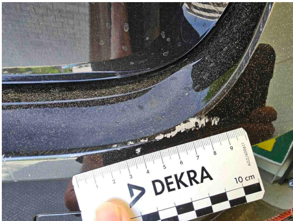
Bild 22 : Stoßfänger hinten zerkratzt und deformiert
