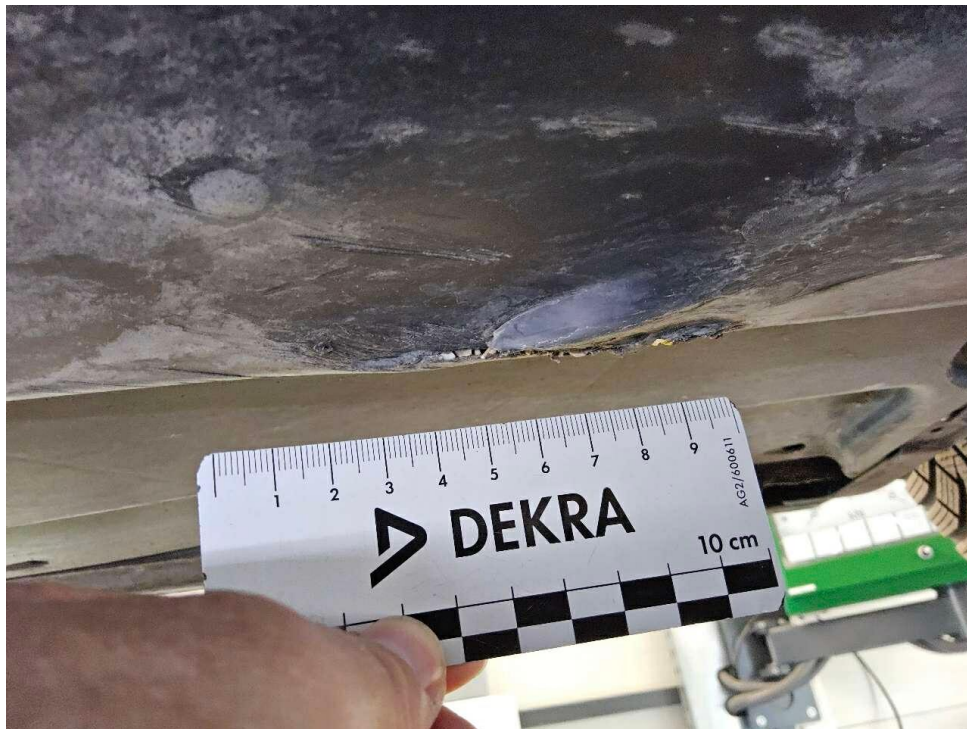
Bild 26 : Unterbodenverkleidung links gebrochen
