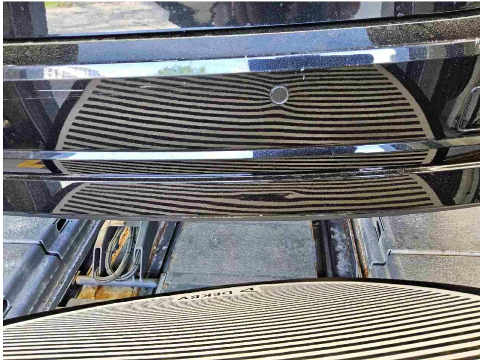
Bild 24 : Stoßfänger hinten zerkratzt und deformiert
