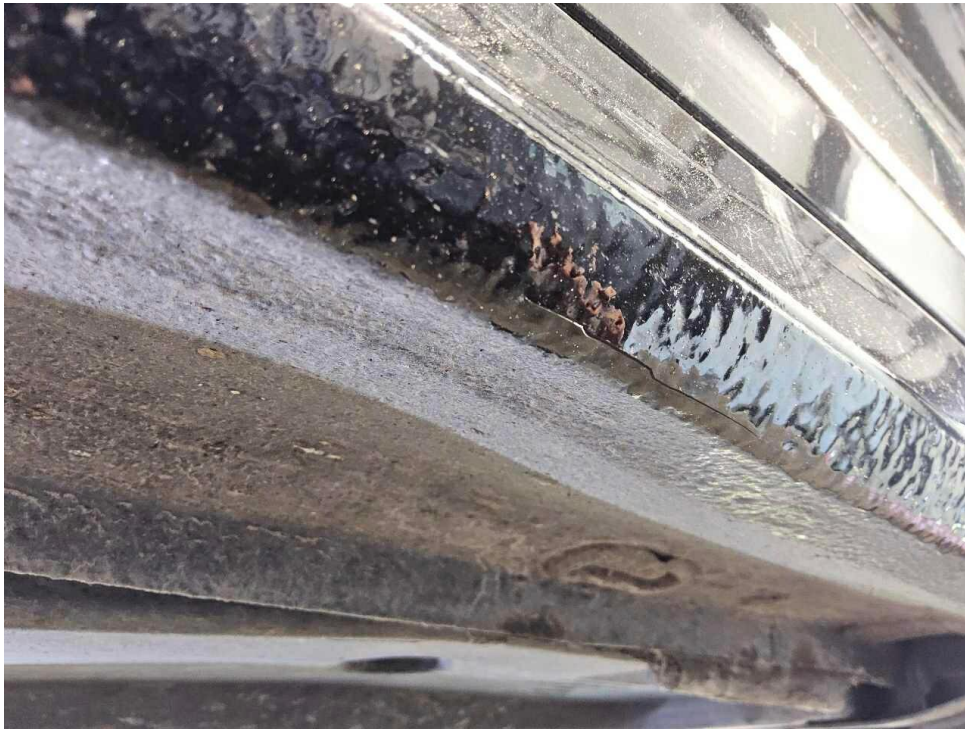
Bild 31 : Schweller rechts deformiert
