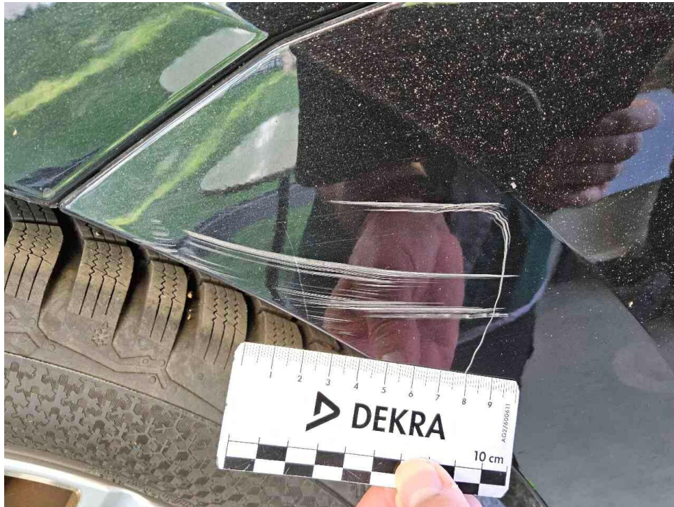
Bild 20 : Stoßfänger hinten zerkratzt und deformiert
