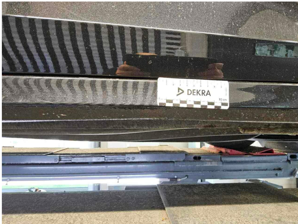
Bild 29 : Schweller rechts deformiert
