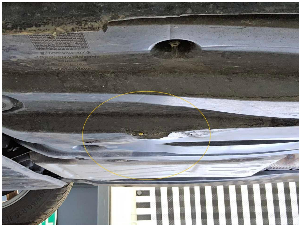
Bild 27 : Unterbodenverkleidung links gebrochen
