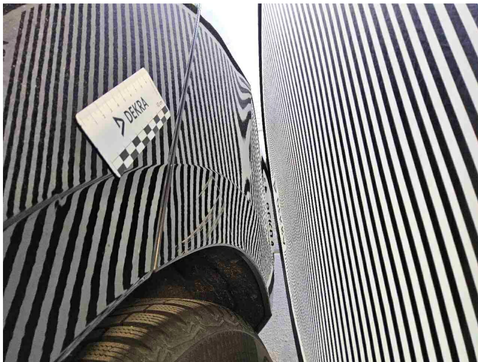
Bild 21 : Stoßfänger hinten zerkratzt und deformiert
