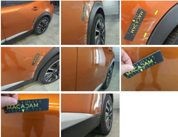
Door trim RL, Scratch(es), Replace
