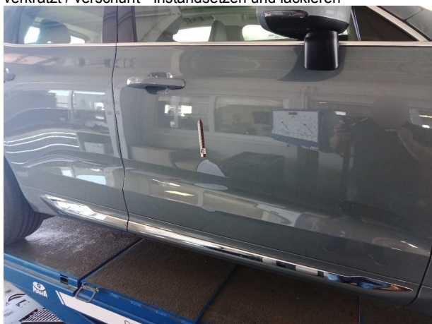
Beschädigung #6: Tür vorn rechts: Tür - verkratzt / verschürft - lackieren
