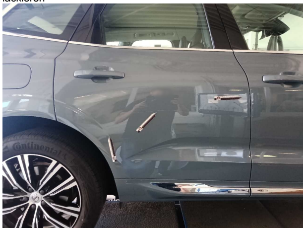
Beschädigung #5: Tür hinten rechts: Tür (Zusätzlich eine Delle) - verkratzt / verschürft - instandsetzen und lackieren
