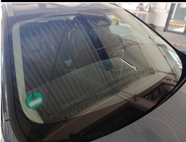
Beschädigung #7: Verglasung: Frontscheibe - Steinschlag - erneuern
