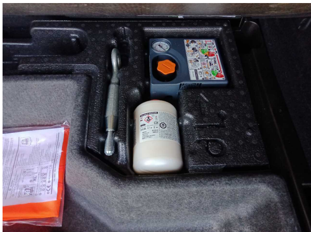
Beschädigung #1: Ausrüstung: Tirefit Füllmittel - abgelaufen - erneuern
