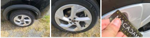
Alloy rim FR, Scratch(es), Repair/replace (lump sum)
