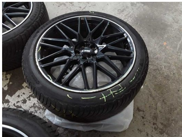
Beschädigung #1: 2.Radsatz: 1 Reifen - Abrieb
