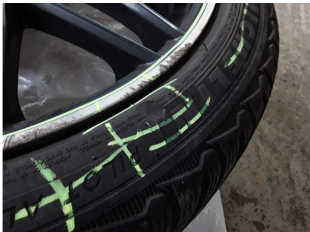
Beschädigung #1: 2.Radsatz: 1 Reifen - Abrieb
