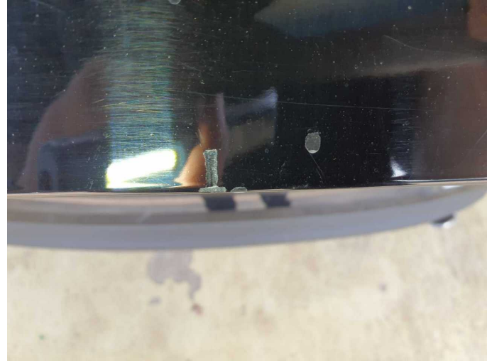
Damage 13: Boot lid / rear door: Boot lid - Scratch(es) - Paint
