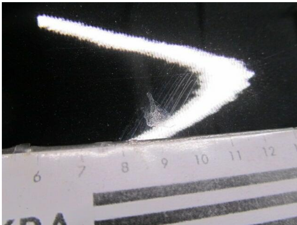
Bild 18 : Seitenteil hinten rechts Lackierung, fleckig, reinigen
