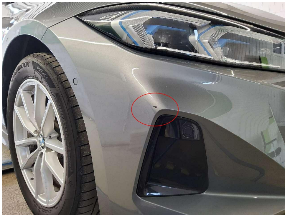
Bild 16 : Stoßfänger vorne, Lackierung, verschrammt
