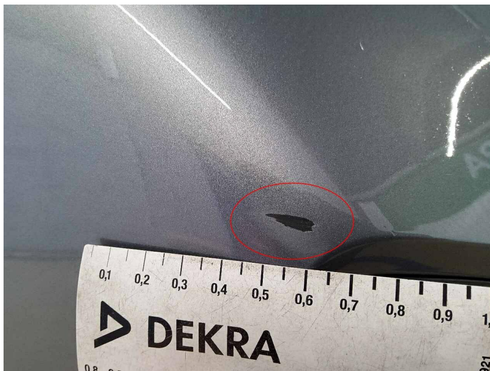
Bild 17 : Stoßfänger vorne, Lackierung, verschrammt
