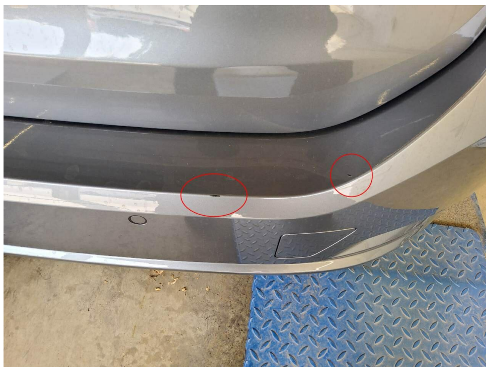
Bild 18 : Stoßfänger hinten, Lackierung, verschrammt
