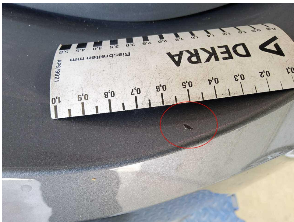
Bild 20 : Stoßfänger hinten, Lackierung, verschrammt
