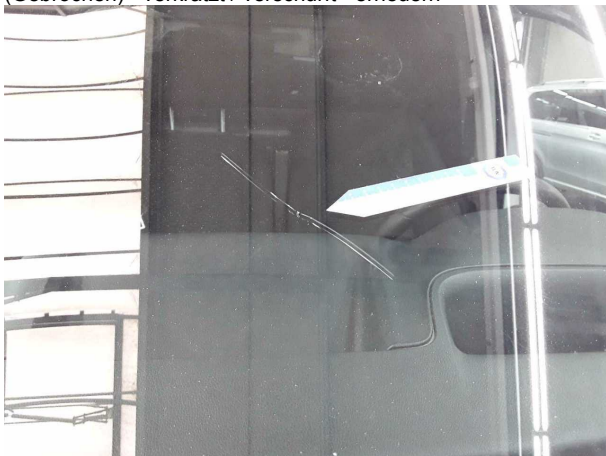
Beschädigung #22: Verglasung: Frontscheibe mit Spurhalteassistent (Mehrkosten können entstehen) - gebrochen / gerissen - erneuern
