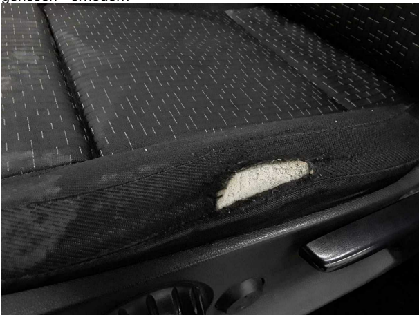
Beschädigung #12: Sitz vorn: Sitzpolster links - verschlissen - erneuern
