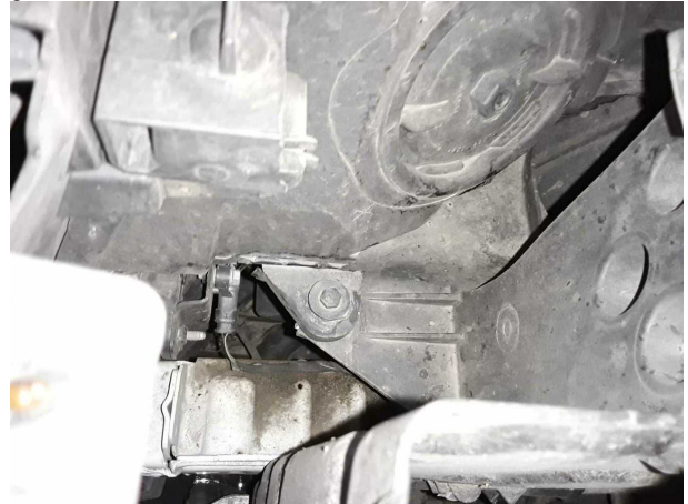
Beschädigung #16: Scheinwerfer: Scheinwerfer rechts (Mehrkosten können entstehen) - gebrochen / gerissen - erneuern
