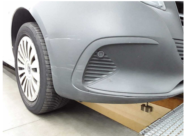
Beschädigung #21: Stossfänger vorn: Stossfänger mit Parktronic (Gebrochen) - verkratzt / verschürft - erneuern
