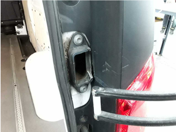
Beschädigung #7: Sonstiges: Sonstiges (Halter , Mehrkosten können entstehen) - gebrochen / gerissen - erneuern
