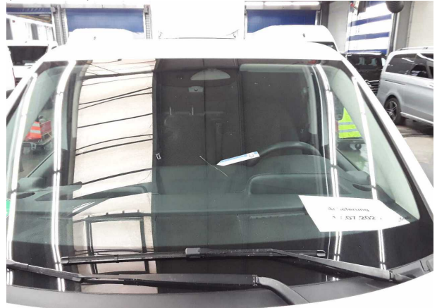
Beschädigung #22: Verglasung: Frontscheibe mit Spurhalteassistent (Mehrkosten können entstehen) - gebrochen /
