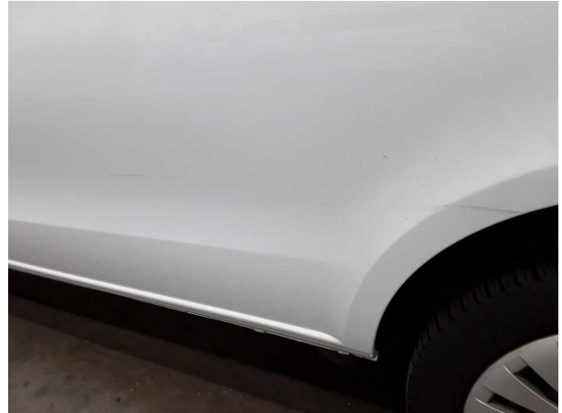
Beschädigung #8: Seitenwand links: Seitenwand - verkratzt / verschürft - auslegen / polieren
