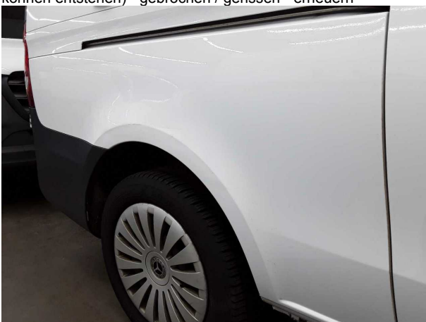
Beschädigung #17: Seitenwand rechts: Seitenwand - Delle / Lackschaden - instandsetzen und lackieren
