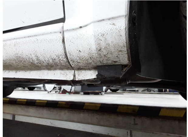
Beschädigung #11: Schweller rechts: Schweller (Kotflügel, Mehrkosten können entstehen) - verformt - instandsetzen und
