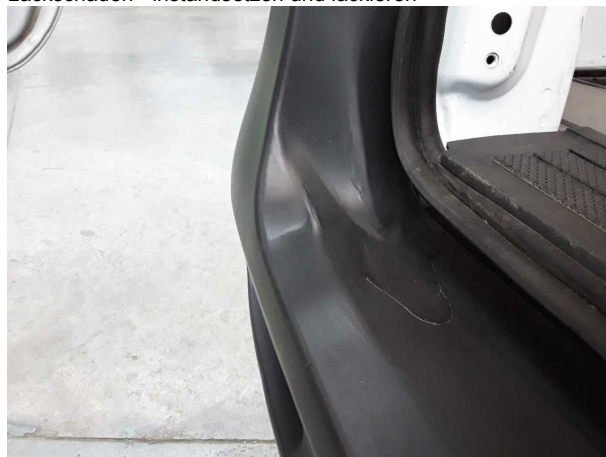
Beschädigung #19: Stossfänger hinten: Stossfänger hinten (Mehrkosten können entstehen) - verformt - erneuern
