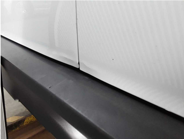
Beschädigung #14: Heckklappe/-tür: Hecktür rechts - Delle / Lackschaden - instandsetzen und lackieren
