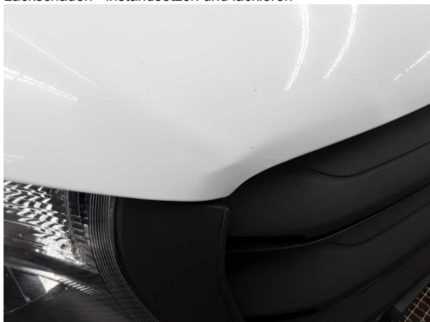
Beschädigung #18: Motorhaube: Motorhaube - Delle / Lackschaden - instandsetzen und lackieren
