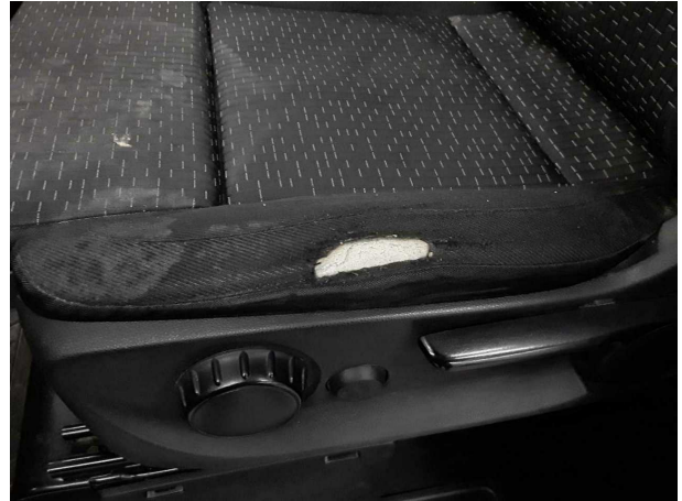
Beschädigung #15: Sitz vorn: Sitzbezug links - gebrochen / gerissen - erneuern
