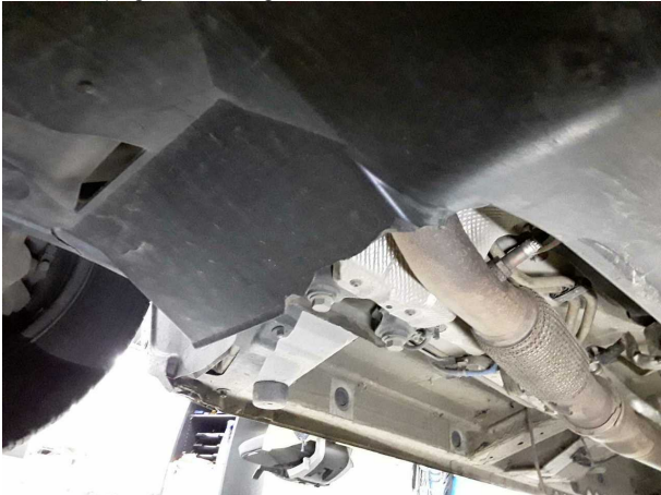
Beschädigung #10: Motor: Motorverkleidung unten - gebrochen / gerissen - erneuern
