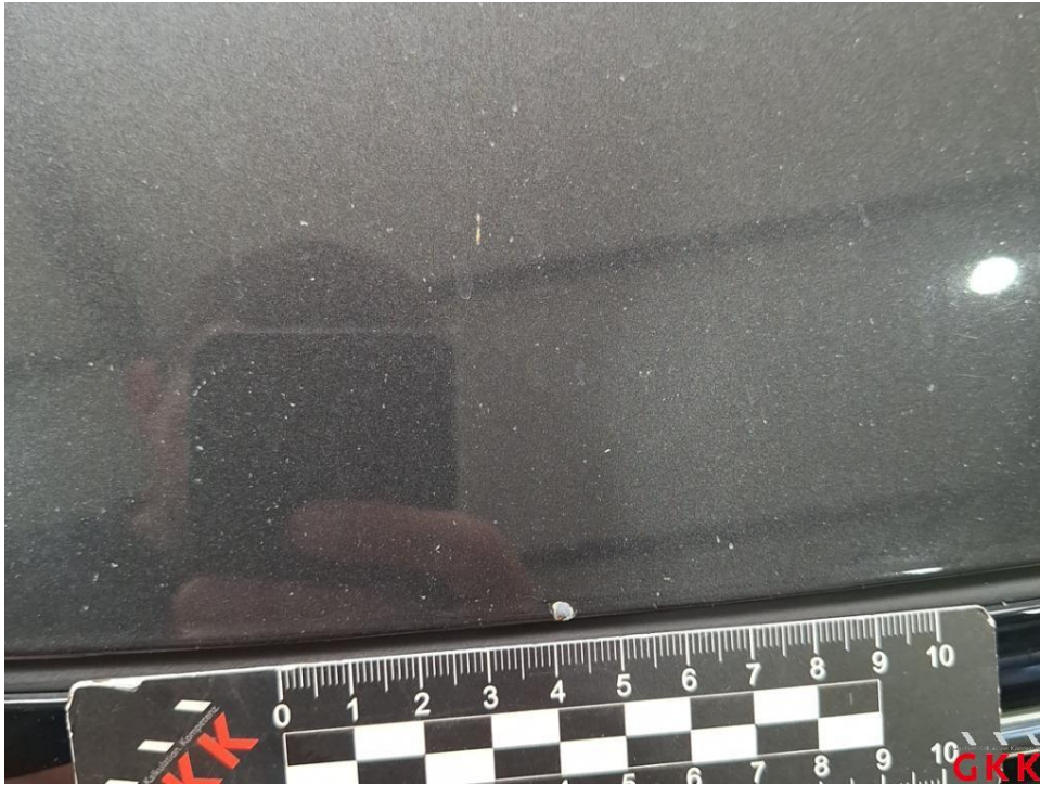
Bild 15. Motorhaube, Steinschlag, lackieren
