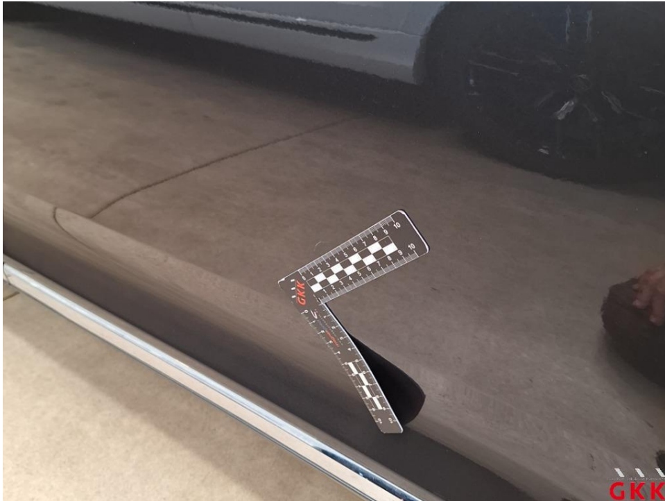
Bild 23. Tür hinten links, verkratzt, auslegen, schleifen, polieren
