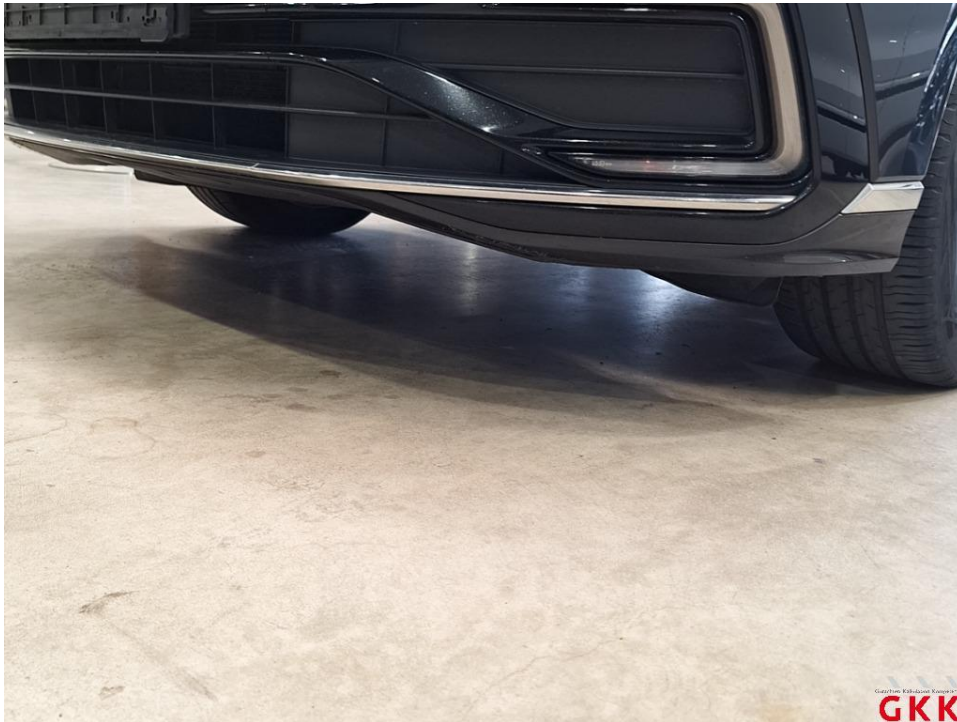
Bild 20. Stoßfänger vorne, Spoiler -lackiert-, verkratzt, lackieren
