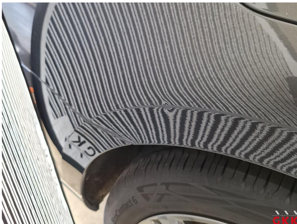
Bild 36. Seitenwand rechts, bis 3 Dellen / Bauteil, kalt drücken
