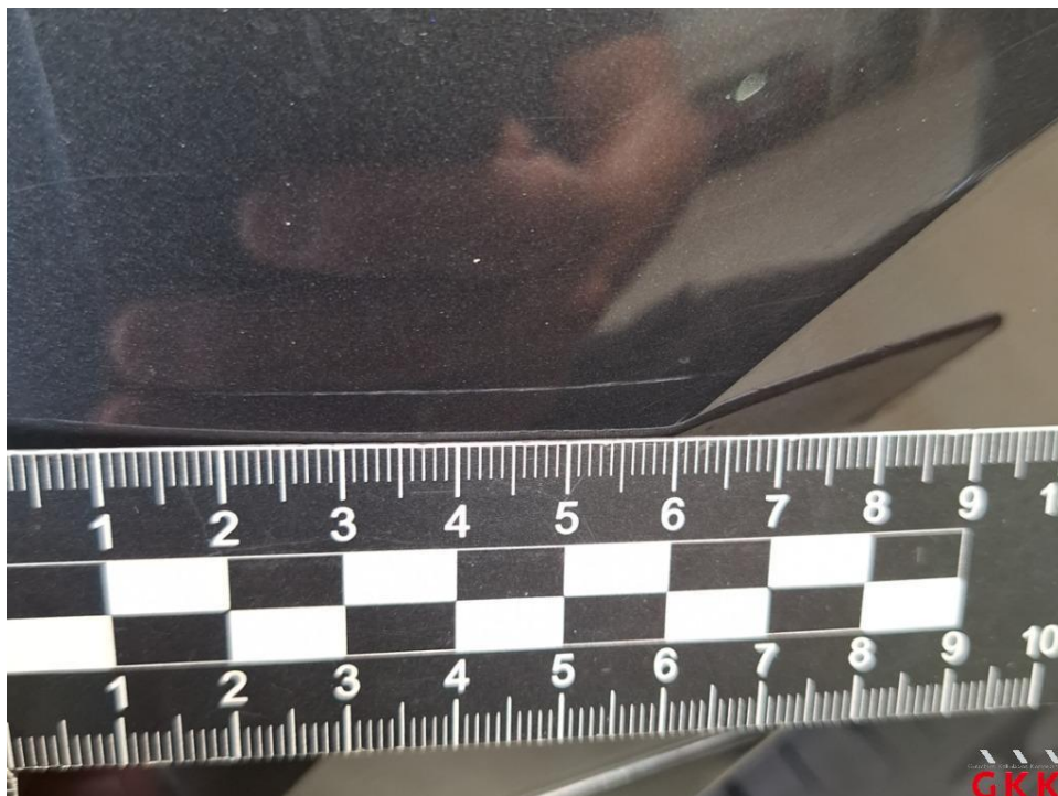
Bild 35. Seitenwand rechts, bis 3 Dellen / Bauteil, kalt drücken
