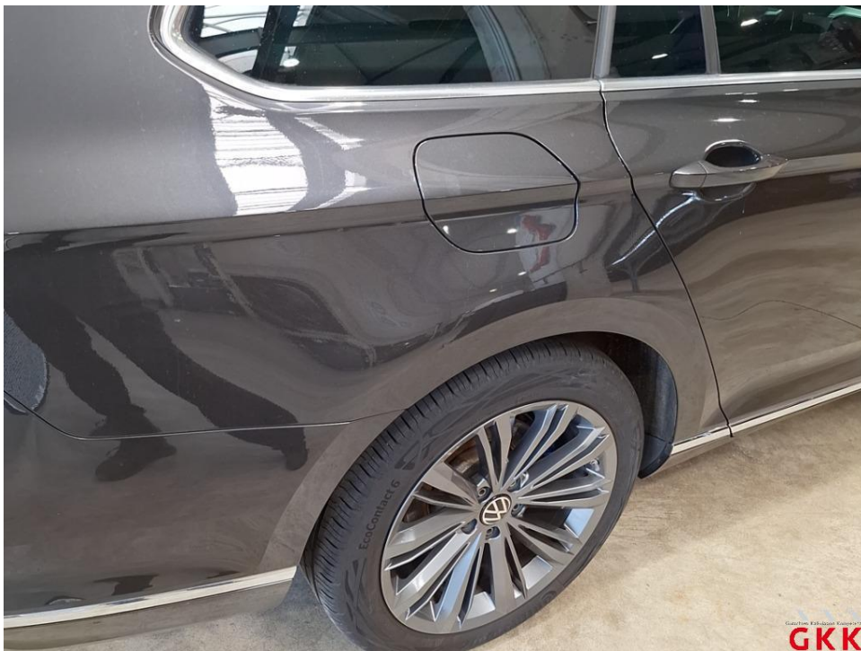
Bild 34. Seitenwand rechts, bis 3 Dellen / Bauteil, kalt drücken
