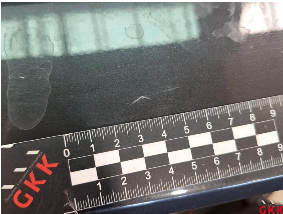
Bild 28. Stoßfänger hinten, Verkleidung -lackiert-, verkratzt, Smartrepair
