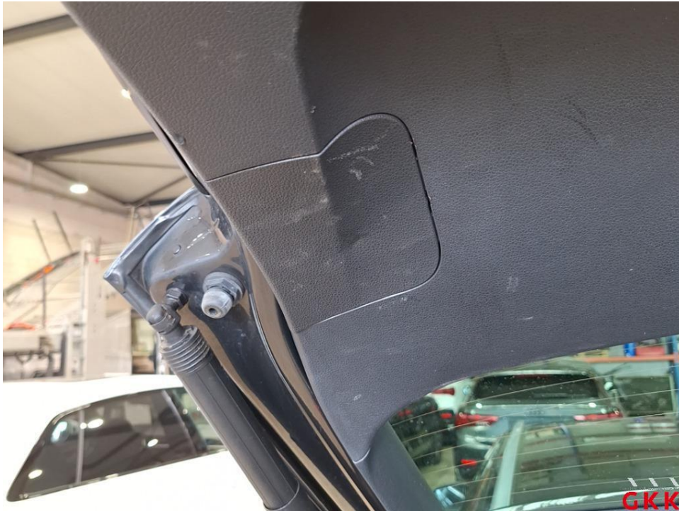
Bild 31. Heckklappe, Innenverkleidung, verkratzt, ersetzen
