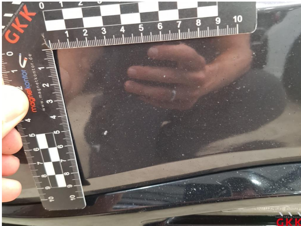
Bild 17. Stoßfänger vorne, Verkleidung -lackiert-, Steinschlag, lackieren
