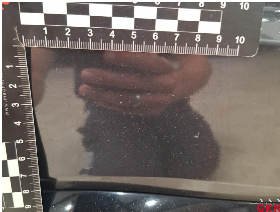
Bild 18. Stoßfänger vorne, Verkleidung -lackiert-, Steinschlag, lackieren
