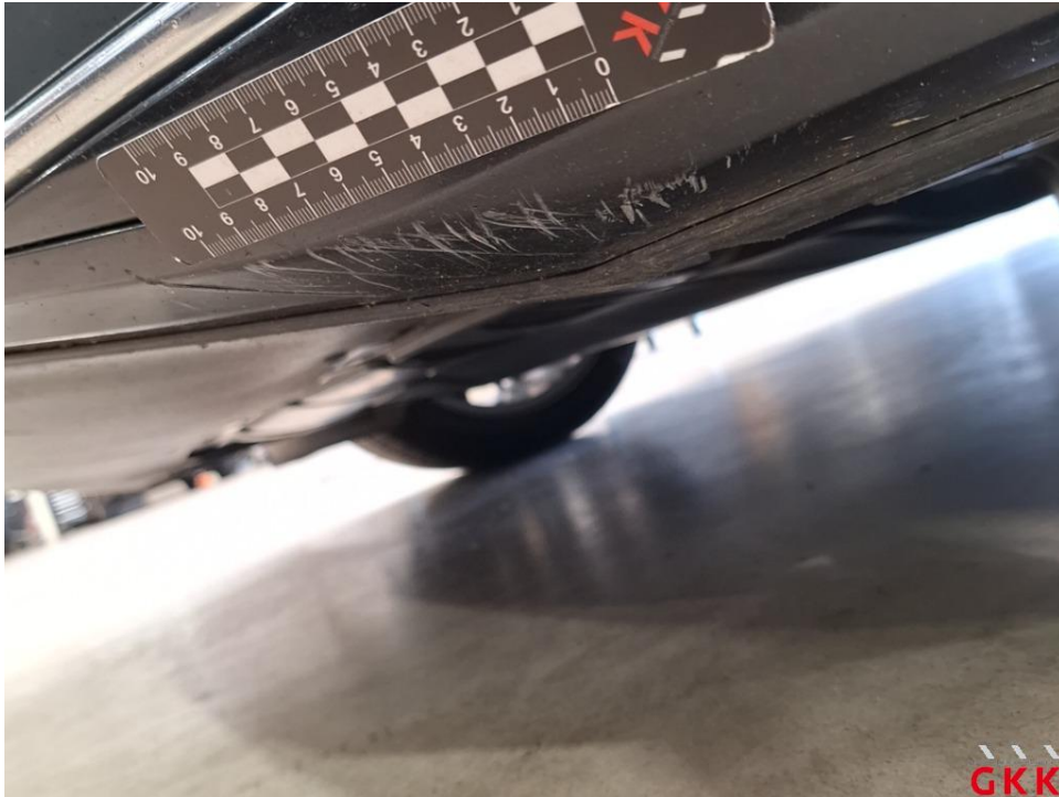
Bild 21. Stoßfänger vorne, Spoiler -lackiert-, verkratzt, lackieren
