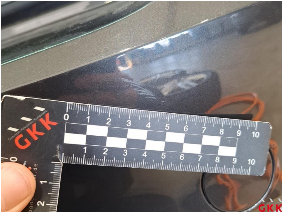
Bild 30. Stoßfänger hinten, Verkleidung -lackiert-, verkratzt, Smartrepair
