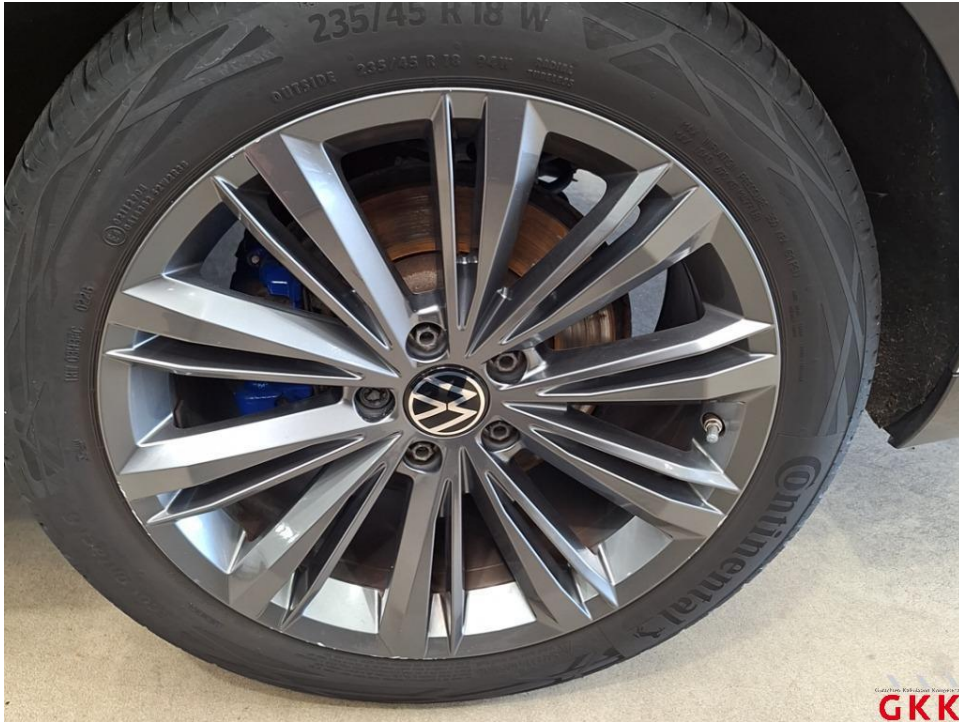
Bild 25. LM-Rad, hinten links, verkratzt, lackieren
