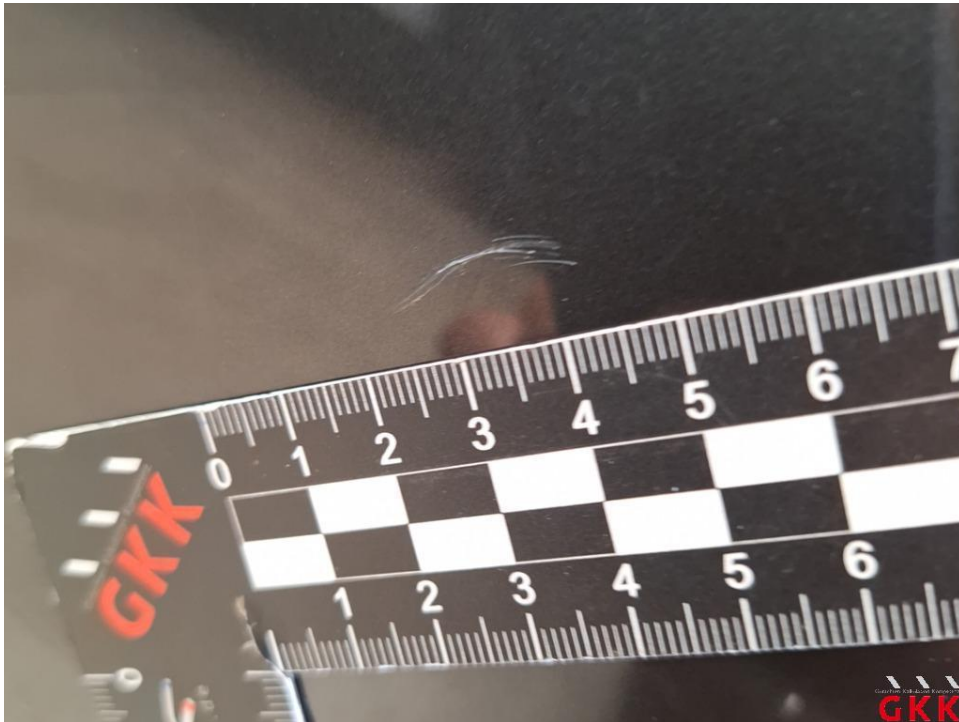
Bild 24. Tür hinten links, verkratzt, auslegen, schleifen, polieren
