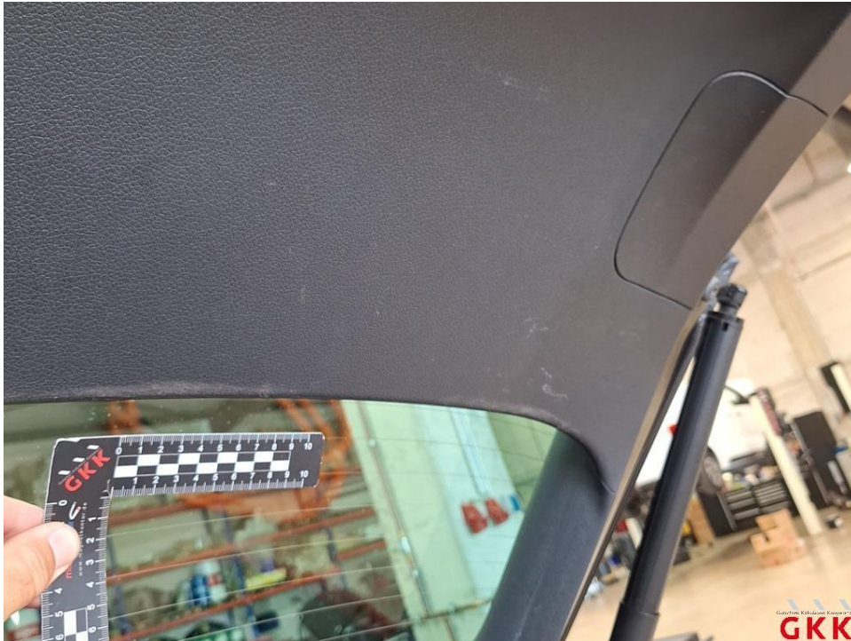
Bild 33. Heckklappe, Innenverkleidung, verkratzt, ersetzen
