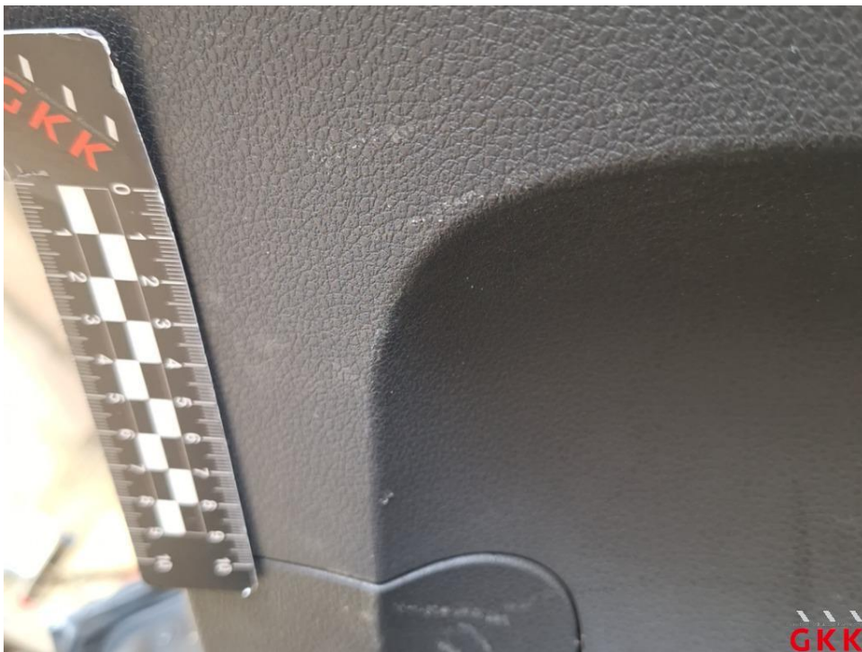
Bild 32. Heckklappe, Innenverkleidung, verkratzt, ersetzen
