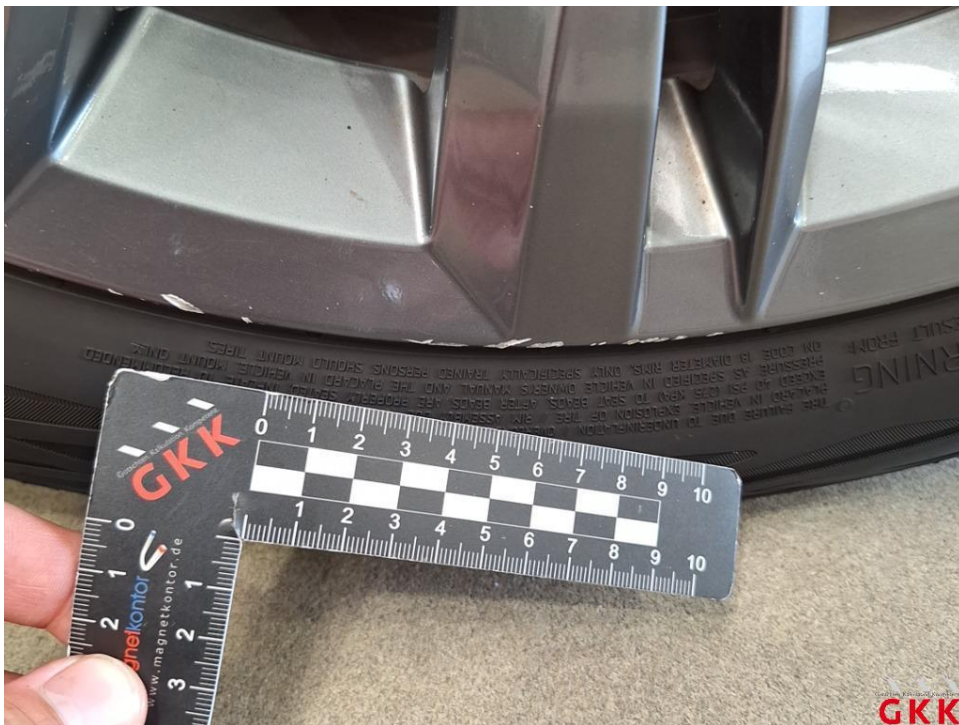
Bild 26. LM-Rad, hinten links, verkratzt, lackieren
