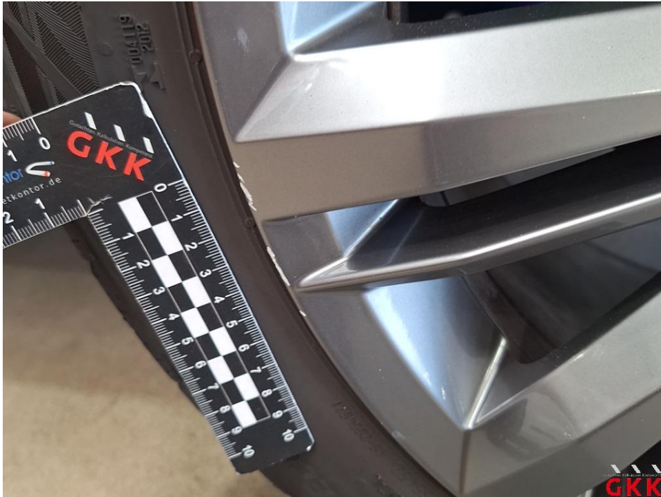
Bild 27. LM-Rad, hinten links, verkratzt, lackieren
