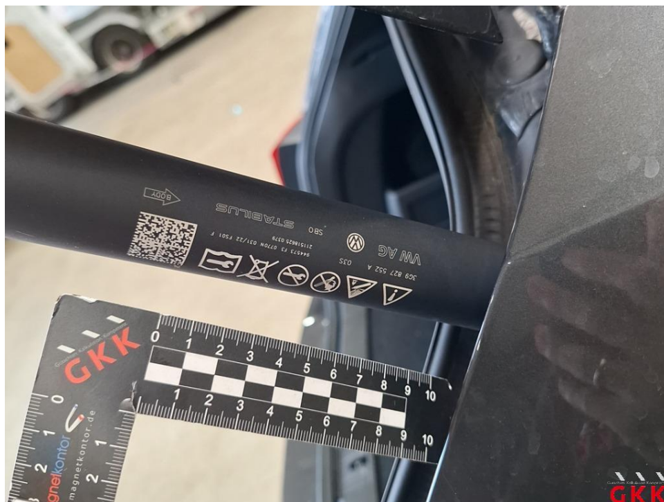
Bild 12. Heckklappe elektrisch, untypische Geräusche, prüfen
