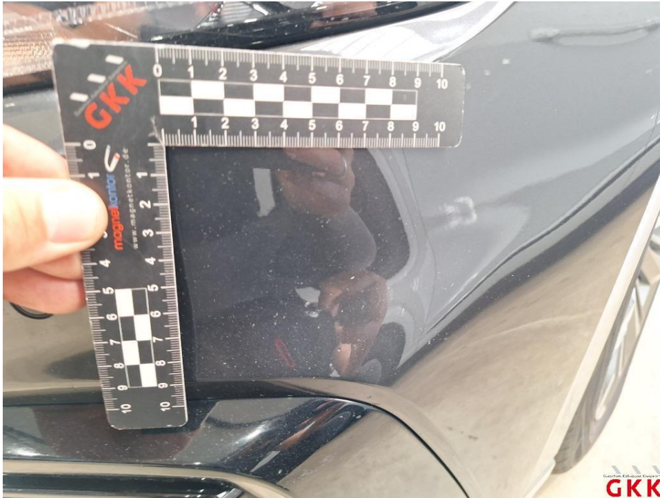
Bild 19. Stoßfänger vorne, Verkleidung -lackiert-, Steinschlag, lackieren
