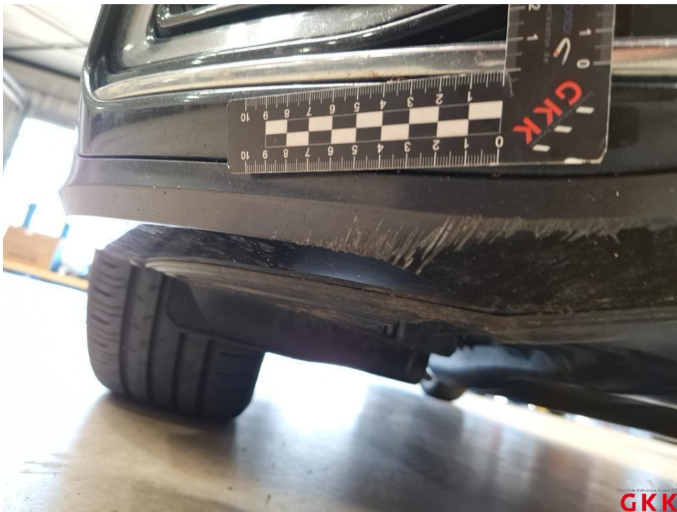
Bild 22. Stoßfänger vorne, Spoiler -lackiert-, verkratzt, lackieren
