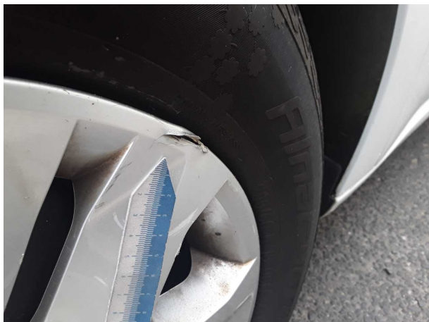
Beschädigung #1: Rad/Reifen: Radblende vorn links - gebrochen / gerissen - erneuern
