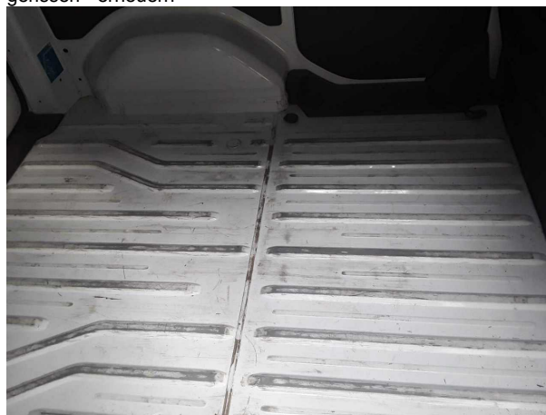
Beschädigung #2: Interieur: Laderraumboden - verkratzt / verschürft - Wertminderung
