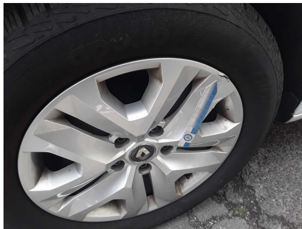
Beschädigung #1: Rad/Reifen: Radblende vorn links - gebroche... gerissen - erneuern
