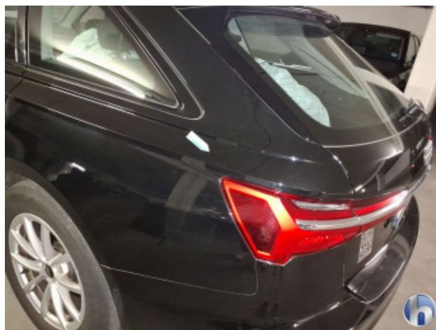
5. Seitenwand - Hinten - Links Kratzer - Lackieren
