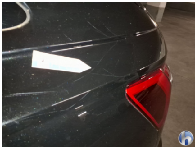
5. Seitenwand - Hinten - Links Kratzer - Lackieren
