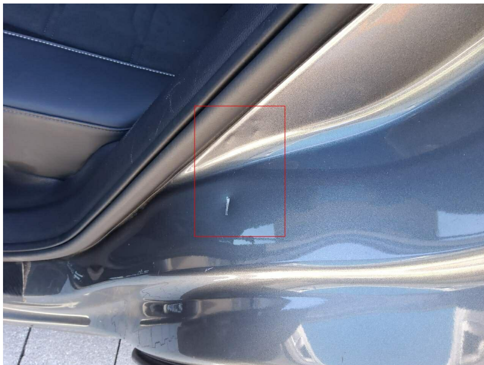
Bild 17 : Tür hinten links Einstieg, eingedellt, instandsetzen und lackieren mit Lackaufbau
