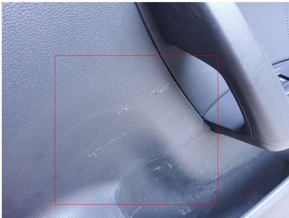
Bild 21 : Türverkleidung vorne rechts verschrammt
