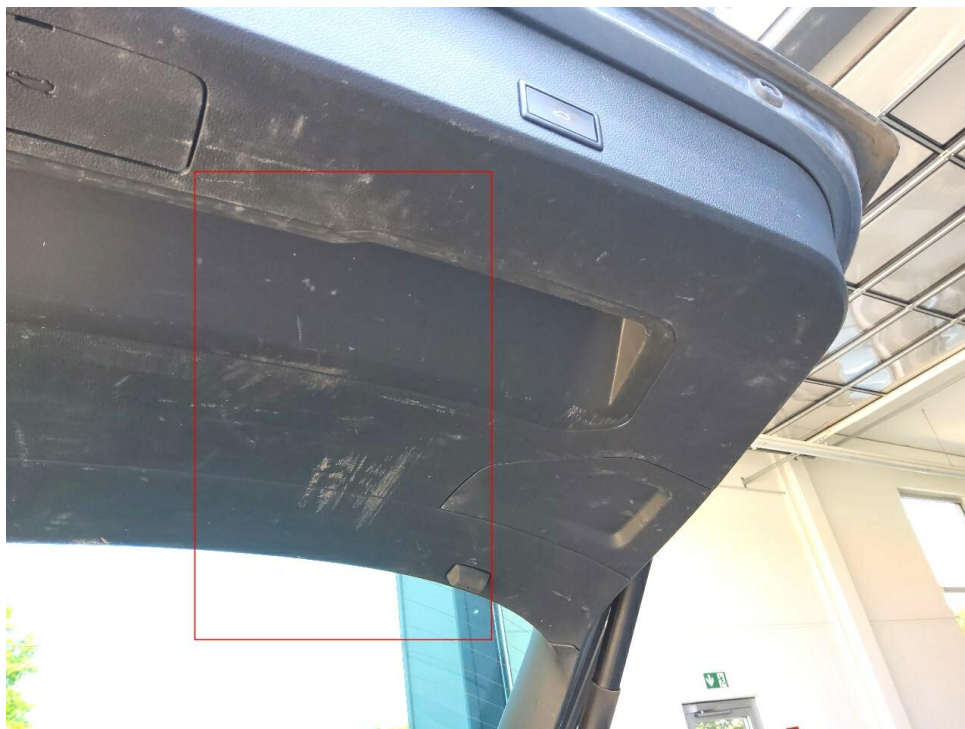
Bild 25 : Verkleidung Heckklappe innen verschrammt
