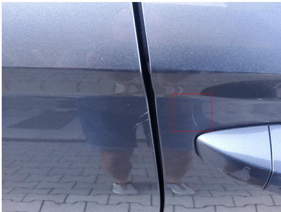
Bild 15 : Tür vorne rechts Lackierung oberhalb, zerkratzt, smart repair
