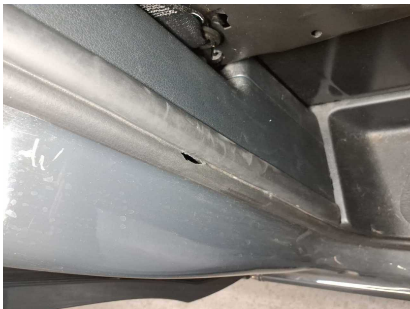
Beschädigung #1: Tür vorn rechts: Türdichtung - gebrochen / gerissen - erneuern
