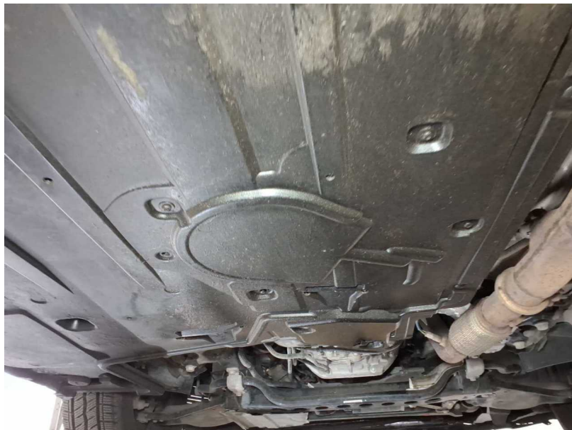
Beschädigung #10: Karosserie: Unterboden (Kraftstofftank ersetzt - lt. Werkstatt) - undicht - instandsetzen
