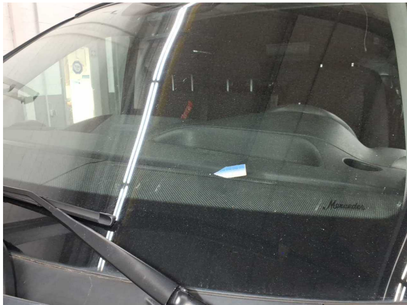
Beschädigung #11: Verglasung: Frontscheibe - beschädigt - erneuern
