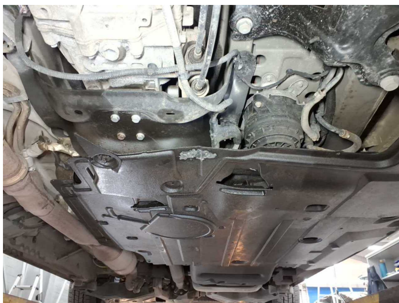
Beschädigung #10: Karosserie: Unterboden (Kraftstofftank ersetzt - lt. Werkstatt) - undicht - instandsetzen
