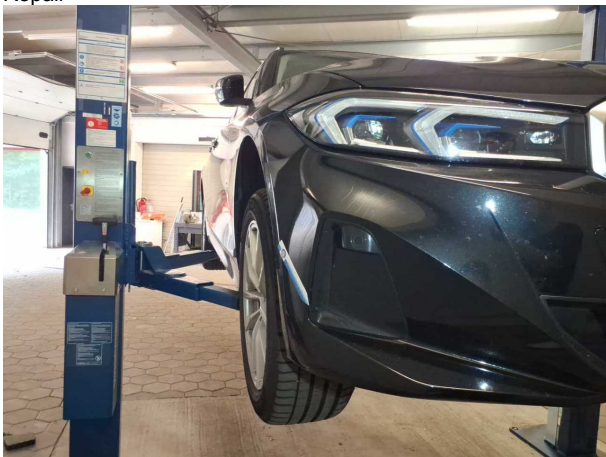
Beschädigung #2: Stossfänger vorn: Lufteinlassgitter - gebrochen / gerissen - erneuern
