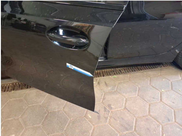
Beschädigung #1: Tür vorn links: Türkante - Kratzer - Smart Repair
