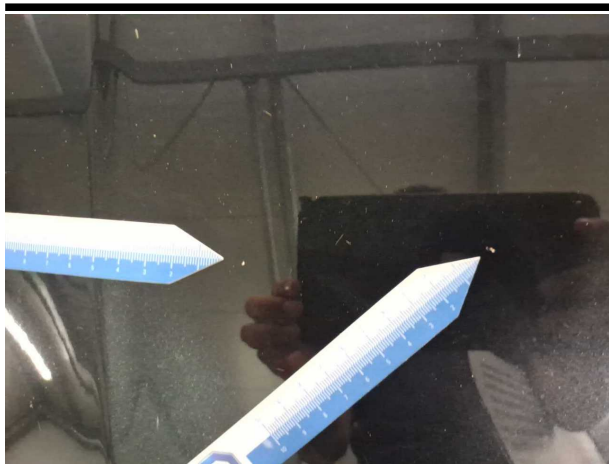
Beschädigung #3: Motorhaube: Motorhaube - Steinschlag - lackieren
