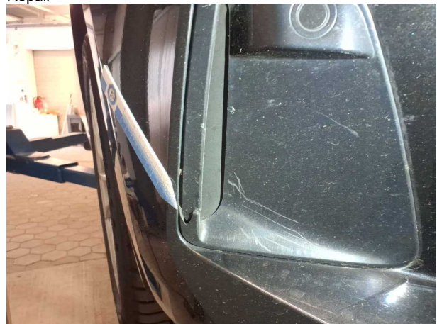
Beschädigung #2: Stossfänger vorn: Lufteinlassgitter - gebrochen / gerissen - erneuern
