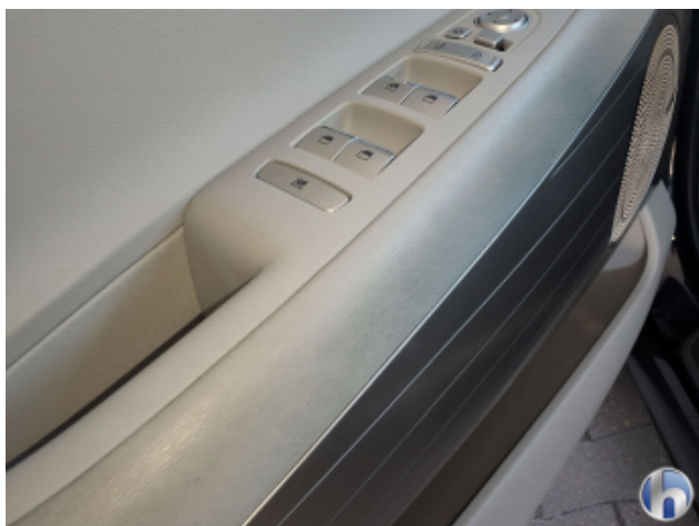
11. Verkleidung Verschmutzt - Reinigen
