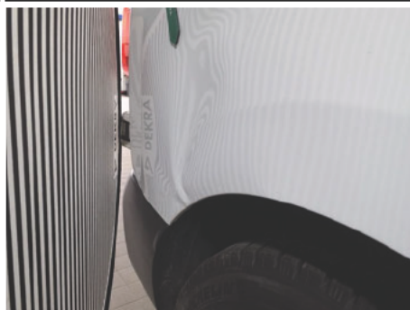
Seitenwand / Hinten Rechts / Delle
