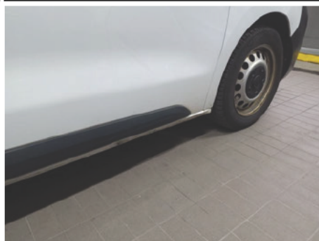
Schweller / Rechts / Delle
