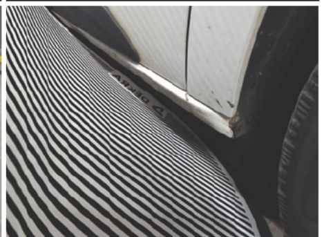
Schweller / Rechts / Delle
