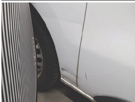
Seitenwand / Hinten Rechts / Delle
