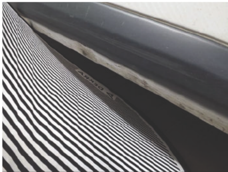
Schweller / Rechts / Delle
