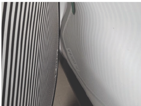
Tür / Rechts / Delle
