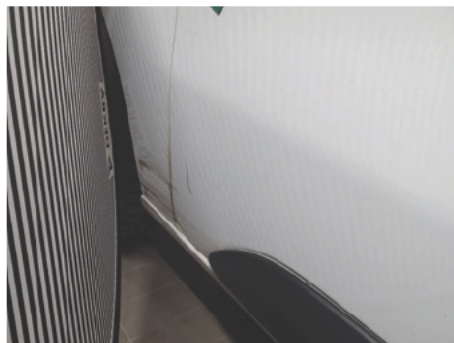
Tür / Rechts / Delle
