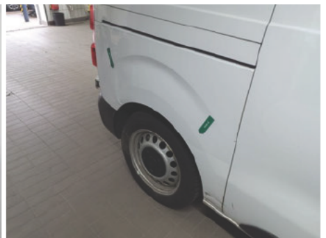
Seitenwand / Hinten Rechts / Delle
