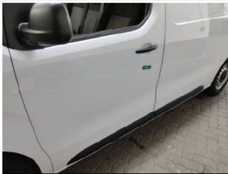
Tür / Vorne Links / Delle
