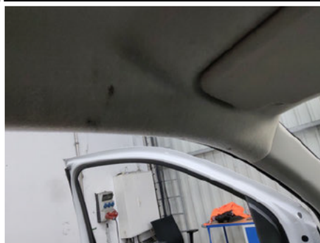
Dachhimmel / Vorne / Brandstelle
