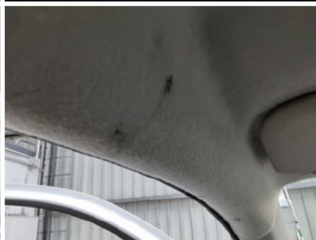
Dachhimmel / Vorne / Brandstelle
