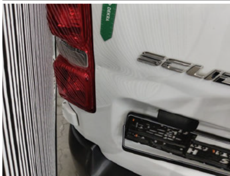
Tür / Hinten Links / Delle
