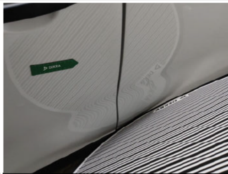
Tür / Vorne Links / Delle
